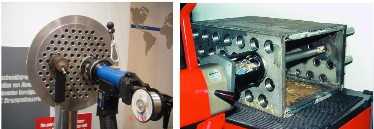
Slika 2.35 Glave za zavarivanje cijevi u cijevnu stijenu [37]
