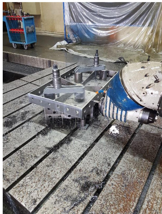
Slika 75. Istokarivanje provrta \varnothing 28H7 mm – 2. stezanje
