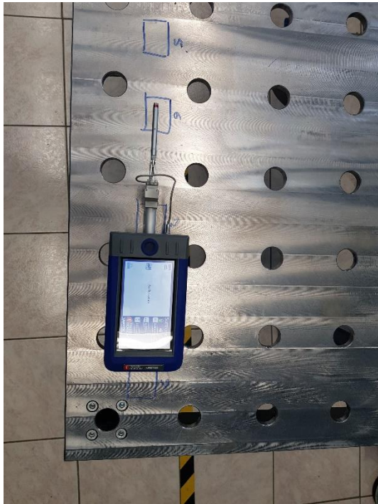
Slika 92. Mjerenje površinske hrapavosti na području 6
