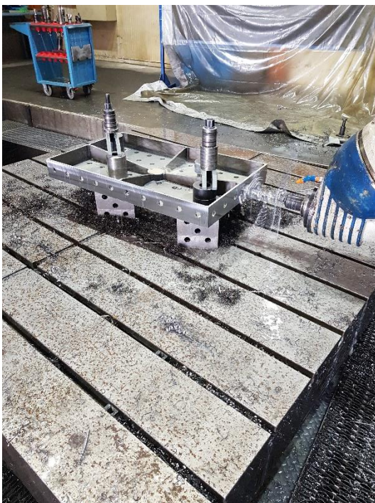
Slika 74. Bušenje provrta \varnothing 27 mm – 2. stezanje
