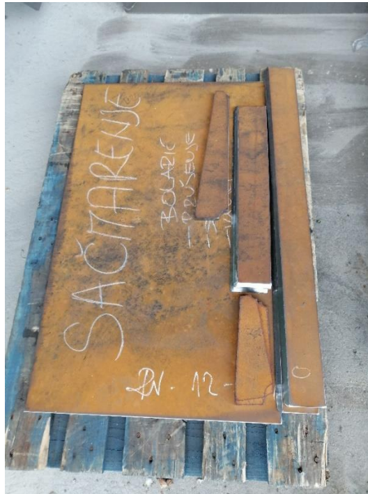
Slika 28. Izrezane pozicije steznog stola za zavarivanje
