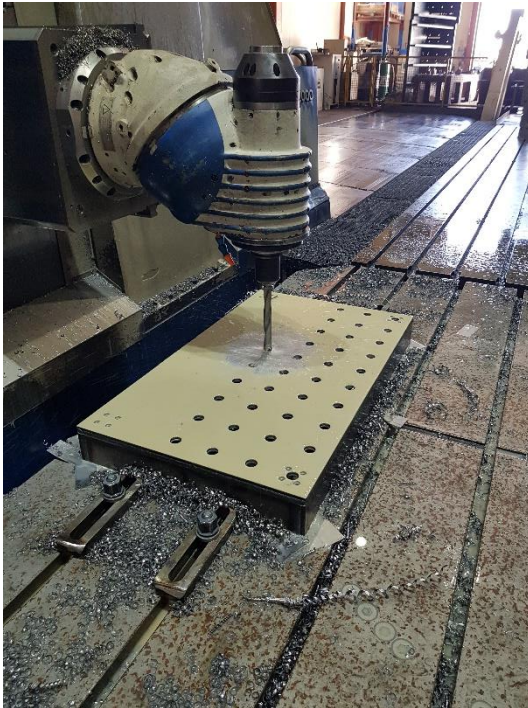
Slika 68. Bušenje provrta \varnothing 27 mm – 1. stezanje
