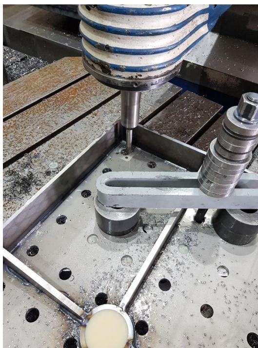
Slika 73. Glodanje džepa – 2. stezanje
