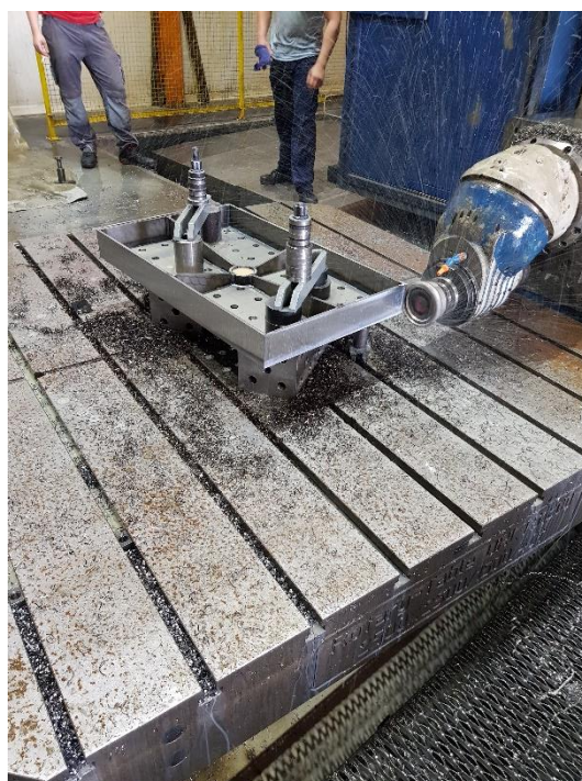
Slika 71. Čeono glodanje (grubo + završno) – 2. stezanje
