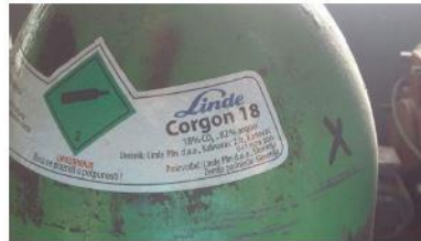
Slika 14. Primjer plinske mješavine za MAG postupak
