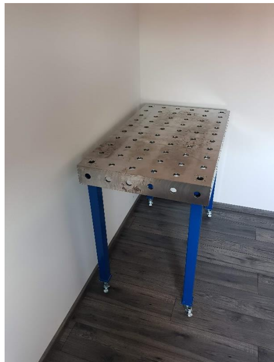
Slika 79. Završni izgled steznog stola za zavarivanje (2)
