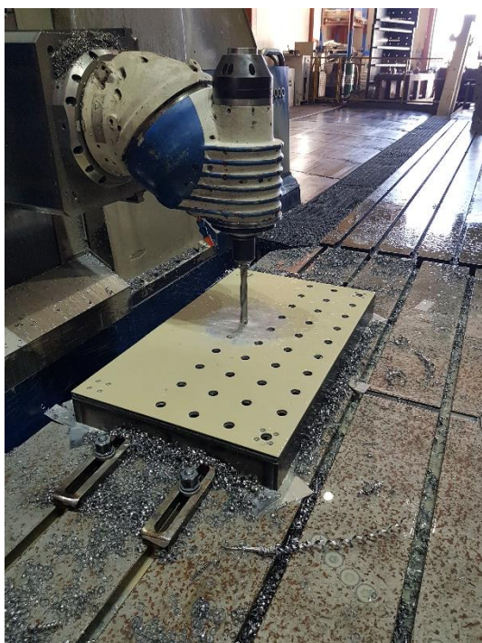
Slika 68. Bušenje provrta \text{Ø}27 mm – 1. stezanje
