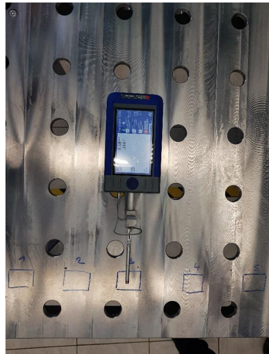
Slika 91. Mjerenje površinske hrapavosti na području 3
