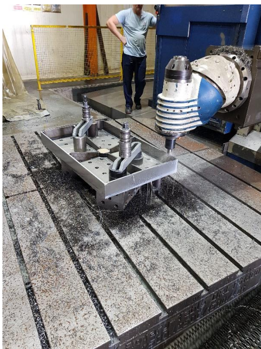
Slika 72. Čeono glodanje (grubo + završno) – 2. stezanje
