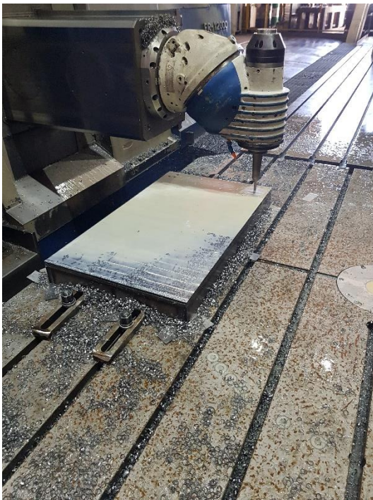
Slika 66. Bušenje upuštenja \varnothing 14 mm – 1. stezanje
