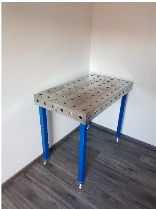
Slika 78. Završni izgled steznog stola za zavarivanje (1)
