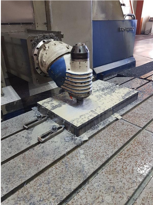
Slika 64. Čeono glodanje (grubo) – 1. stezanje
