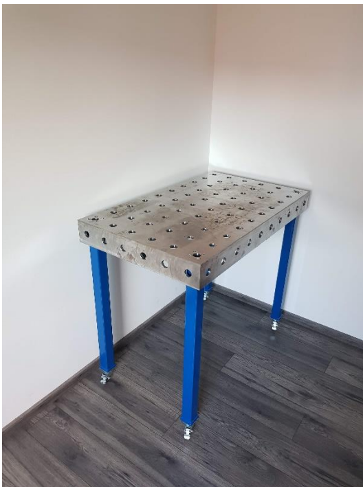
Slika 78. Završni izgled steznog stola za zavarivanje (1)
