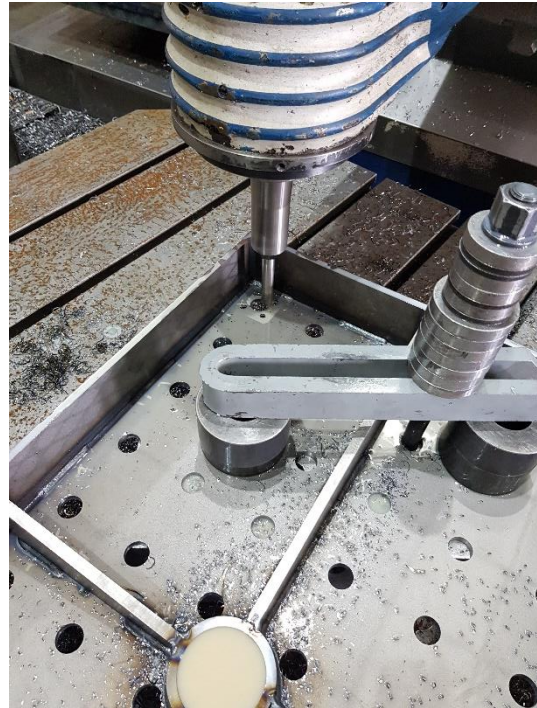
Slika 73. Glodanje džepa – 2. stezanje
