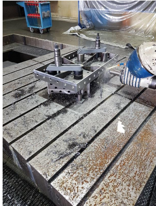
Slika 77. Glodanje bridova 2/45^\circ - 2. stezanje
