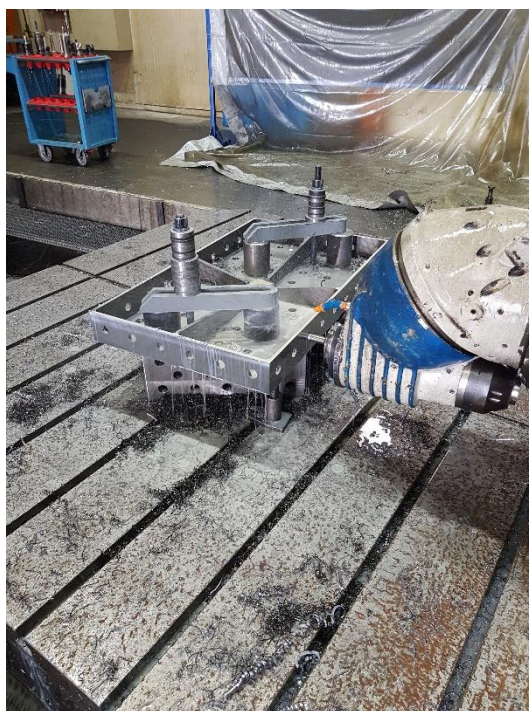
Slika 75. Istokarivanje provrta \text{Ø}28\text{H}7 mm – 2. stezanje
