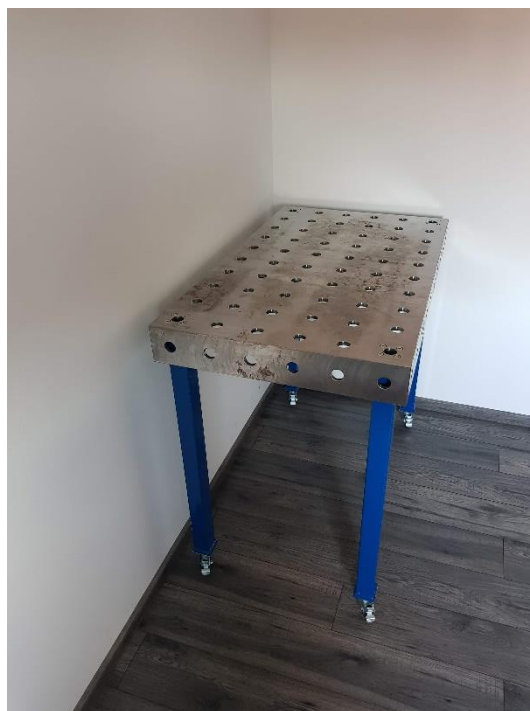
Slika 79. Završni izgled steznog stola za zavarivanje (2)
