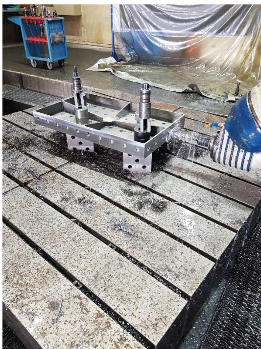
Slika 74. Bušenje provrta \text{Ø}27 mm – 2. stezanje
