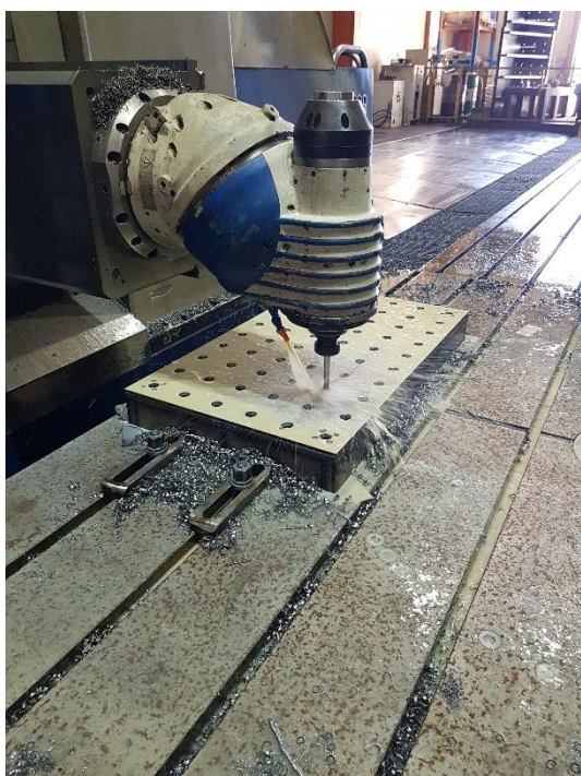
Slika 70. Glodanje bridova 0,5/45^\circ - 1. stezanje
