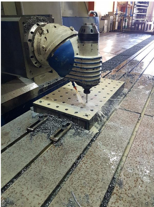
Slika 70. Glodanje bridova 0,5/45^\circ - 1. stezanje
