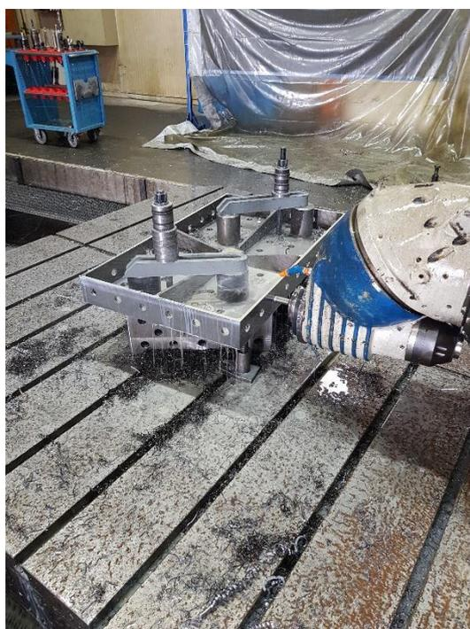
Slika 75. Istokarivanje provrta  $\text{Ø}28\text{H}7$  mm – 2. stezanje
