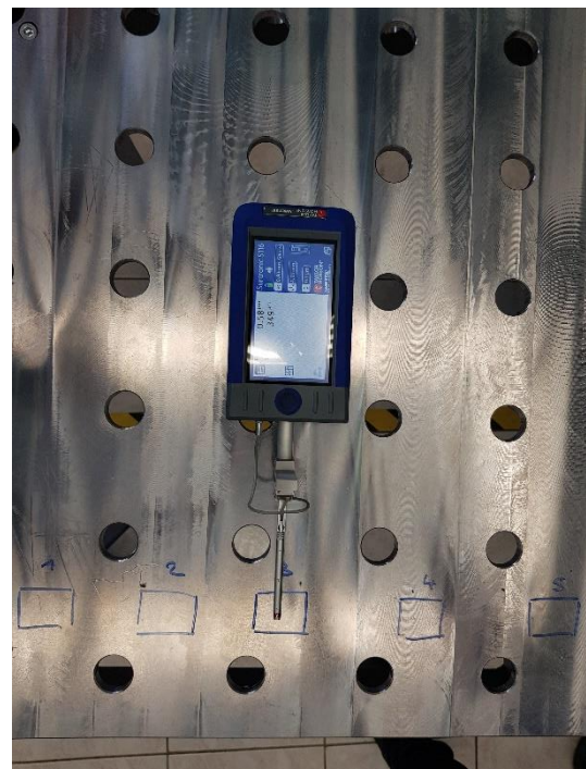
Slika 91. Mjerenje površinske hrapavosti na području 3
