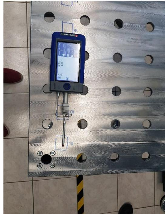
Slika 93. Mjerenje površinske hrapavosti na području 9
