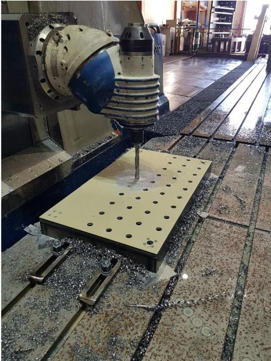
Slika 68. Bušenje provrta  $\varnothing 27$  mm – 1. stezanje
