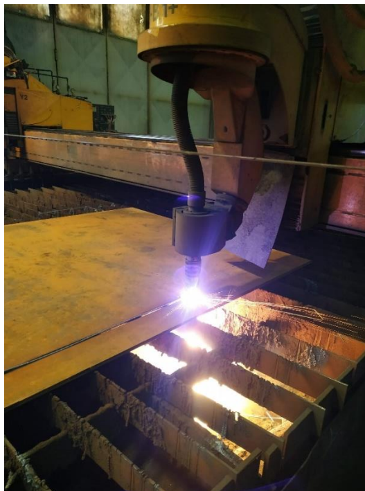
Slika 27. Rezanje plazmom pozicija steznog stola za zavarivanje
