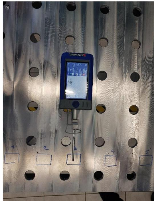
Slika 91. Mjerenje površinske hrapavosti na području 3
