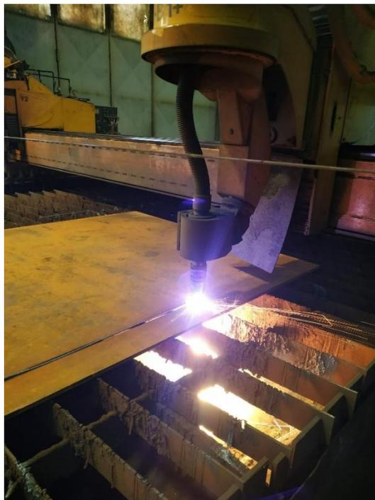
Slika 27. Rezanje plazmom pozicija steznog stola za zavarivanje
