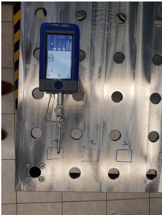
Slika 90. Mjerenje površinske hrapavosti na području 1
