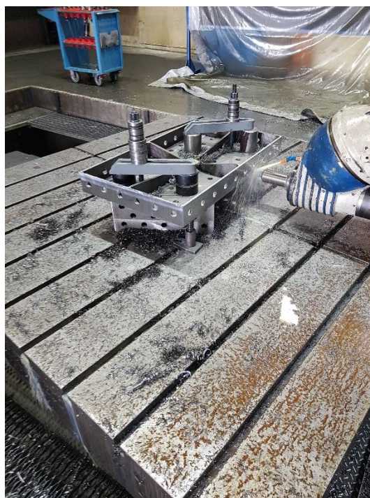
Slika 77. Glodanje bridova 2/45^\circ - 2. stezanje
