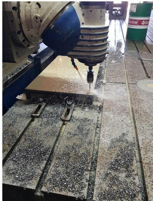
Slika 67. Bušenje provrta  $\varnothing 9$  mm – 1. stezanje
