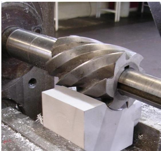
Slika 17. Protusmjerno glodanje
