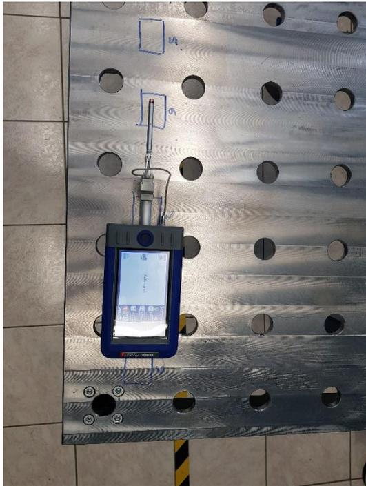
Slika 92. Mjerenje površinske hrapavosti na području 6
