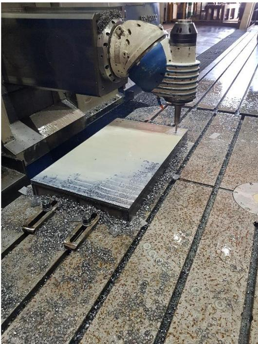
Slika 66. Bušenje upuštenja  $\varnothing 14$  mm – 1. stezanje
