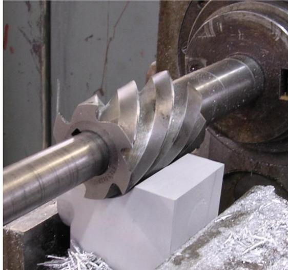
Slika 17. Istosmjerno glodanje
