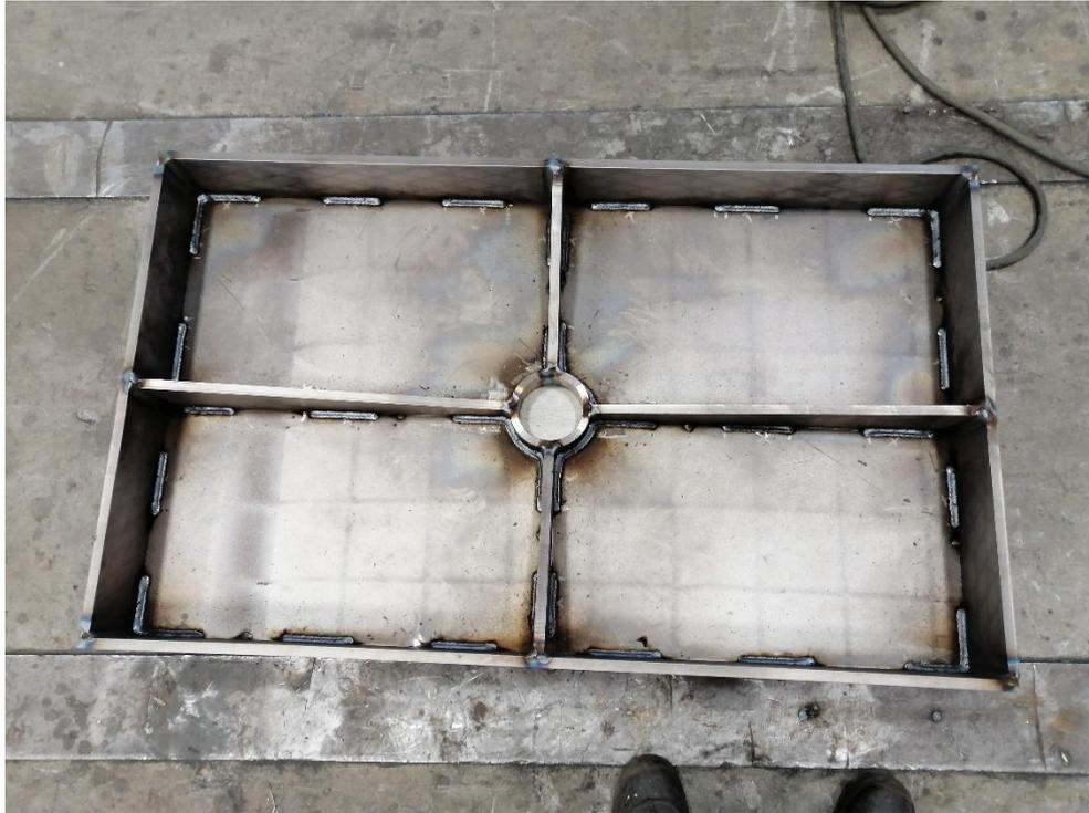
Slika 31. Izvedba kutnog zavora na steznom stolu za zavarivanje
