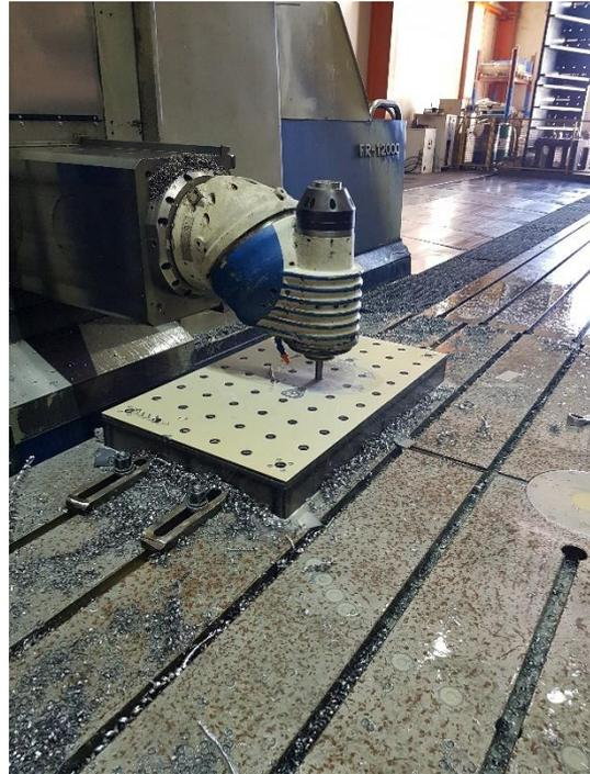
Slika 69. Istokarivanje provrta  $\varnothing 28H7$  mm – 1. stezanje
