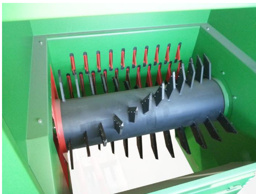
Slika 14. Noževi u stroju za otvaranje vreća [22]
