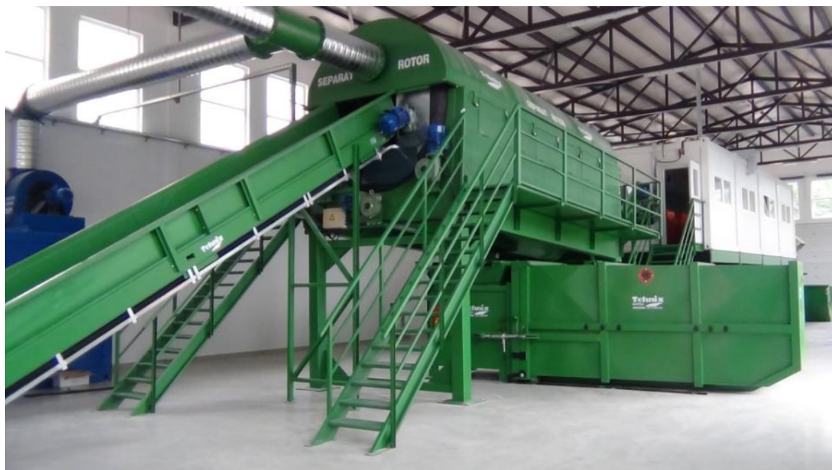
Slika 16. Separator rotor s kontejnerom ispod njega [23]
