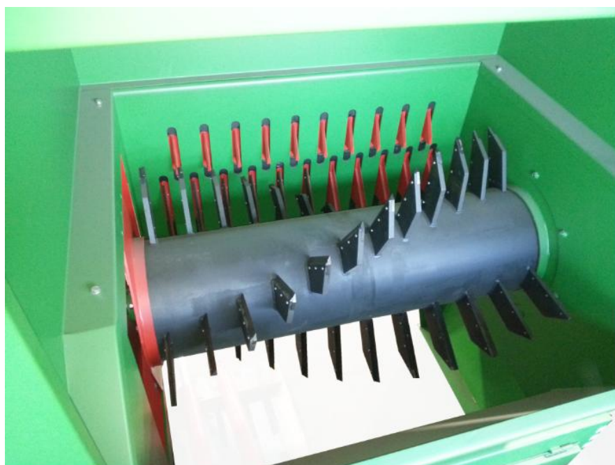
Slika 14. Noževi u stroju za otvaranje vreća [22]
