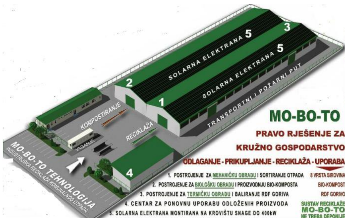
Slika 11. 3D prikaz sortirnice i kompostarne [22]
