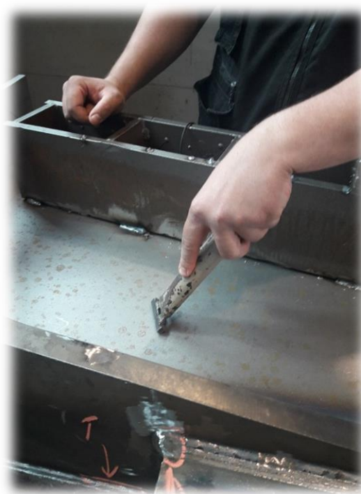
Slika 22. Čišćenje površine prije ispitivanja [4]
