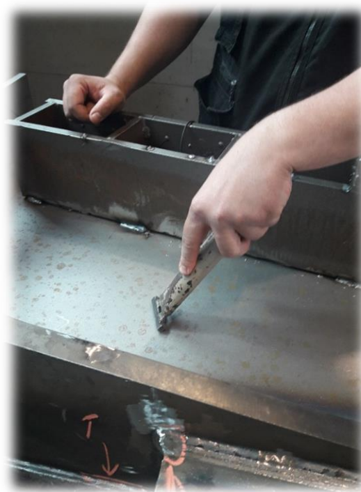
Slika 22. Čišćenje površine prije ispitivanja [4]
