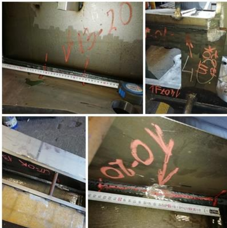
Slika 32. Oznake ispravnosti i grešaka na SPOKE-u [4]
