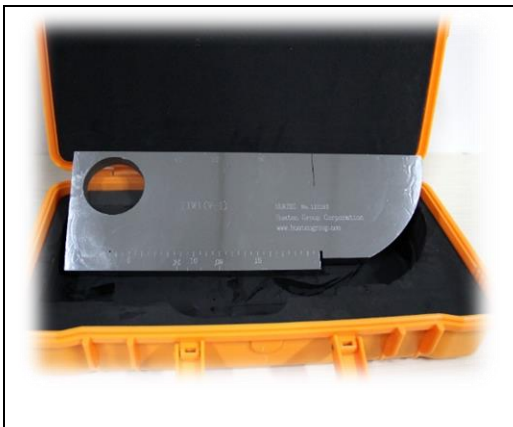
Slika 14. Kalibracijski blok K1 [4]
