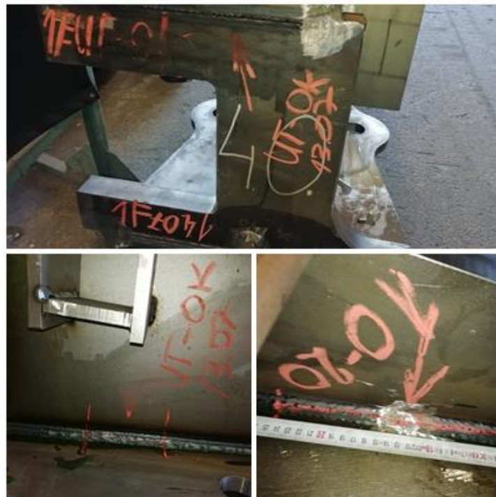
Slika 33. Oznake pogrešaka na SPOKE-u br. 2 tijekom ispitivanja
