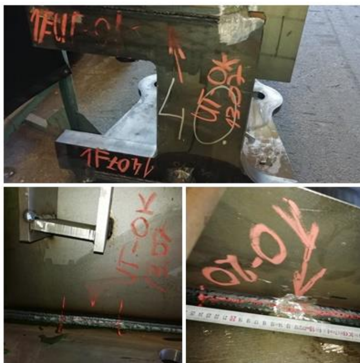
Slika 33. Oznake pogrešaka na SPOKE-u br. 2 tijekom ispitivanja
