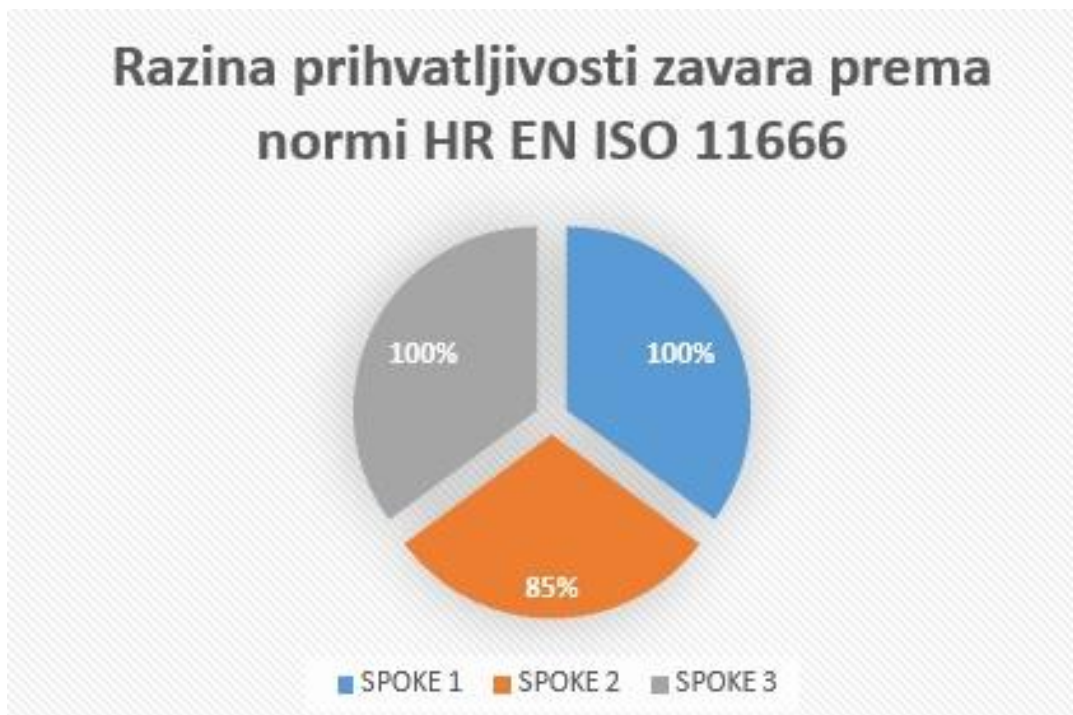
Slika 34. Dijagram Razina prihvatljivosti SPOKE-ova prema normi HR EN ISO 11666
