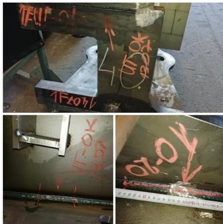
Slika 33. Oznake pogrešaka na SPOKE-u br. 2 tijekom ispitivanja
