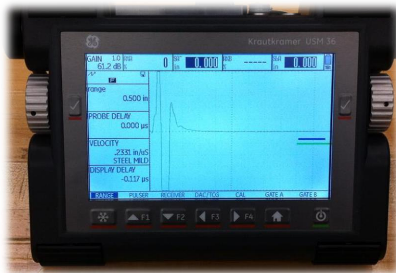
Slika 8. Ultrazvučni aparat Krautkramer USM 36 [4]
