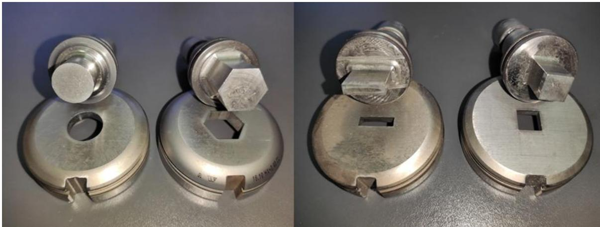
*Slika 23. Geometrije osnovnih alata [2]*
