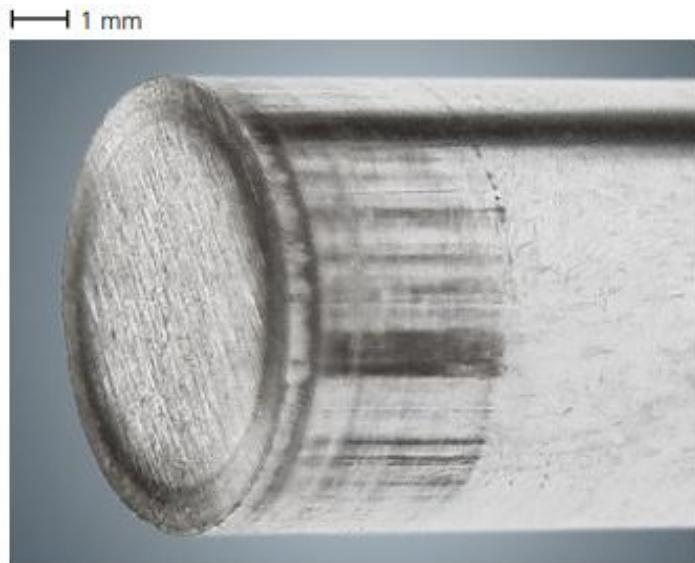
Slika 22. Istrošenost alata nakon 120 000 udaraca u nehrđajući čelik [2]
