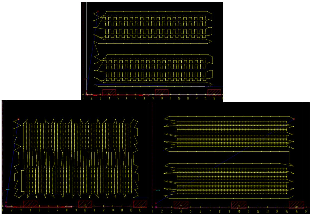
Slika 58. Perforacija probijana alatom kružne geometrije promjera 6,8 mm
