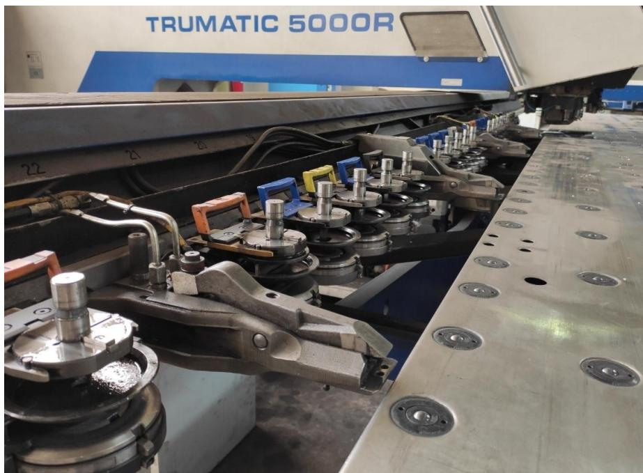
*Slika 11. Linearno spremište alata*
