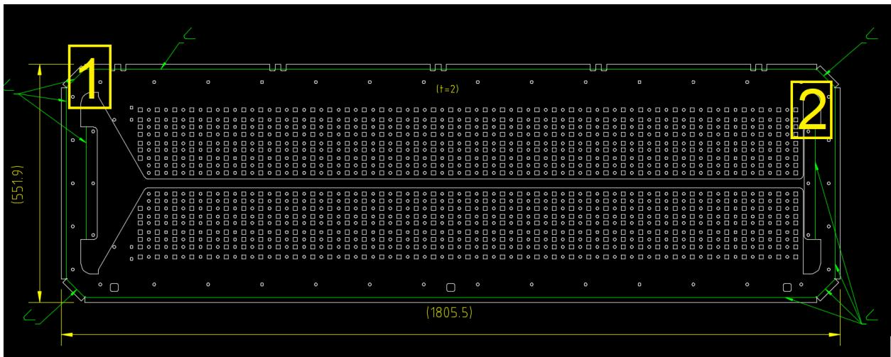
Slika 38. Razvijeni lim s prikazanim linijama savijanja (zeleno)
