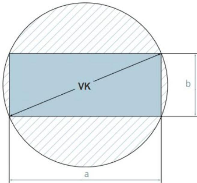
Slika 16. Vanjska kružnica alata pravokutne rezne geometrije
