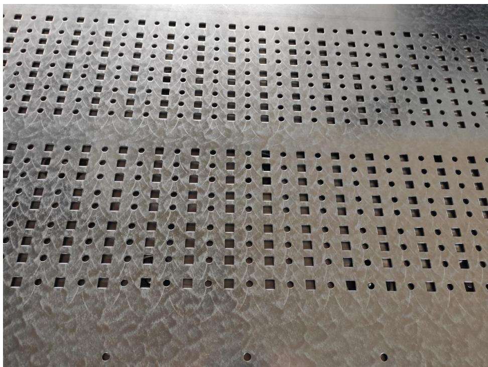
Slika 60. Probijanje perforacije s vidljivim otiscima svlakača
