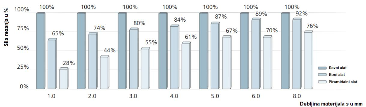
Slika 33. Potrebna sila rezanja u odnosu na debljinu materijala i obliku vrha probijača [3]
