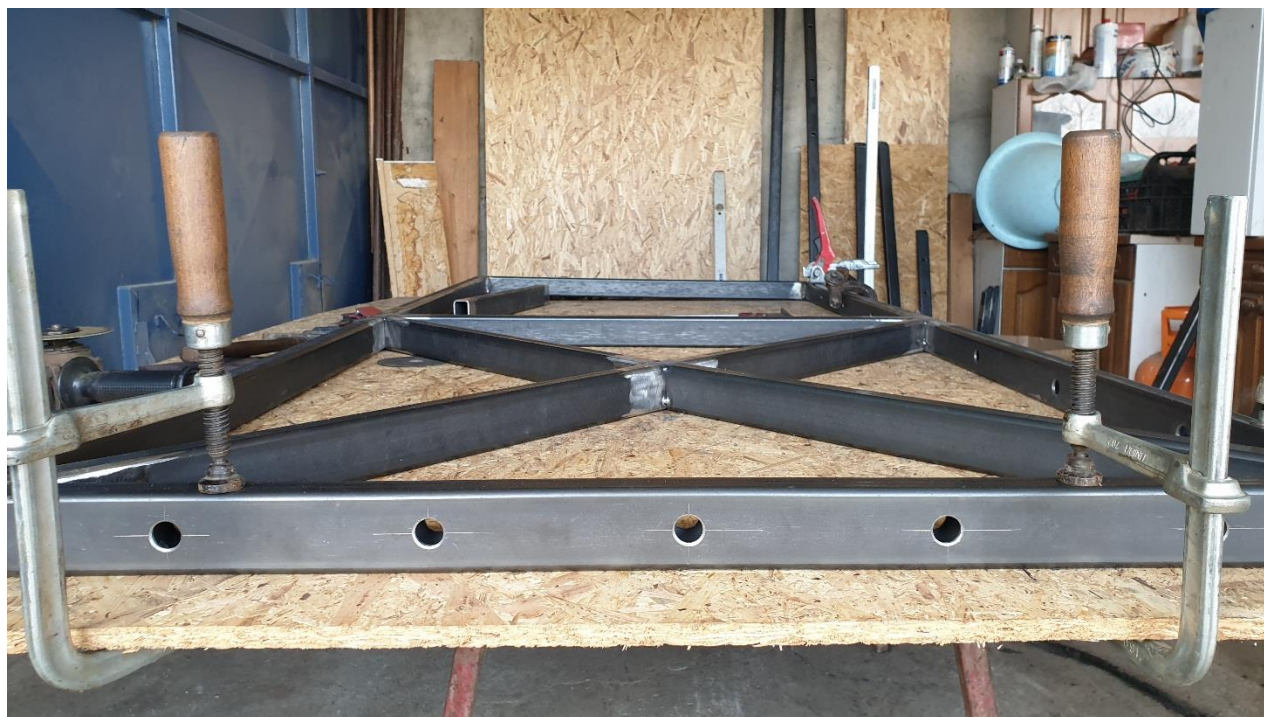
Slika 72. Zavarivanje nosive konstrukcije
