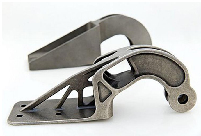
Slika 16. Primjer strukturne toploške optimizacije [7]
