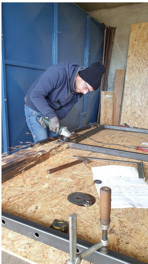
Slika 75. Brušenje i obrada zavora
