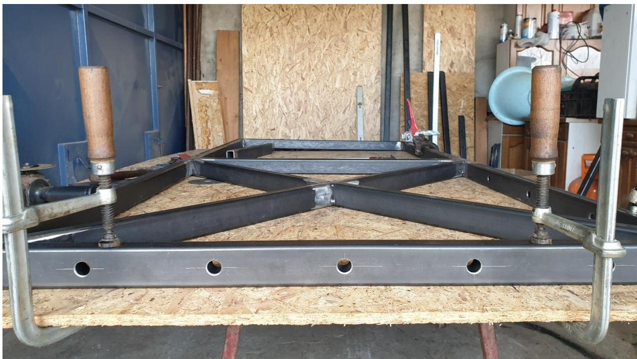
Slika 72. Zavarivanje nosive konstrukcije
