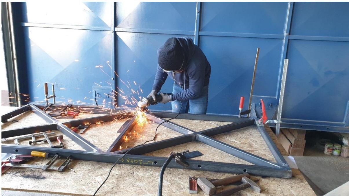
Slika 74. Brušenje zavara
