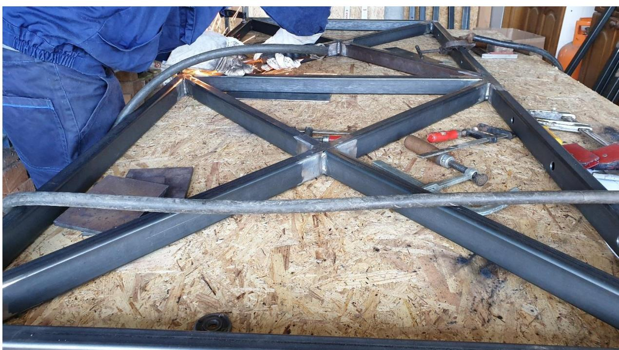
Slika 73. Zavarivanje nosive konstrukcije kreveta
