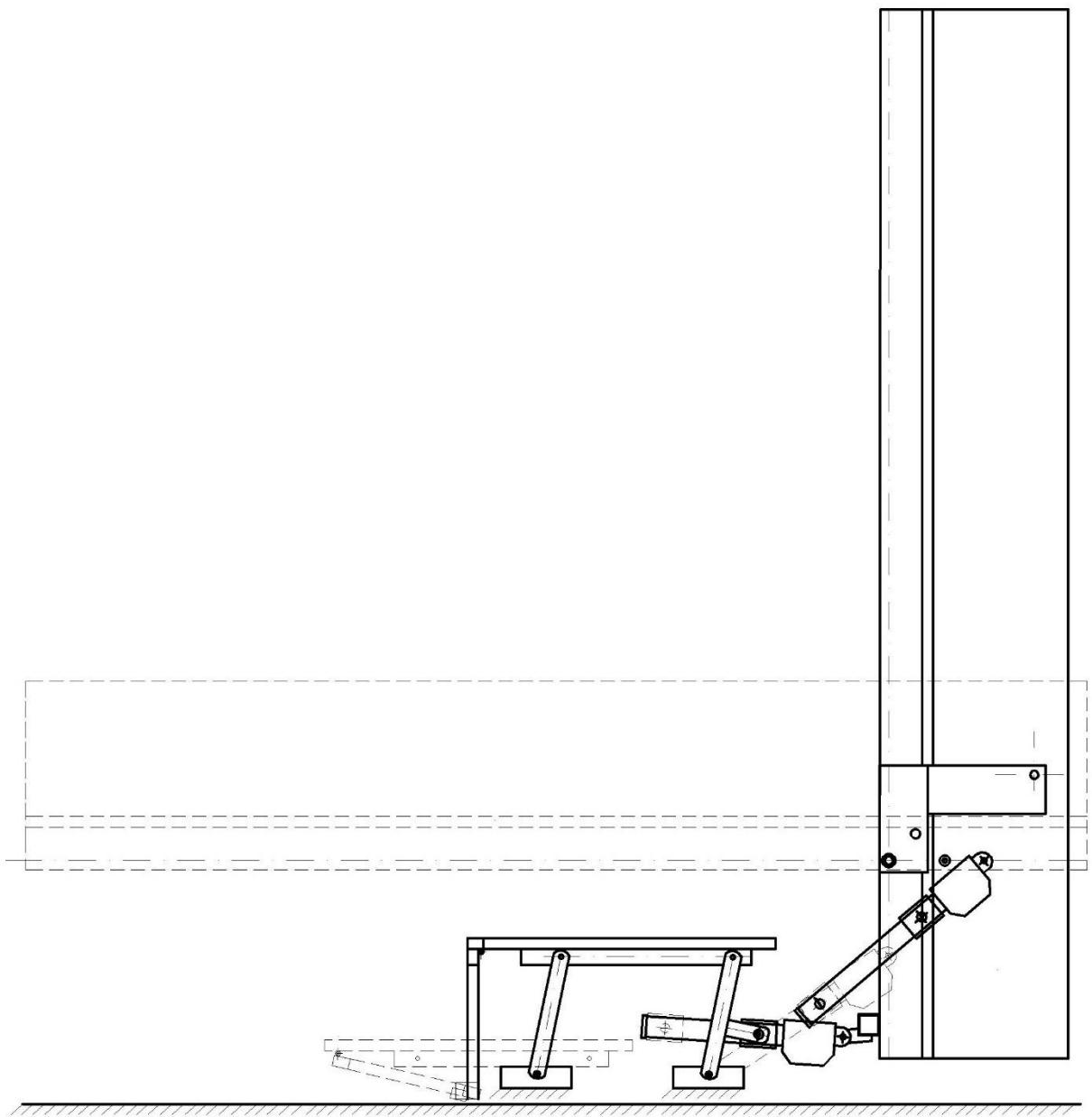
Slika 21. Shematski prikaz pokretanje i kreveta i sofe -elektromotorima
