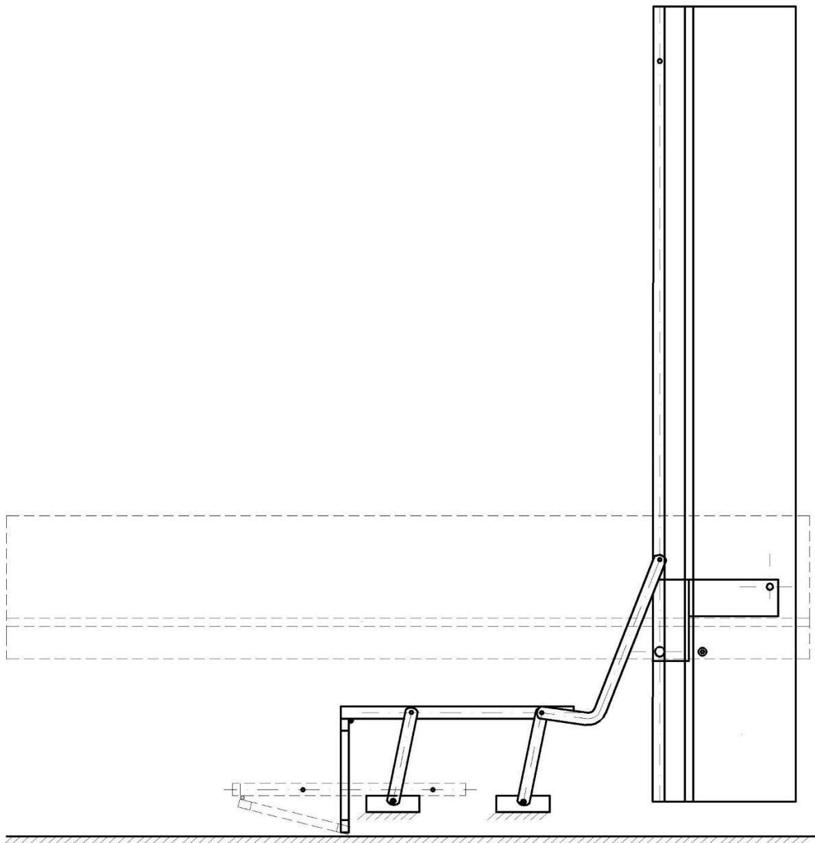
Slika 20. Shematski prikaz mehanizma za simultano pokretanje i kreveta i sofe -ručno
