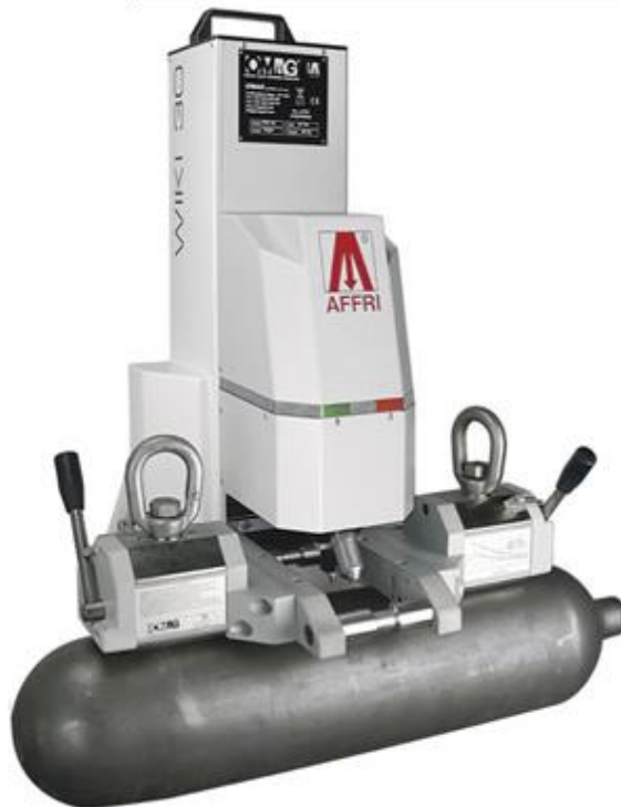
Slika 27. Specijalni uređaj za ispitivanje po Vickers-u, prijenosni ali vrlo velike mase [13]
