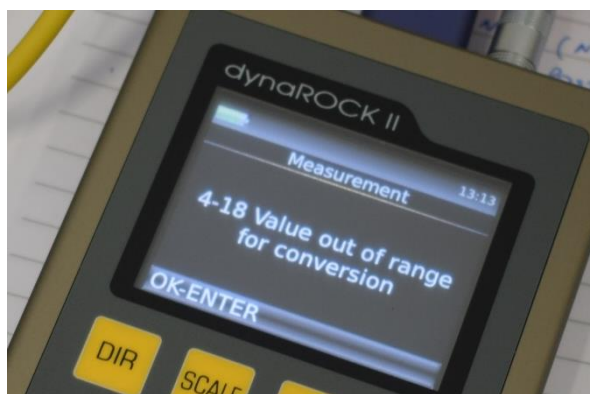
Slika 50. Prikaz greške pri odabiru skale tvrdoće
