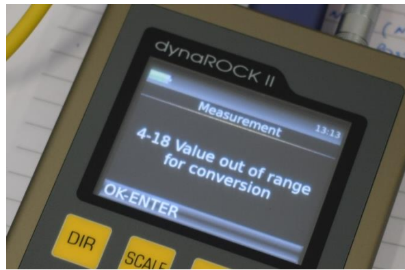
Slika 50. Prikaz greške pri odabiru skale tvrdoće
