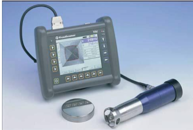
Slika 28. Uređaj za ispitivanje tvrdoće TIV metodom [2]
