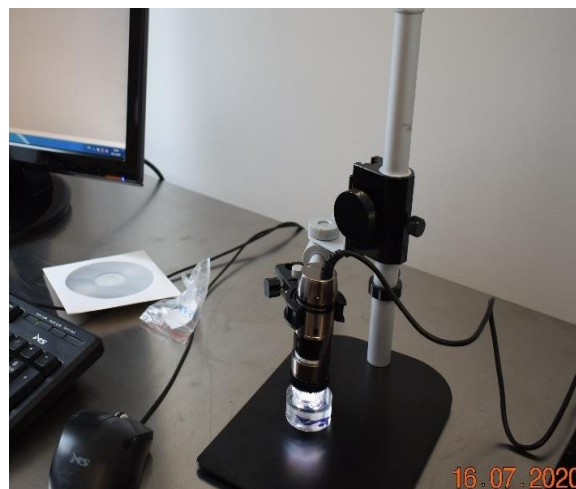
Slika 46. Pregled uzoraka stereo mikroskopom
