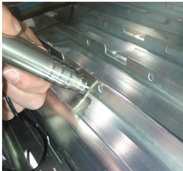
Slika 20. Ispitivanje tvrdoće tankih limova UCI metodom [11]
