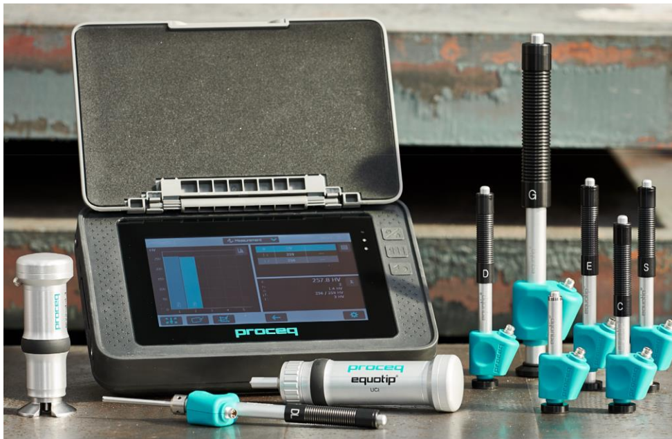
Slika 23. Kombinirani uređaj Proceq Equotip 550 sa različitim sondama [12]
