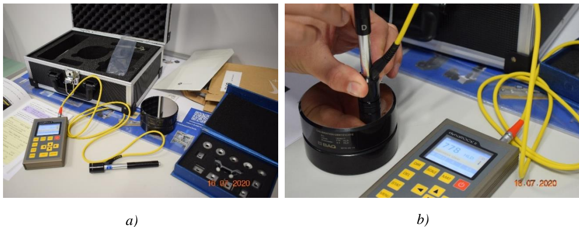
Slika 34. a) osnovna oprema uređaja BAQ dynaROCK II, b) postupak umjeravanja pomoću etalona
