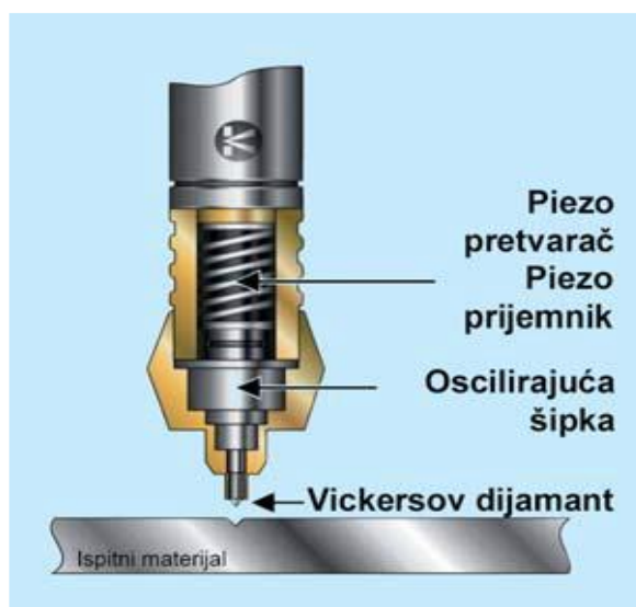
Slika 17. Shematski prikaz sonde za mjerenje UCI metodom [2]
