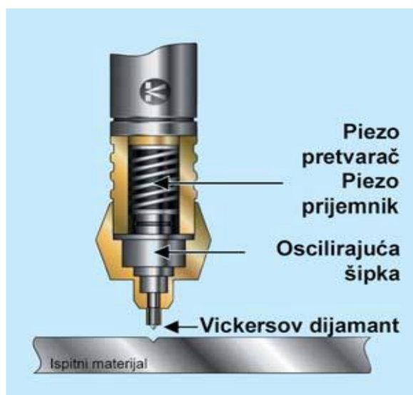
Slika 17. Shematski prikaz sonde za mjerenje UCI metodom [2]
