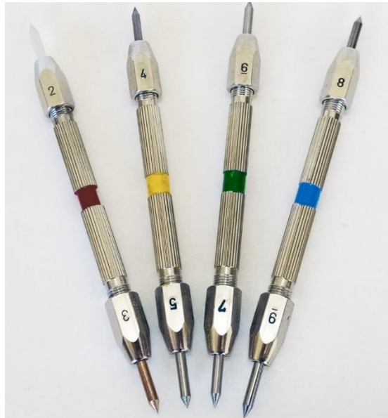
Slika 1. Ispitne igle za ispitivanje tvrdoće po Mohs-ov skali [3]
