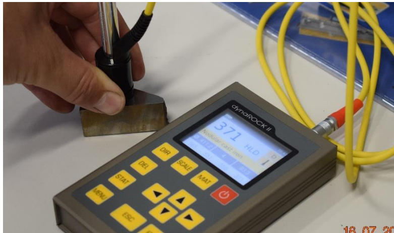
Slika 45. Veličina sonde u odnosu na uzorak
