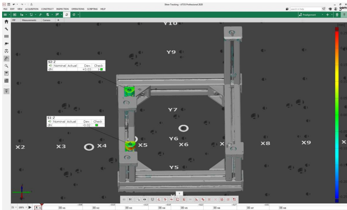
Slika 2-14 Rezultat optičkog pozicioniranja magnetnih sfera
