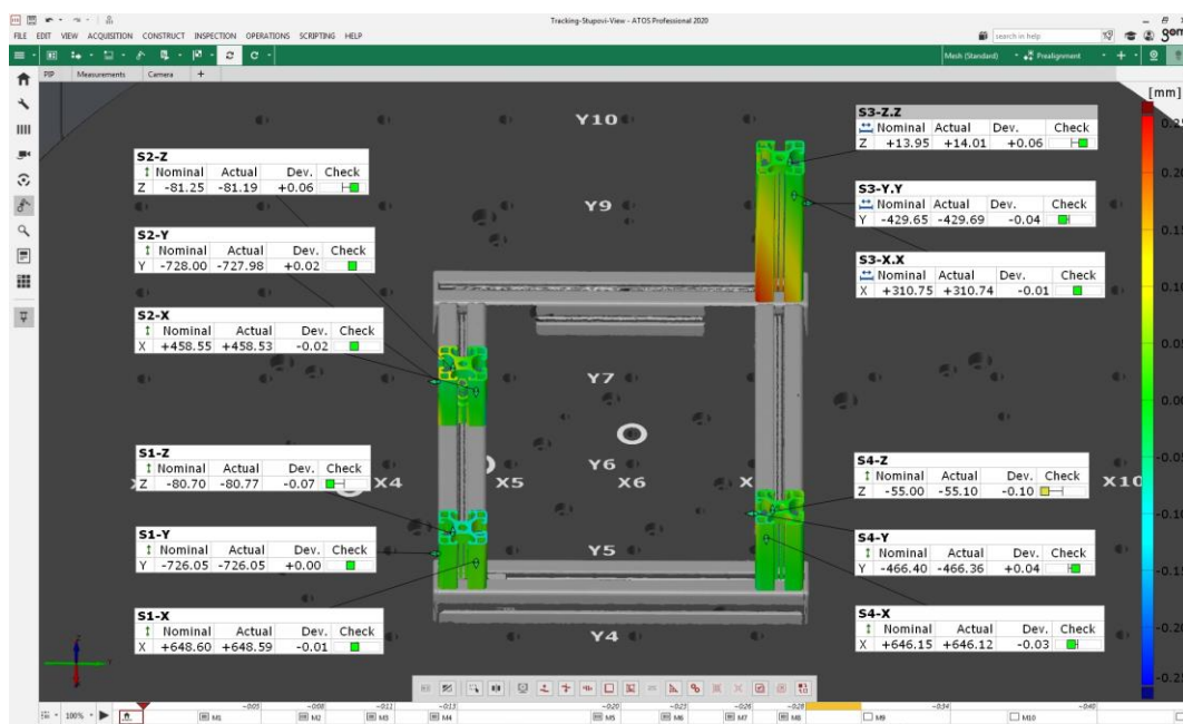
Slika 2-12 Rezultat optičkog pozicioniranja stupova
