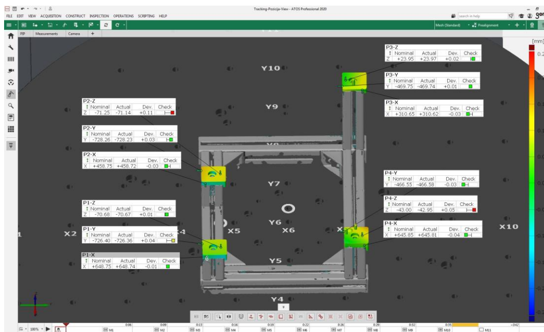
Slika 2-13 Rezultat optičkog pozicioniranja pokrova aluminijskih profila
