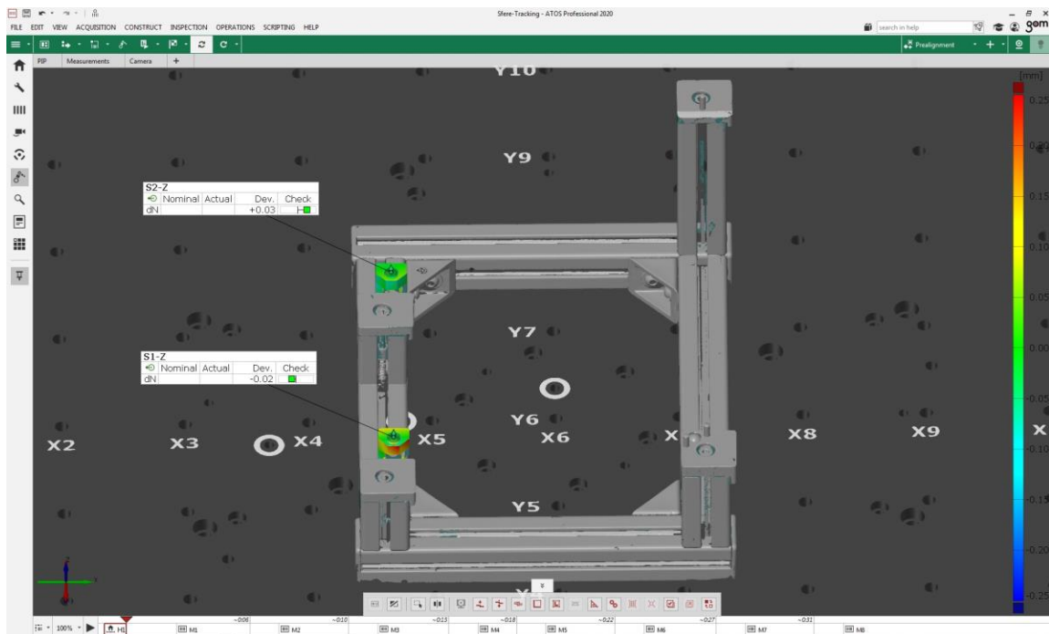
Slika 2-14 Rezultat optičkog pozicioniranja magnetnih sfera
