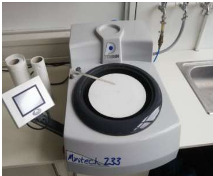
Slika 36. Priprema uzorka- brušenje
