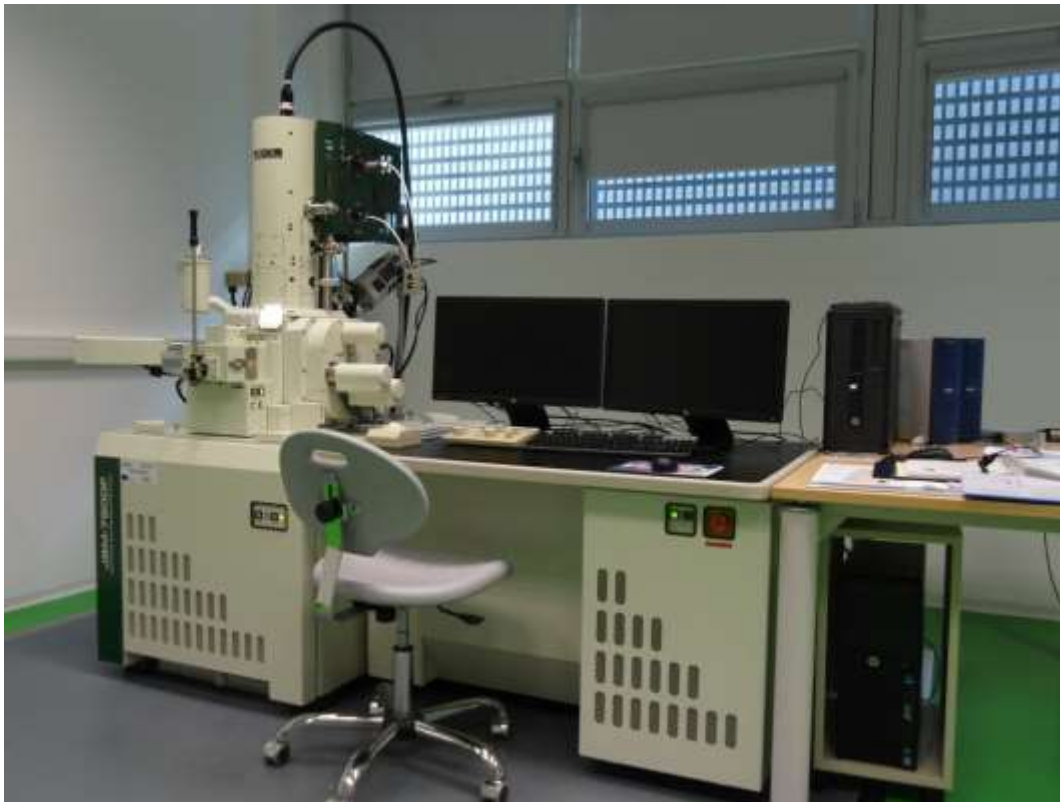
Slika 24. SEM- skenirajući elektronski mikroskop [26]
