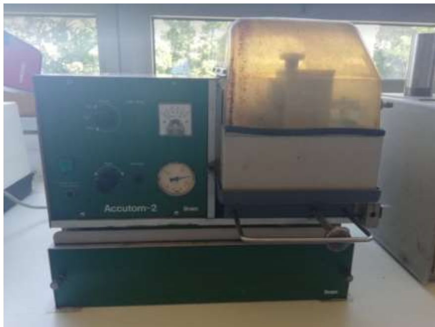
Slika 18. Uređaj za rezanje uzoraka- Accutom 2
