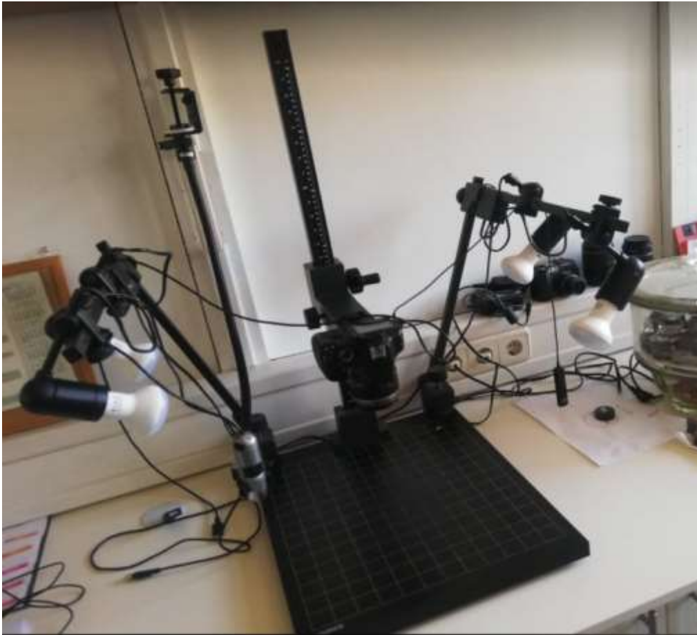
Slika 34. Uređaj za makro analizu metalografskih uzoraka
