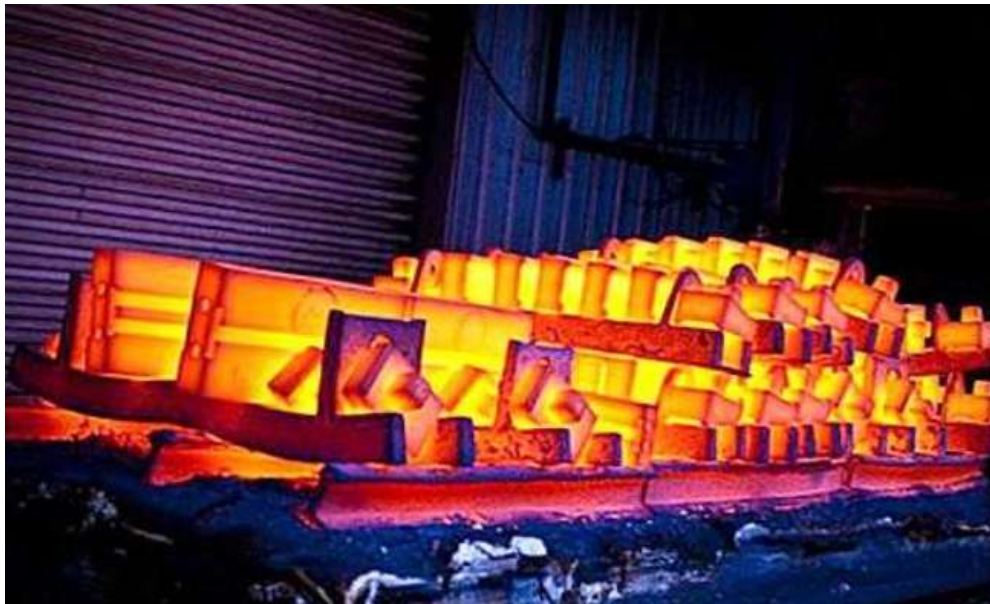
Slika 11. Postupak toplinske obrade- žarenje [15]
