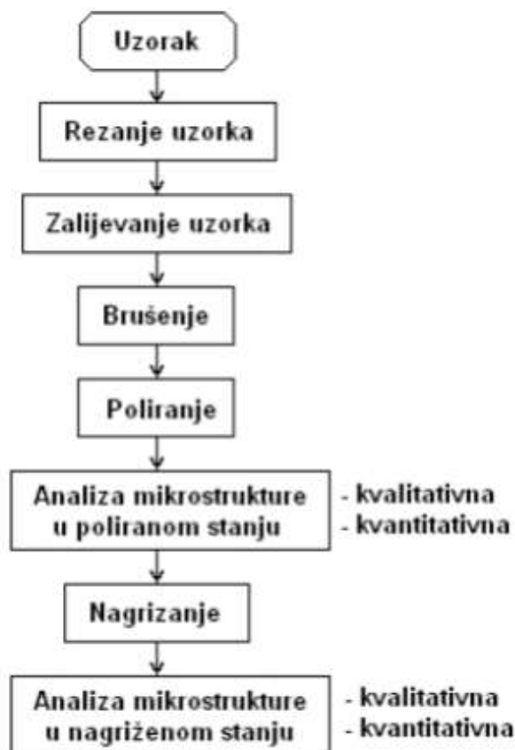
Slika 17. Shematski prikaz pripreme i metalografskog ispitivanja uzorka [22]
