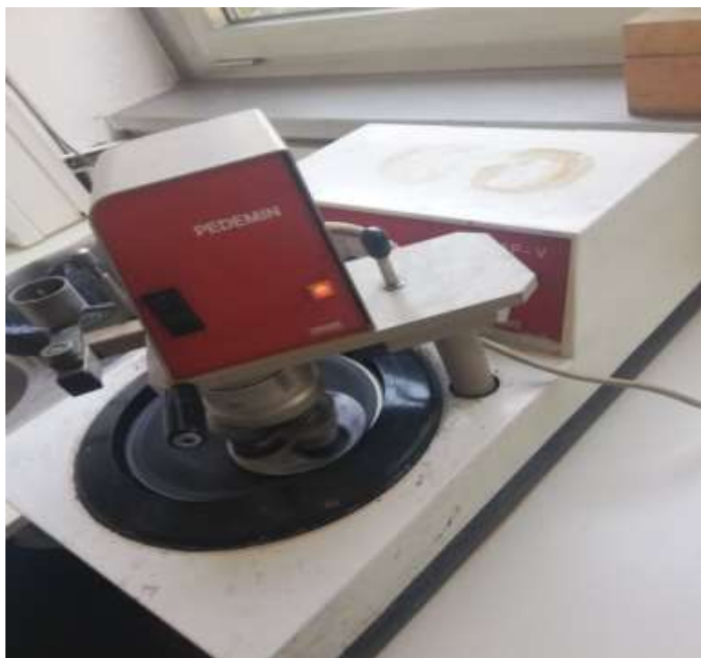
Slika 37. Uređaj za poliranje uzoraka
