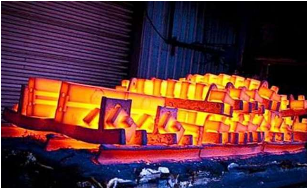
Slika 11. Postupak toplinske obrade- žarenje [15]
