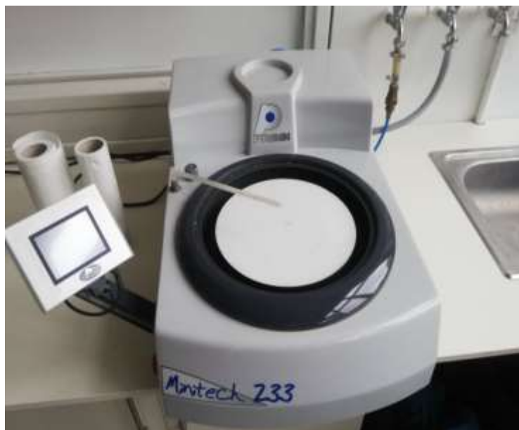
Slika 36. Priprema uzorka- brušenje
