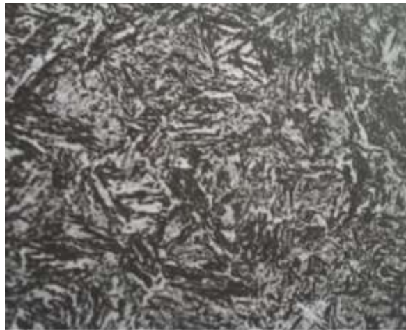
Slika 6. Mikrostruktura poboljšanog čelika- visokopušteni martenzit [11]
