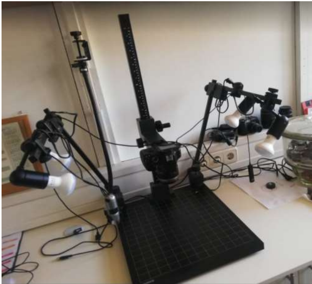
Slika 34. Uređaj za makro analizu metalografskih uzoraka
