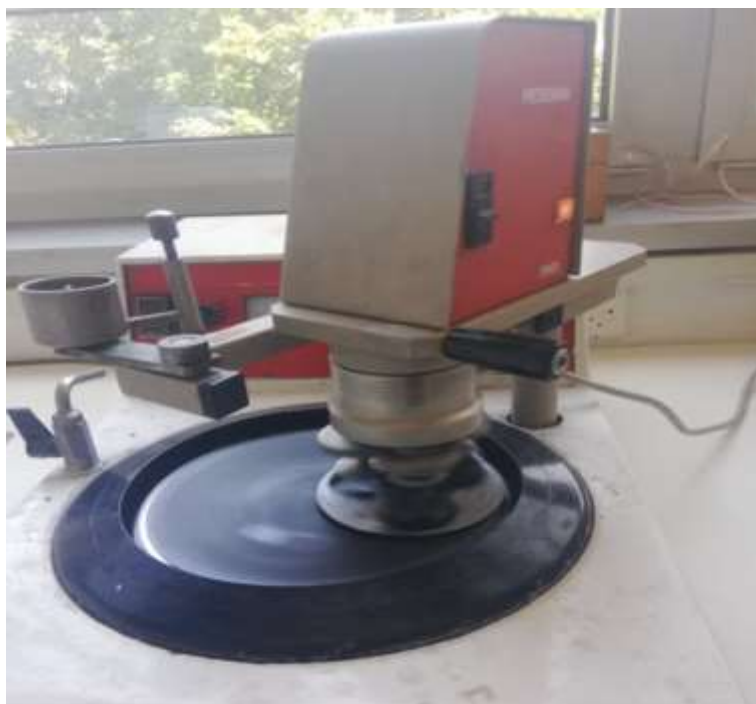
Slika 38. Priprema uzorka- poliranje
