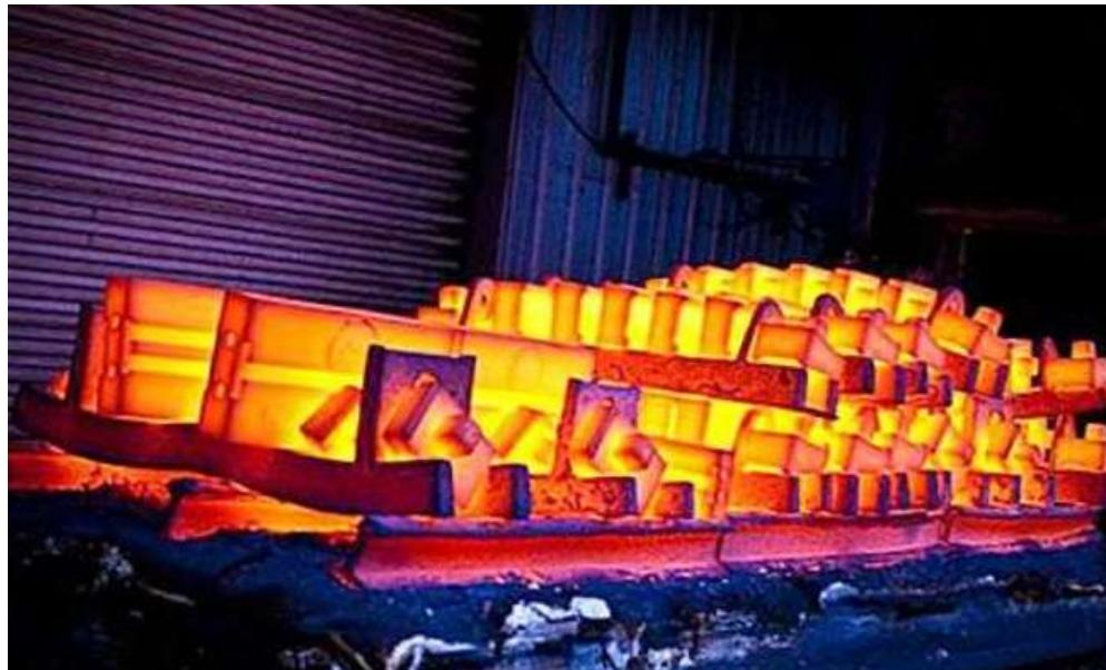
Slika 11. Postupak toplinske obrade- žarenje [15]
