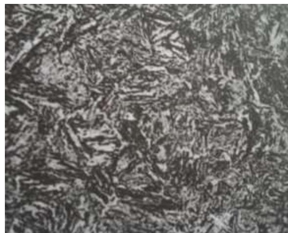
Slika 6. Mikrostruktura poboljšanog čelika- visokopopušteni martenzit [11]
