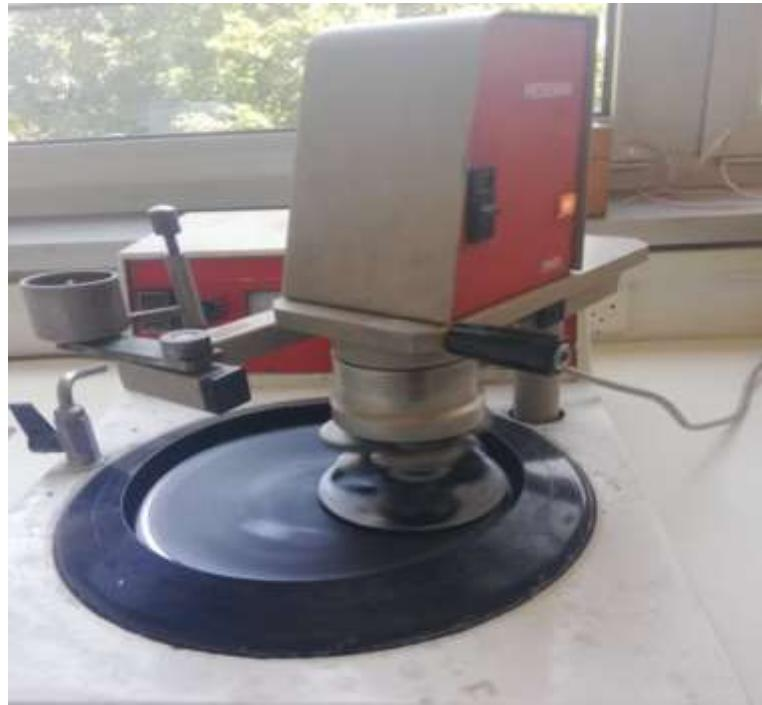
*Slika 38. Priprema uzorka- poliranje*
