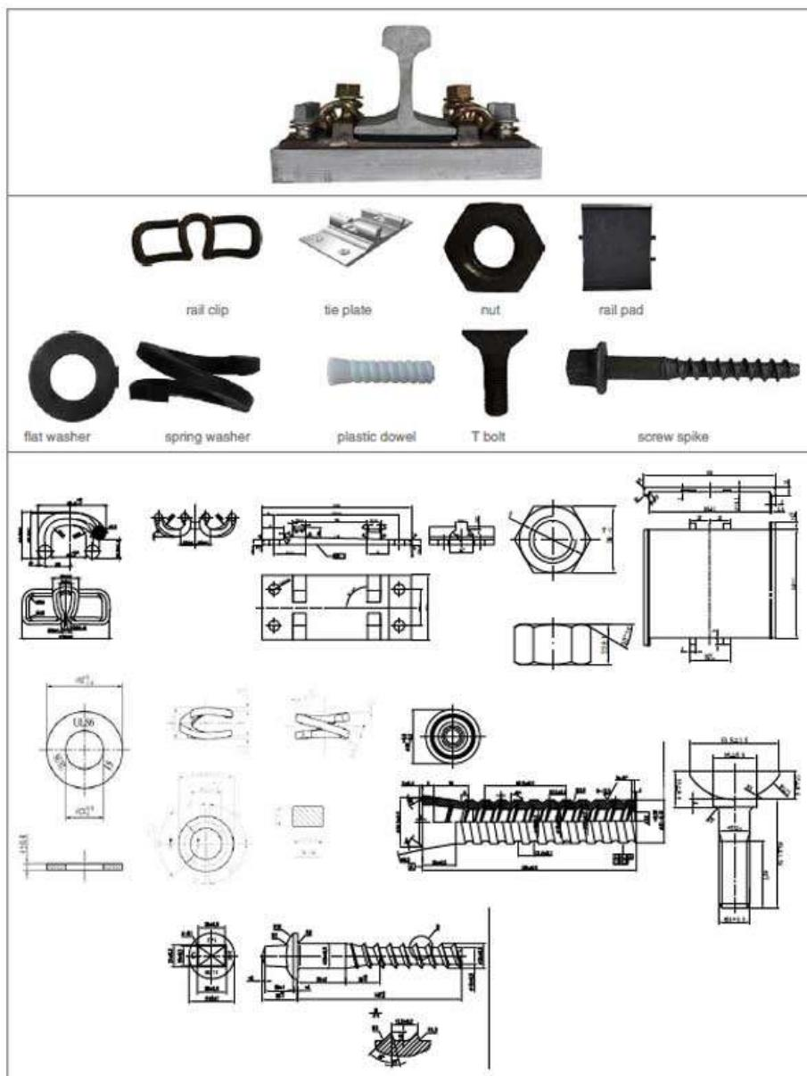
Slika 30. Komponente SKL 14 sustava za pričvršćivanje tračnica [28]
