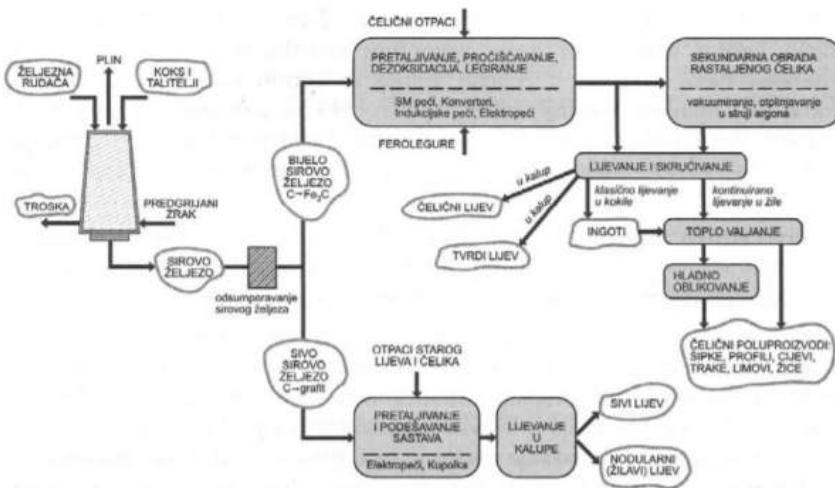
Slika 3. Shematski prikaz dobivanja čelika i željeznih lijevova [1]
