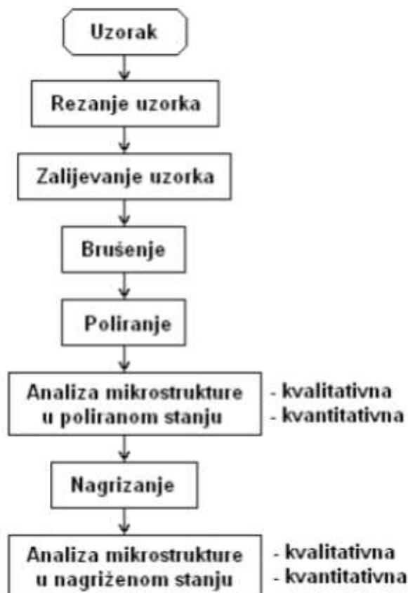
Slika 17. Shematski prikaz pripreme i metalografskog ispitivanja uzorka [22]
