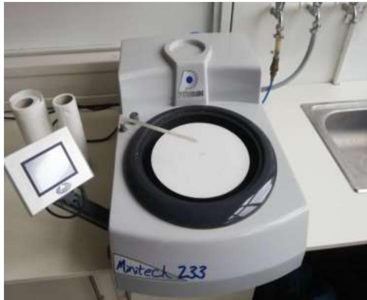
Slika 36. Priprema uzorka- brušenje
