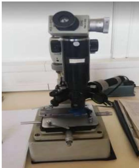
*Slika 61. Uređaj za mjerjenje mikrotvrdoće uzorka*
