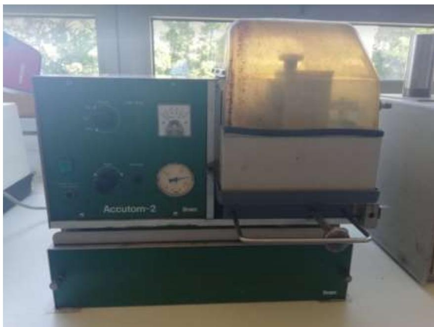
*Slika 18. Uređaj za rezanje uzorka- Accutom 2*
