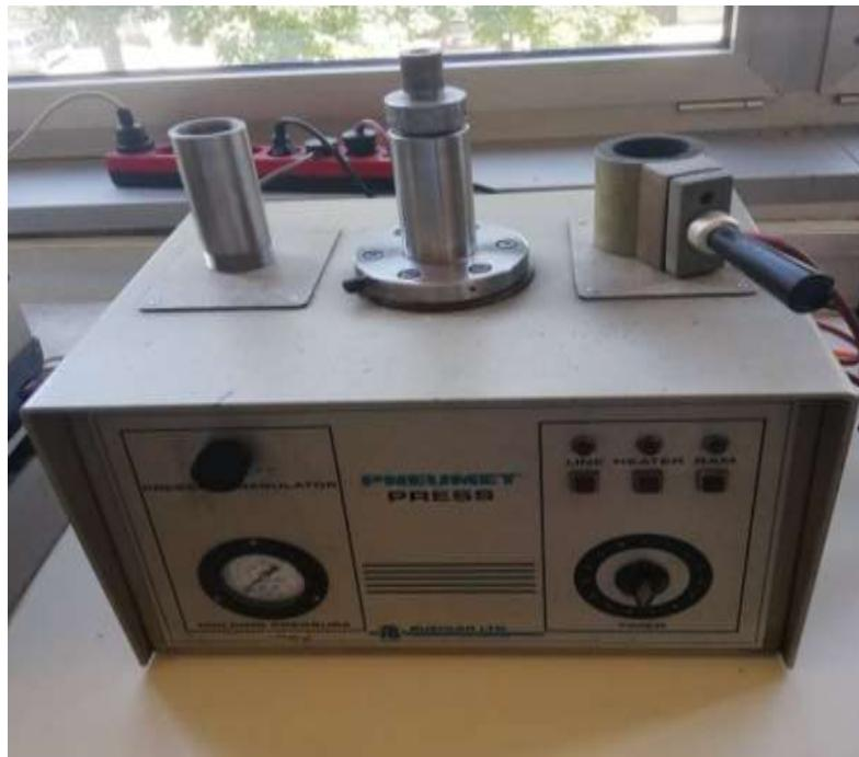
Slika 19. Uređaj za zalijevanje uzorka u polimernu masu- Pneumet Press
