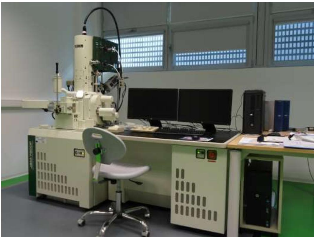
*Slika 24. SEM- skenirajući elektronski mikroskop [26]*
