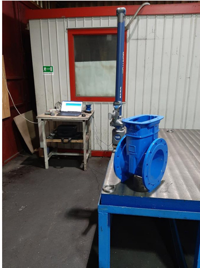
Slika 6.5. Mjerna ruka spremna za korištenje
