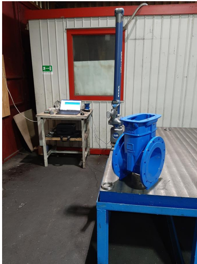
Slika 6.5. Mjerna ruka spremna za korištenje
