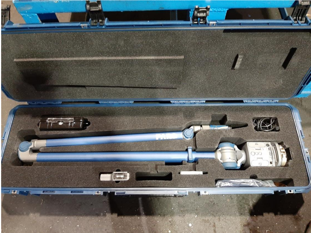
Slika 5.4. Mjerna ruka u kovčegu sa spužvastom zaštitom
