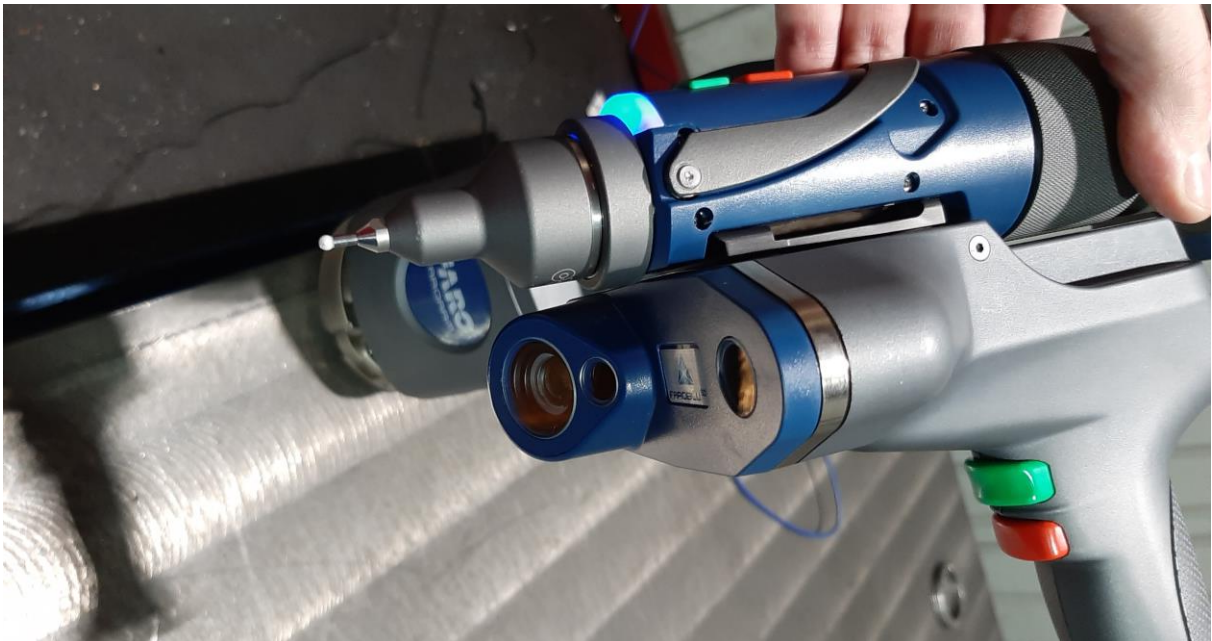
Slika 5.2. Ticalo s keramičkom kuglicom 3mm i laserski 3D skener
