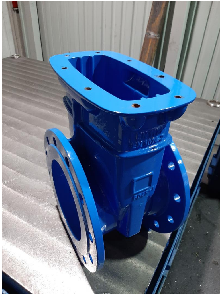
Slika 6.2. Kućište eliptičnog zasuna DN200
