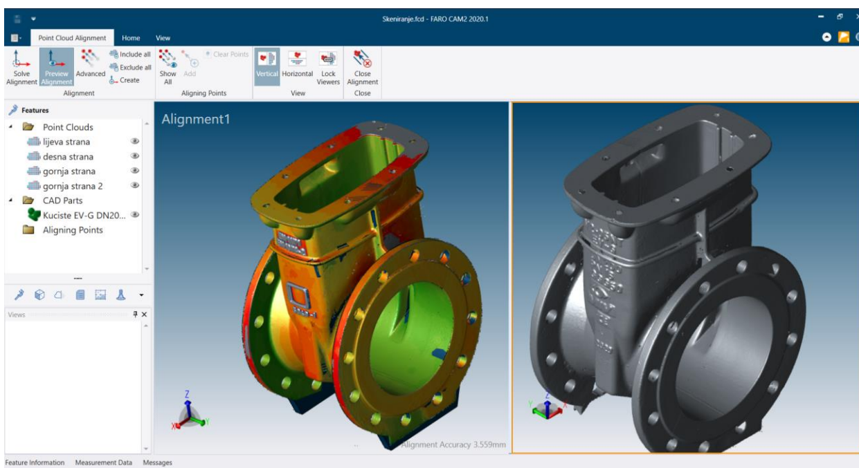
Slika 5.6. Rezultat mjerenja dobiven pomoću 3D laserskog skenera
