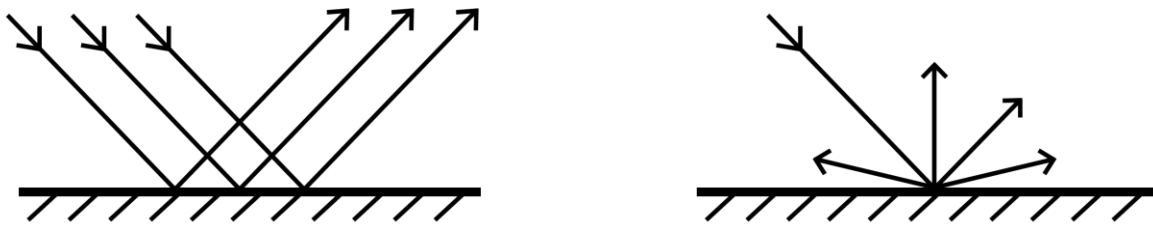
Slika 2.3 Prikaz zrcalne (lijevo) i difuzne refleksije (desno)
