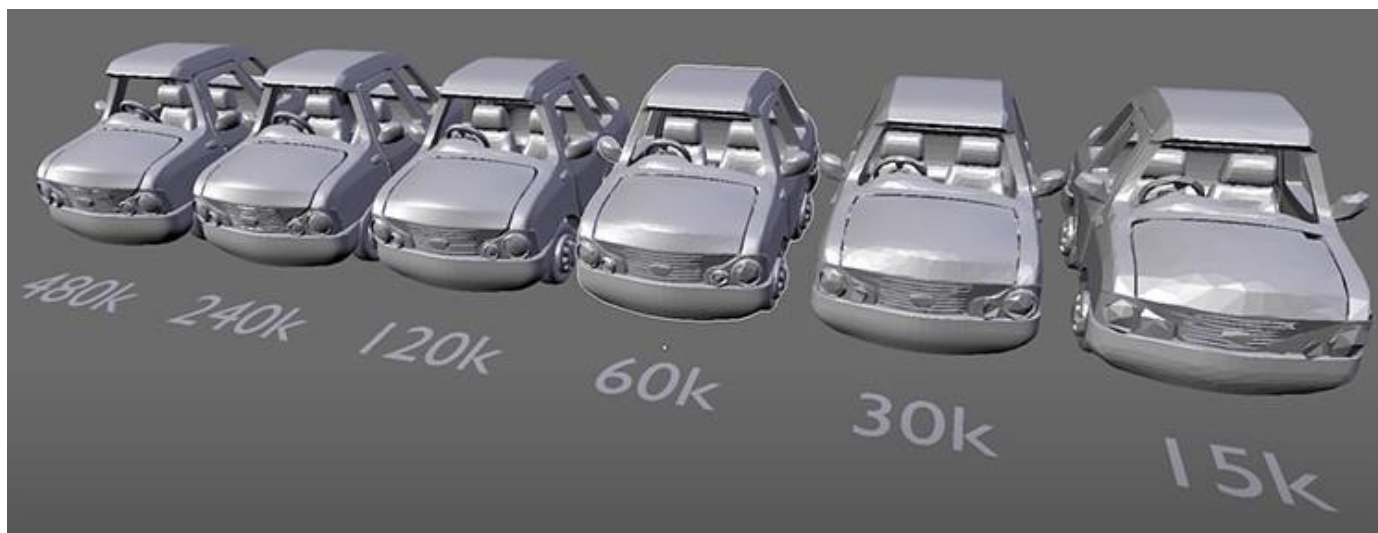
Slika 2.4 Razvoj LOD modela kroz pet razina
