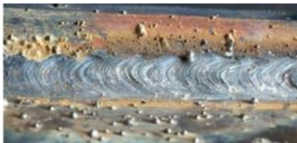
Slika 8.2 Realni izgled prskanja
