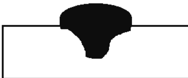
Slika 6.1 Utjecaj argona na geometriju zavara
