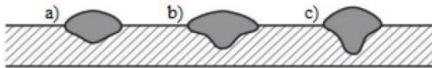
Slika 8.5 Utjecaj jačine struje na zavar
