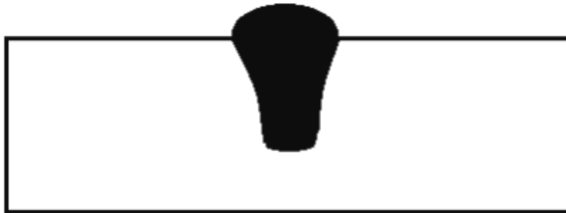
Slika 6.3 Utjecaj ugljikovog dioksida na geometriju zavara
