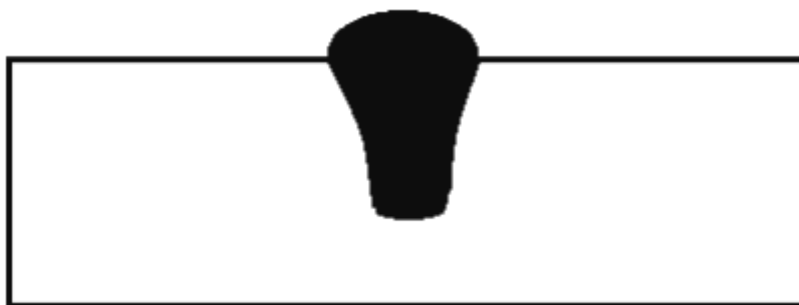
Slika 6.3 Utjecaj ugljikovog dioksida na geometriju zavara
