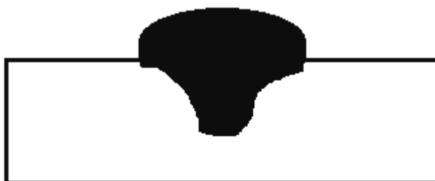
Slika 6.1 Utjecaj argona na geometriju zavara
