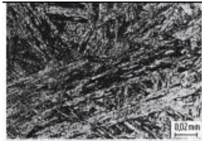
Slika 10.5 Mikrostruktura martenzitnog nehrđajućeg čelika
