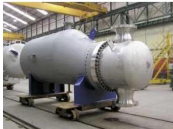
Slika 13.1 Visokotlačni sparivač
