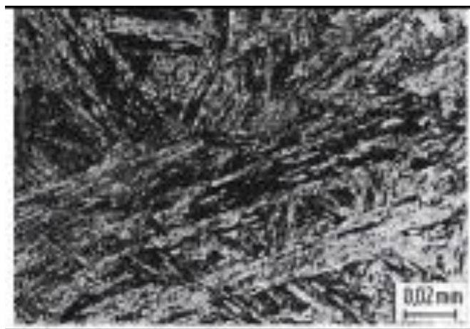
Slika 10.5 Mikrostruktura martenzitnog nehrđajućeg čelika
