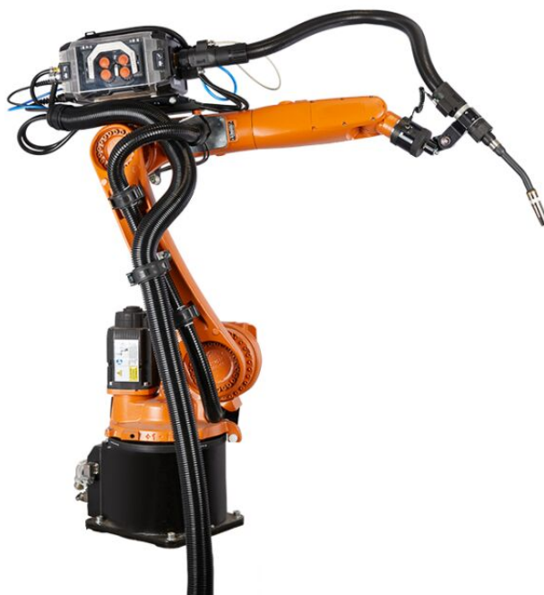
Slika 1.1 Primjer robota za zavarivanje [25]
