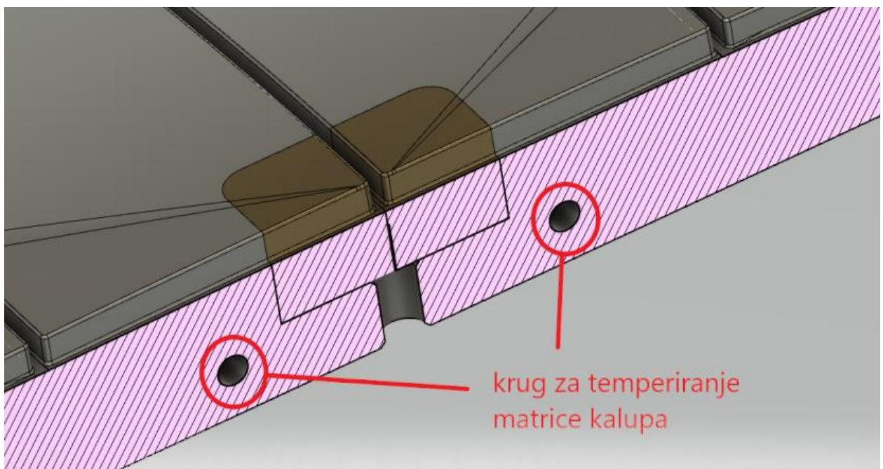
Slika 6.8.2.4. 3D prikaz ugrađenog umetka u matricu kalupa [35]
