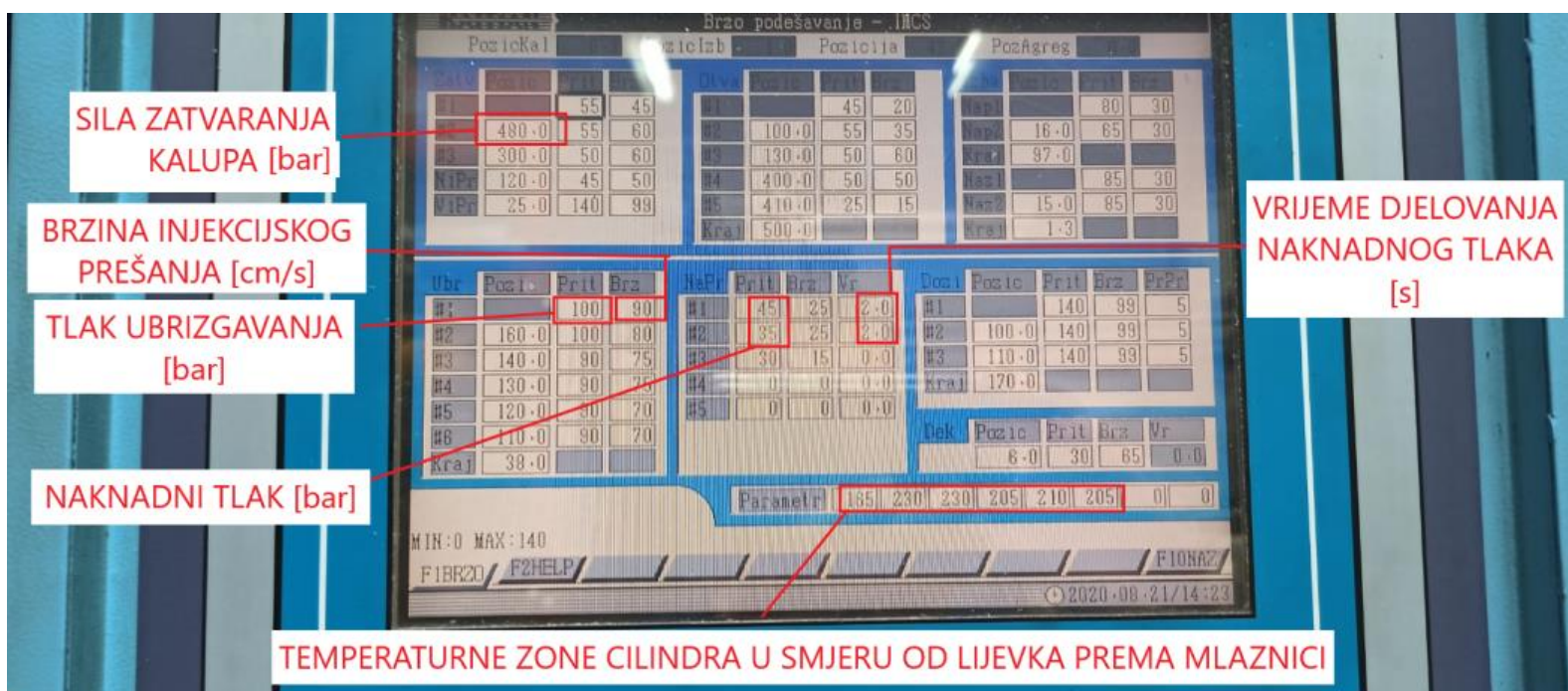
Slika 6.5.1.1. Parametri korišteni kod izrade probnog uzorka [22]
