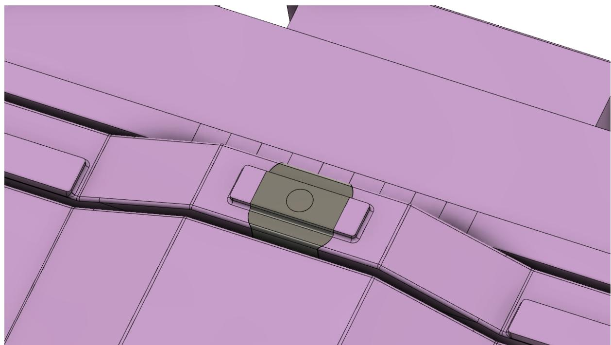
Slika 6.8.4. Konačan izgled klizača sa ugrađenim umetkom [31]
