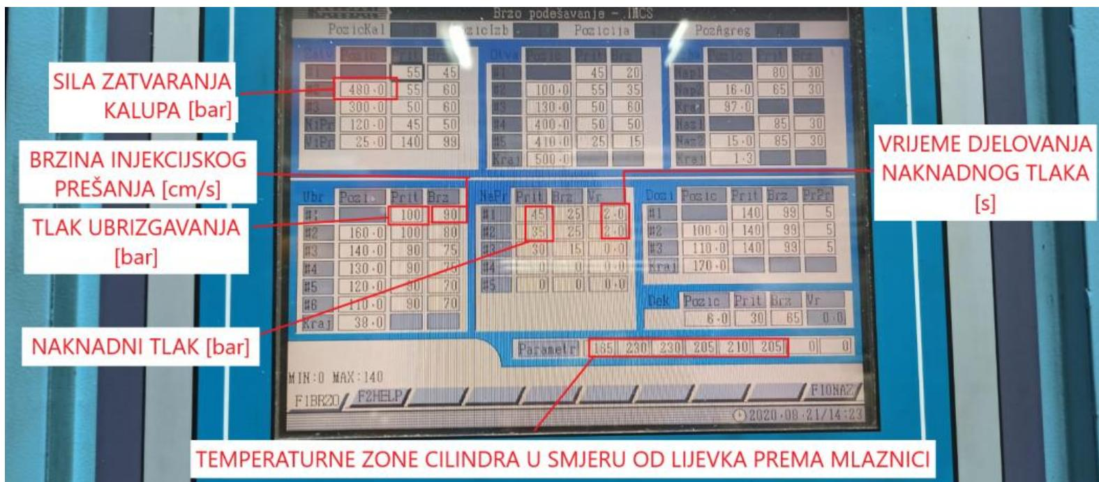
Slika 6.5.1.1. Parametri korišteni kod izrade probnog uzorka [22]
