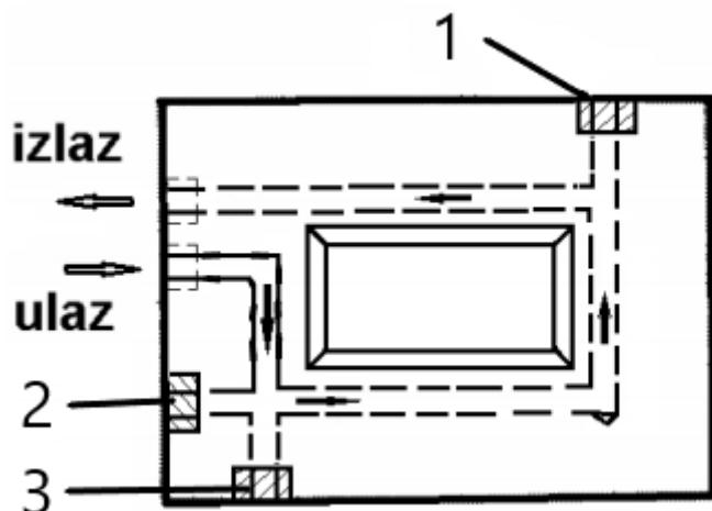
*Slika 5.6.2.1. Krug za temperiranje ploča kalupa [16]*
