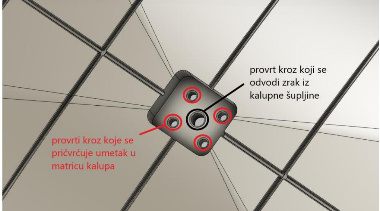
*Slika 6.8.2.1. Utor za umetak u matrici kalupa [32]*
