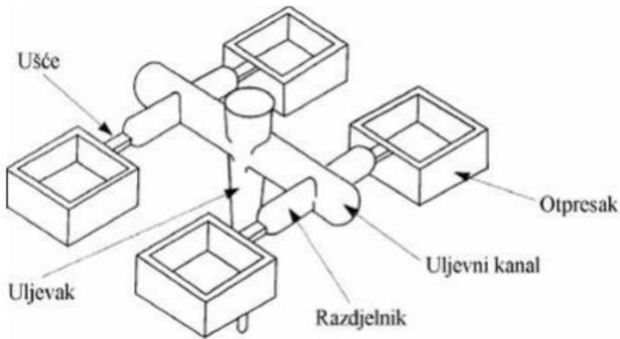
Slika 5.2.1. Čvrsti ili hladni uljevni sustav [6]
