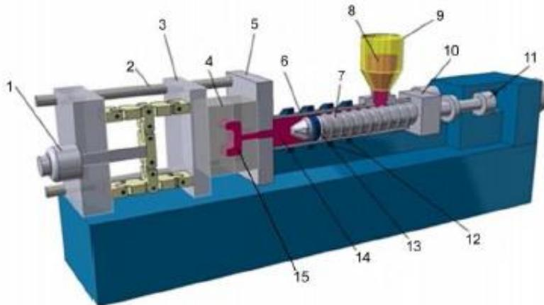
Slika 4.1. Stroj za injekcijsko prešanje polimernih materijala [2]
