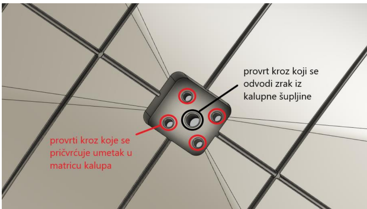
Slika 6.8.2.1. Utor za umetak u matrici kalupa [32]
