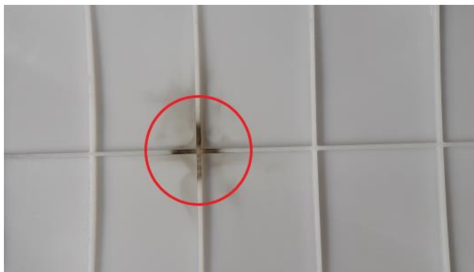
Slika 6.5.2.2. Oštećenje na strani matrice kalupa [24]
