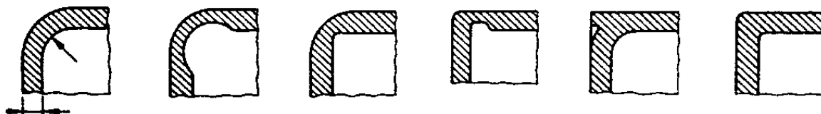
Slika 2.16. Pregled različitih načina oblikovanja kutova polimernih proizvoda [23]
