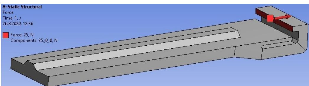
Slika 4.32. Prikaz djelovanja sile na kopču zatvarača
