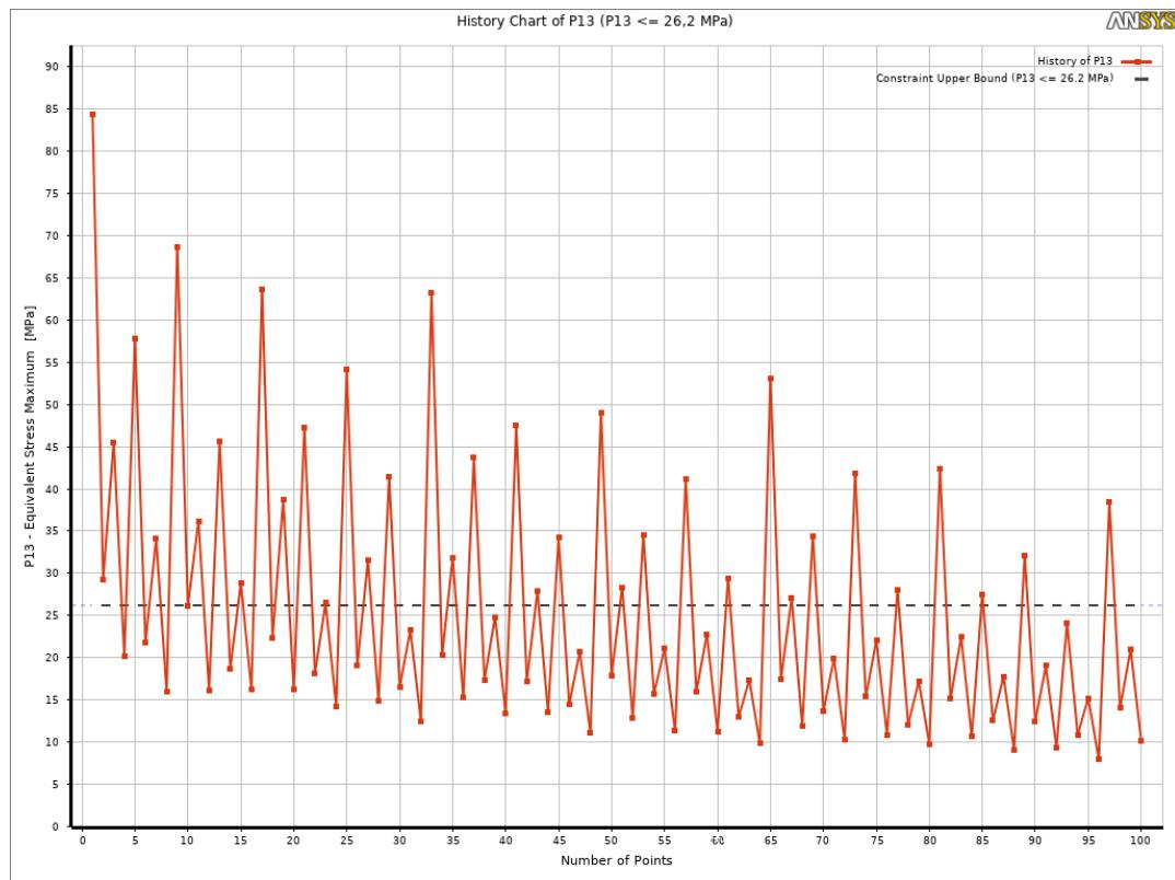
Slika 5.12. Prikaz promjene vrijednosti ekv. naprezanja u procesu optimizacije
