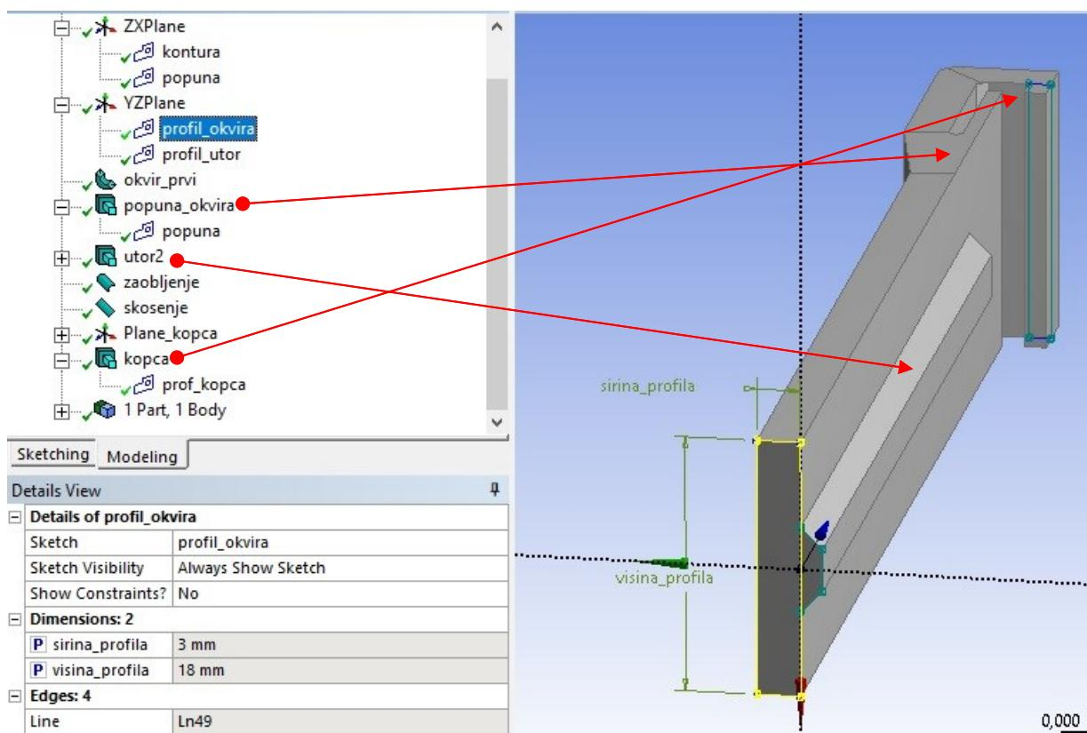
Slika 5.2. Prikaz profila okvira i parametara optimiranja
