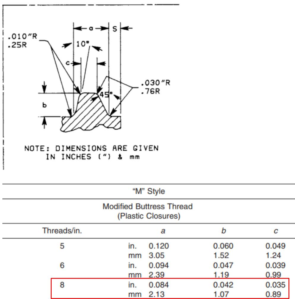
Slika 4.12. Specifikacije pilastog navoja SP400 [37]
