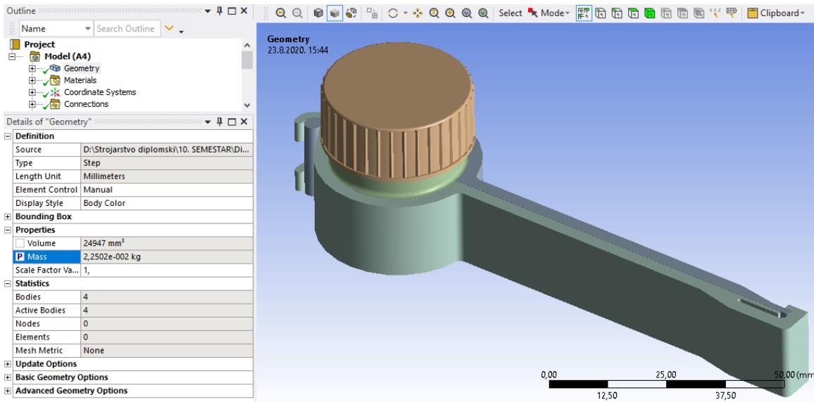
Slika 4.44. Provjera mase cijele konstrukcije višenamjenskog zatvarača
