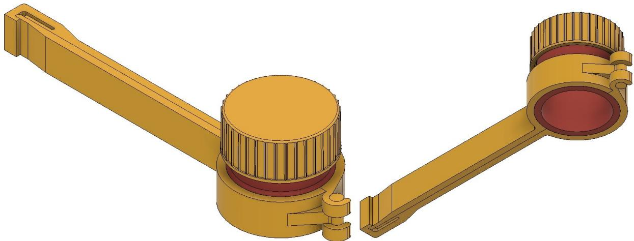
Slika 5.21. Sastavljena optimirana konstrukcija višenamjenskog polimernog zatvarača
