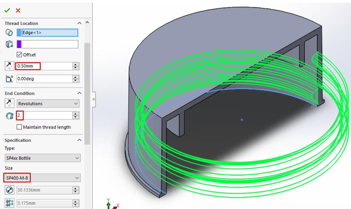
Slika 4.14. Prikaz specifikacije unutarnjeg navoja navojnog čepa SP400-M-8 u SolidWorksu
