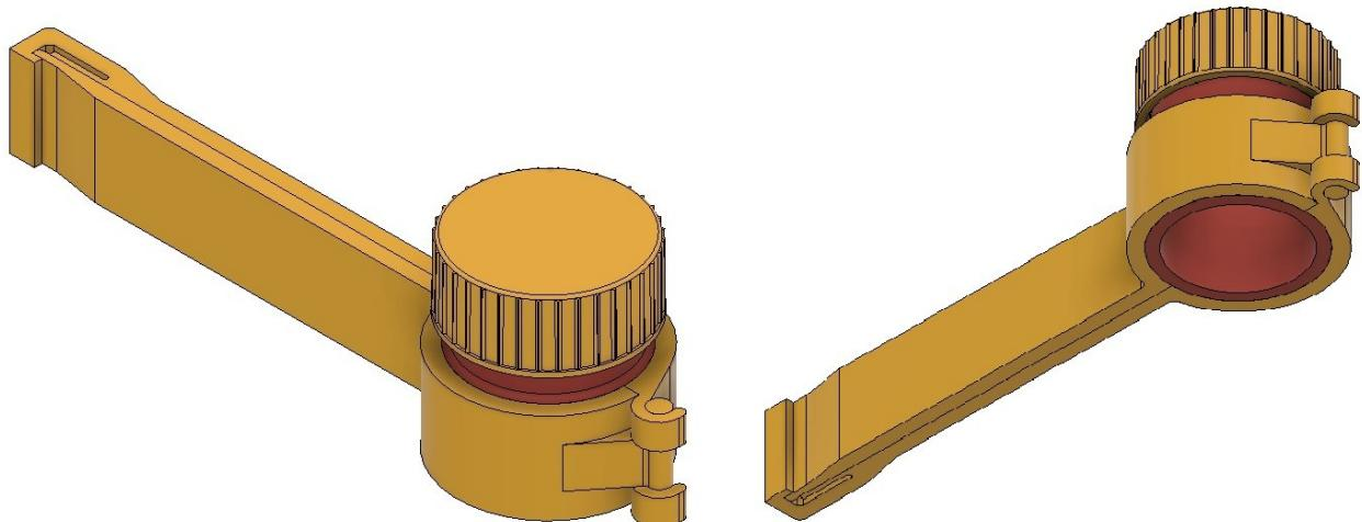
Slika 4.43. Sastavljena konstrukcija višenamjenskog zatvarača
