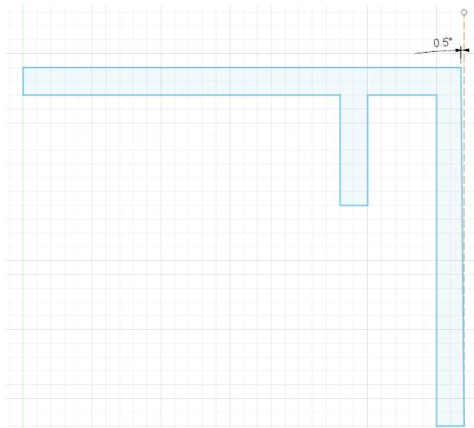
Slika 4.9. Prikaz profila navojnog čepa sa skošenjem
