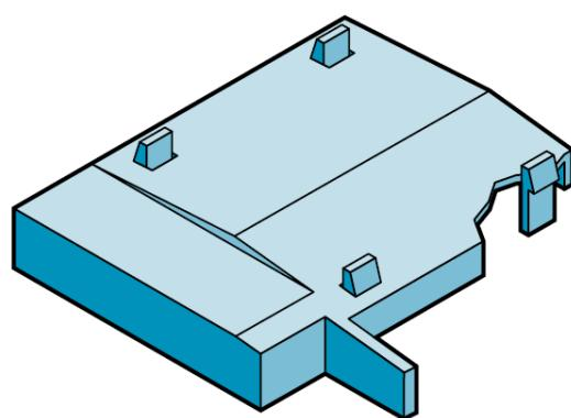
Slika 2.28. Primjer pričvršćivanja dijelova – poklopac [17]
