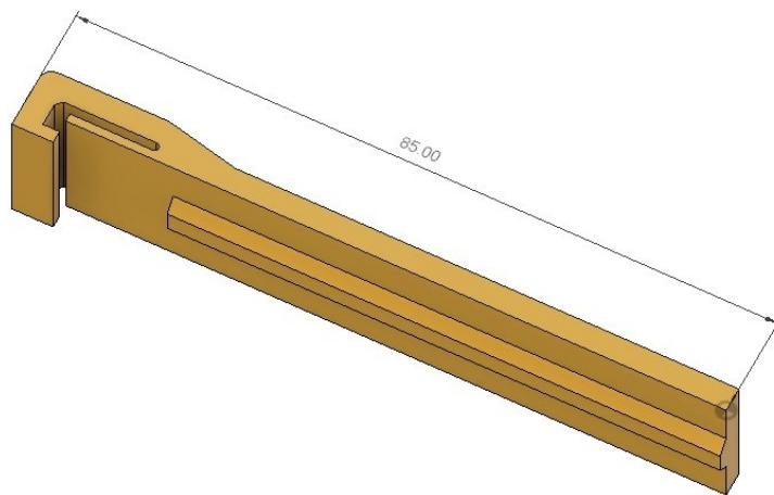
Slika 4.22. Prikaz pojednostavljenog dijela okvira za proračun
