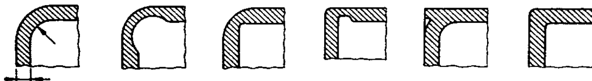
Slika 2.16. Pregled različitih načina oblikovanja kutova polimernih proizvoda [23]
