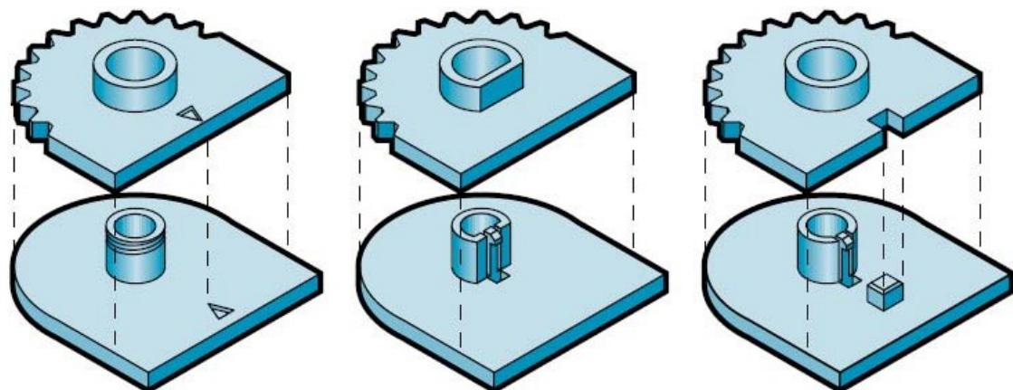
Slika 2.31. Primjeri orijentiranja dijelova – nesimetrični dijelovi [17]
