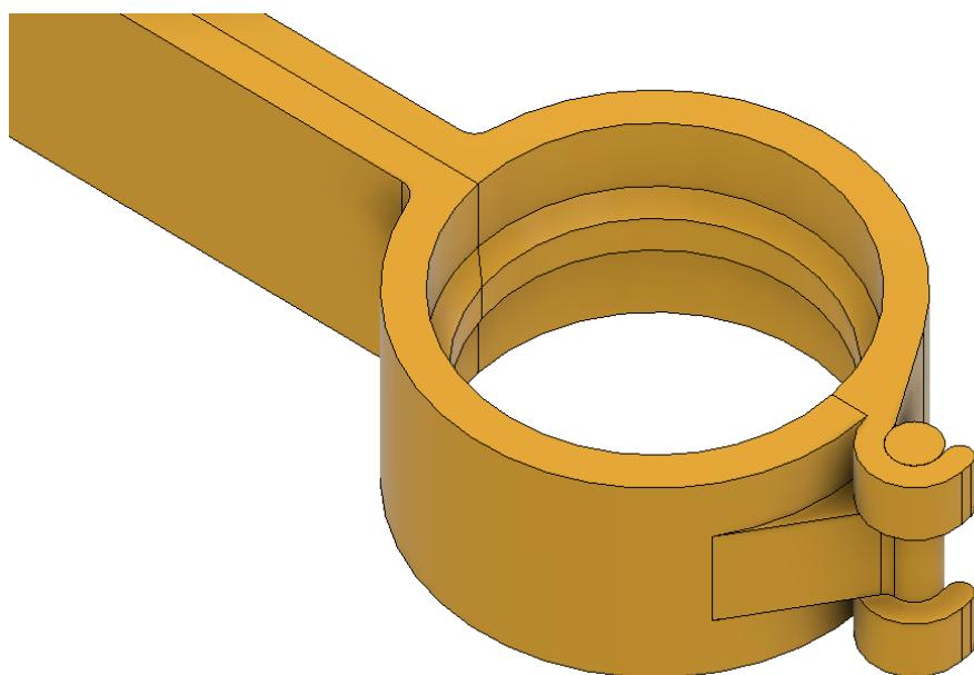
Slika 4.16. Integriranje funkcija izvedbom šarki bez zatika
