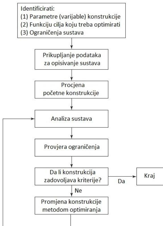
Slika 3.1. Dijagram tokova optimalnog procesa konstruiranja [29]
