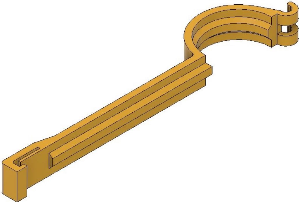
*Slika 5.18. Okvir s kopčom optimirane konstrukcije zatvarača*
