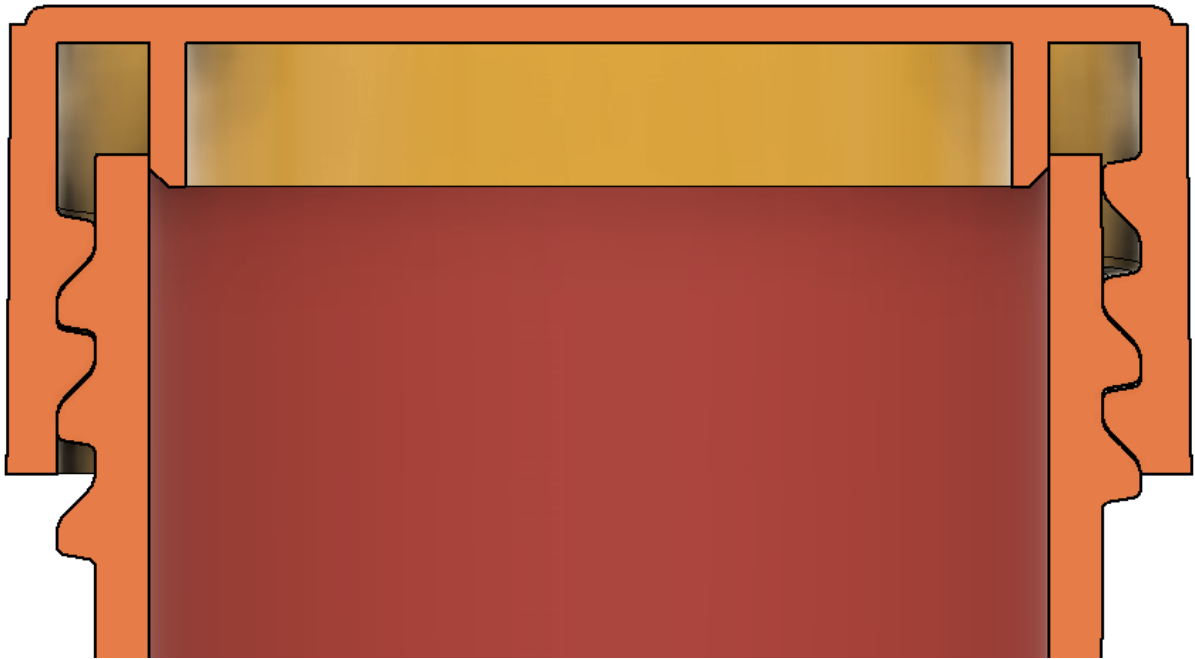
Slika 4.19. Prikaz skošenja brtvenog trna na navojnom čepu
