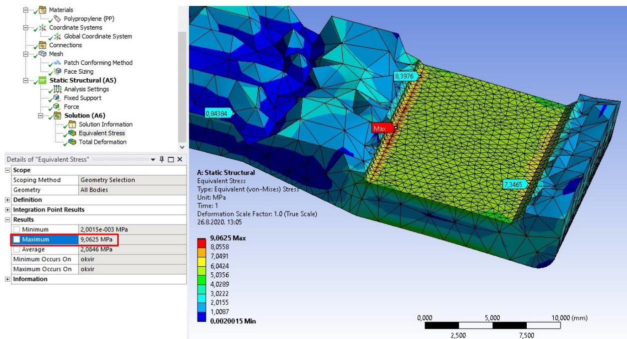
Slika 4.36. Prikaz mesta najvećeg ekvivalentnog naprezanja s unutarnje strane kopče
