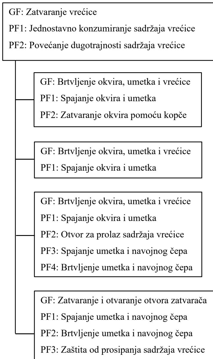
Slika 4.4. Gruba funkcija struktura višenamjenskog polimernog zatvarača
