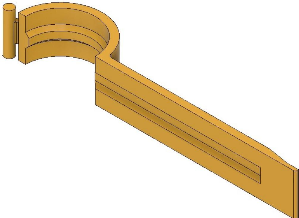
*Slika 4.40. Umetni okvir konstrukcije višenamjenskog zatvarača*
