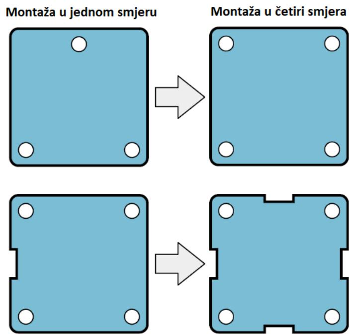
Slika 2.30. Primjeri orijentiranja dijelova – simetrični dijelovi [17]
