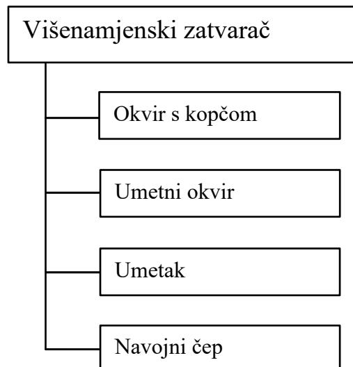
*Slika 4.3. Hjerahijijsko stablo višenamjenskog polimernog zatvarača*
