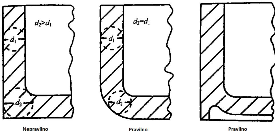
Slika 2.15. Primjeri oblikovanja i dimenzioniranja kutova polimernih proizvoda [23]
