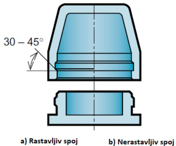
Slika 2.27. Primjer pričvršćivanja dijelova – rastavljiv i nerastavljiv spoj [17]
