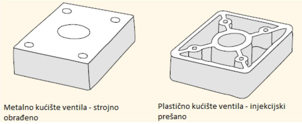
*Slika 2.10. Primjer ostvarivanja minimalne mase kućišta ventila [20]*
