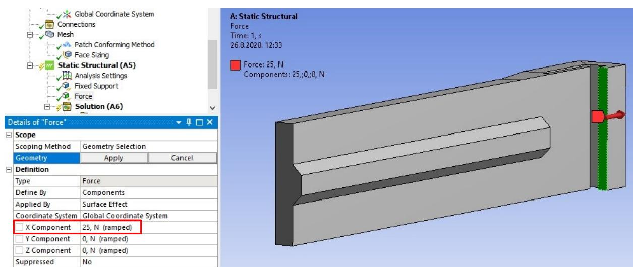
Slika 4.31. Prikaz definiranja površine, smjera i iznosa sile
