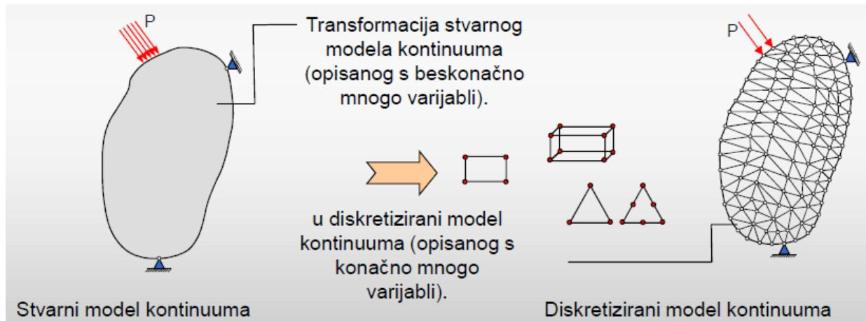
Slika 3.5. Princip rada metode konačnih elemenata [33]
