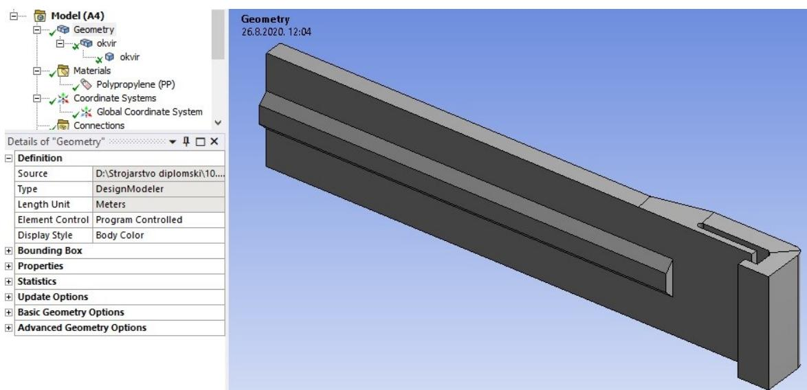
Slika 4.24. Prikaz 3D modela proračunskog dijela konstrukcije u ANSYSu
