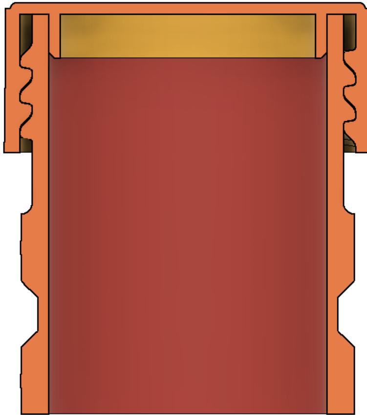
Slika 4.6. Prikaz presjeka navojnog čepa i umetka
