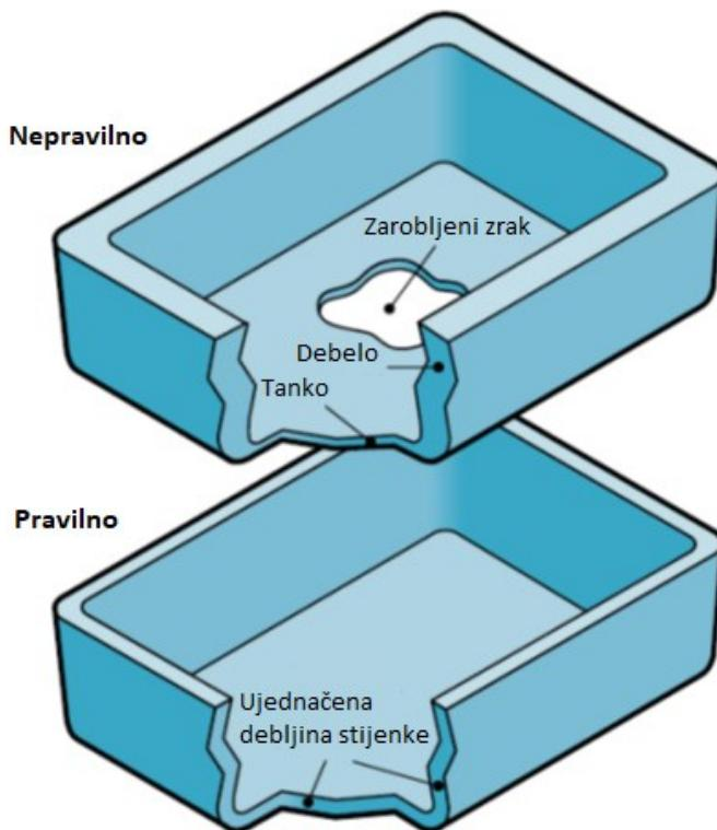
Slika 2.11. Primjer nepravilnog i pravilnog oblikovanja debljine stijenki [17]
