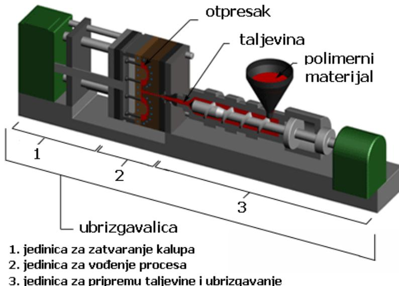
Slika 2.7. Stroj za injekcijsko prešanje (ubrizgavalica) [21]
