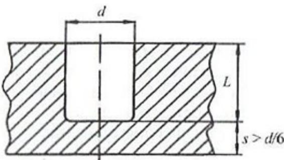
*Slika 2.22. Presjek slijepih rupa u polimernom otpresku [23]*
