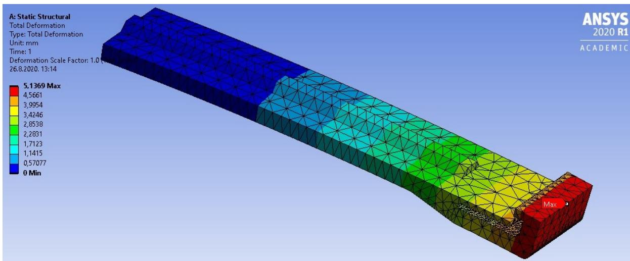
Slika 4.38. Prikaz ukupne deformacije proračunskog dijela konstrukcije
