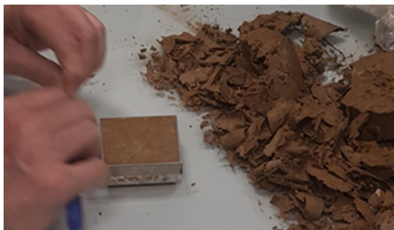
Slika 4.17. Proces oblikovanja ispitnog tijela u kalupu dimenzija 60 \times 60 \times 20 mm
