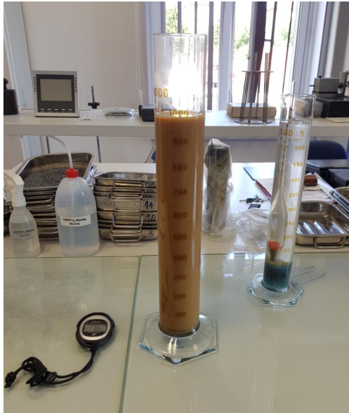
Slika 4.7. Provođenje pokusa areometriranja
