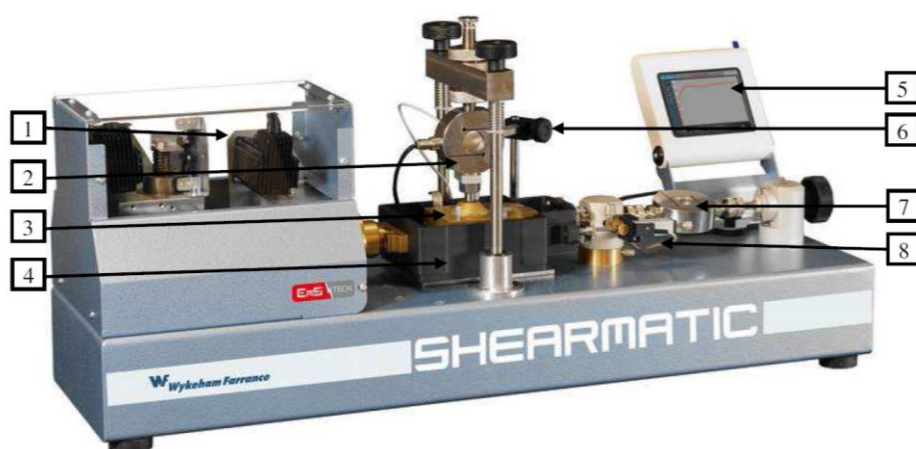
Slika 4.12. Prikaz uređaja sa glavnim dijelovima - (izvor [18])
