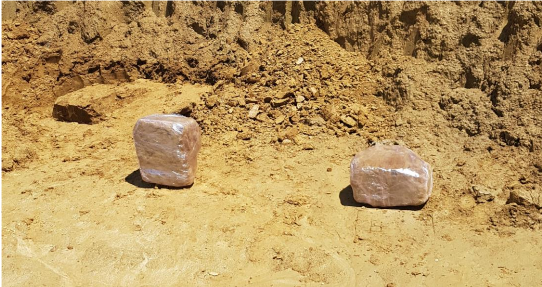
Slika 3.7. Ispitni uzorci umotani u plastičnu foliju i pripremljeni za transport
