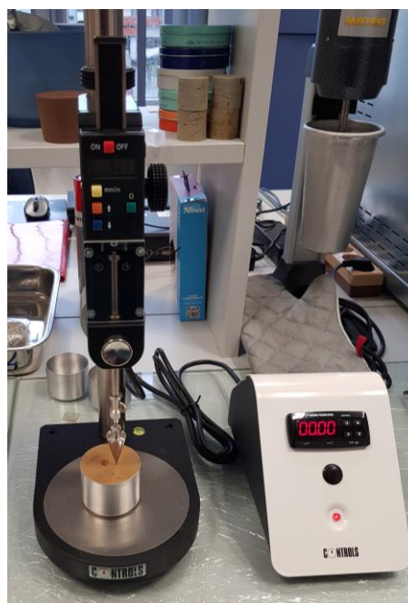
Slika 4.4. Proces ispitivanja konusnim penetrometrom
