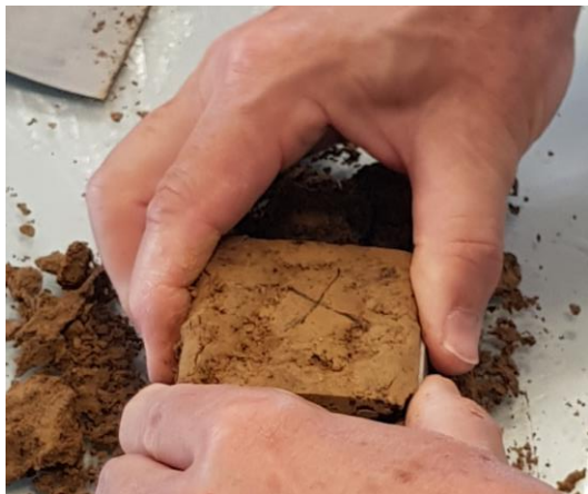
Slika 4.15. Proces oblikovanja ispitnog tijela za smjer smicanja 0^\circ
