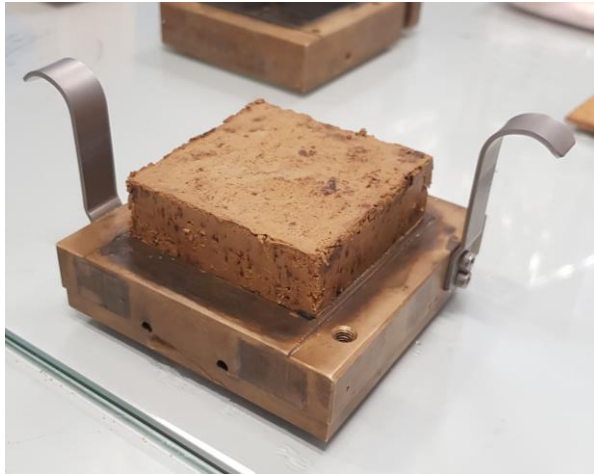
Slika 4.22. Ispitno tijelo ugrađeno u donji okvir ćelije
