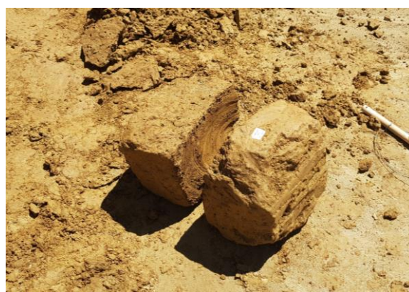
Slika 3.6. Izvađeni uzorak prepolovljen na dva ispitna uzorka
