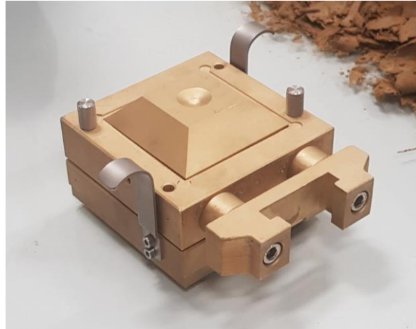
Slika 4.23. Potpuno sastavljena ćelija s ugrađenim ispitnim tijelom
