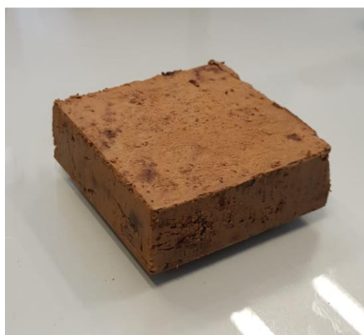
Slika 4.19. Potpuno oblikovano ispitno tijelo istisnuto iz kalupa
