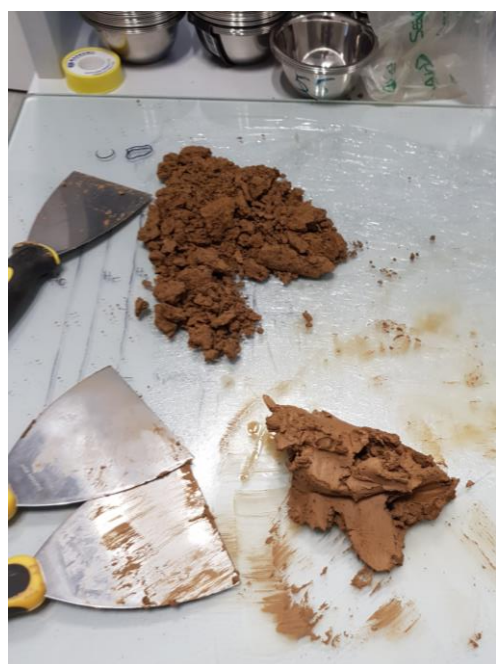
Slika 4.3. Proces homogeniziranja uzorka
