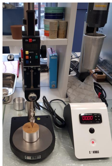
Slika 4.4. Proces ispitivanja konusnim penetrometrom
