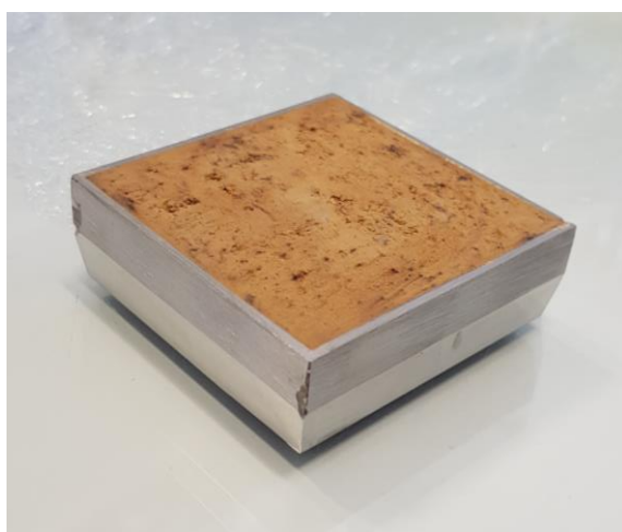
Slika 4.18. Ispitno tijelo izrezano kalupom i poravnatim kontaktnim ploham
