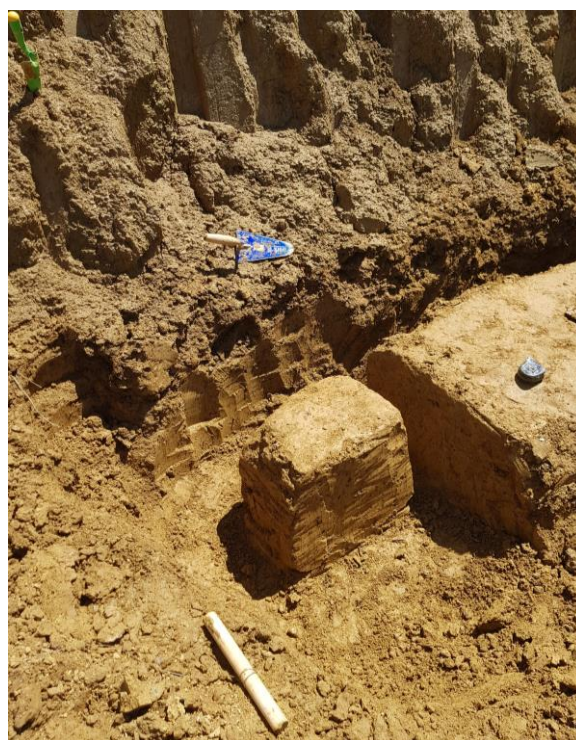
Slika 3.4. Uzorak pripremljen za vađenje
