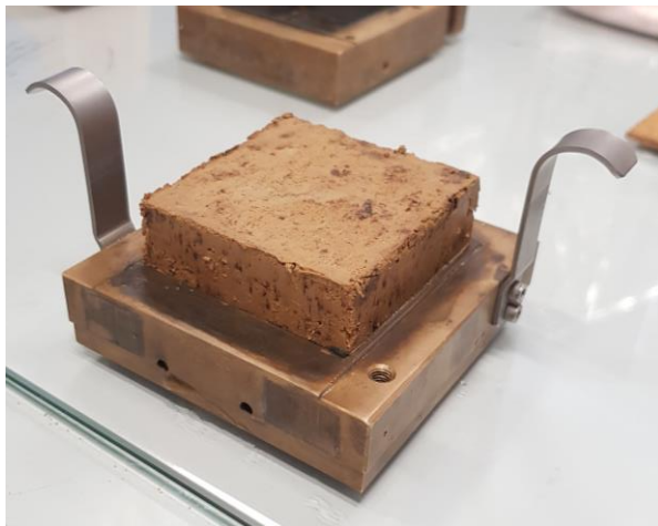
Slika 4.22. Ispitno tijelo ugrađeno u donji okvir ćelije
