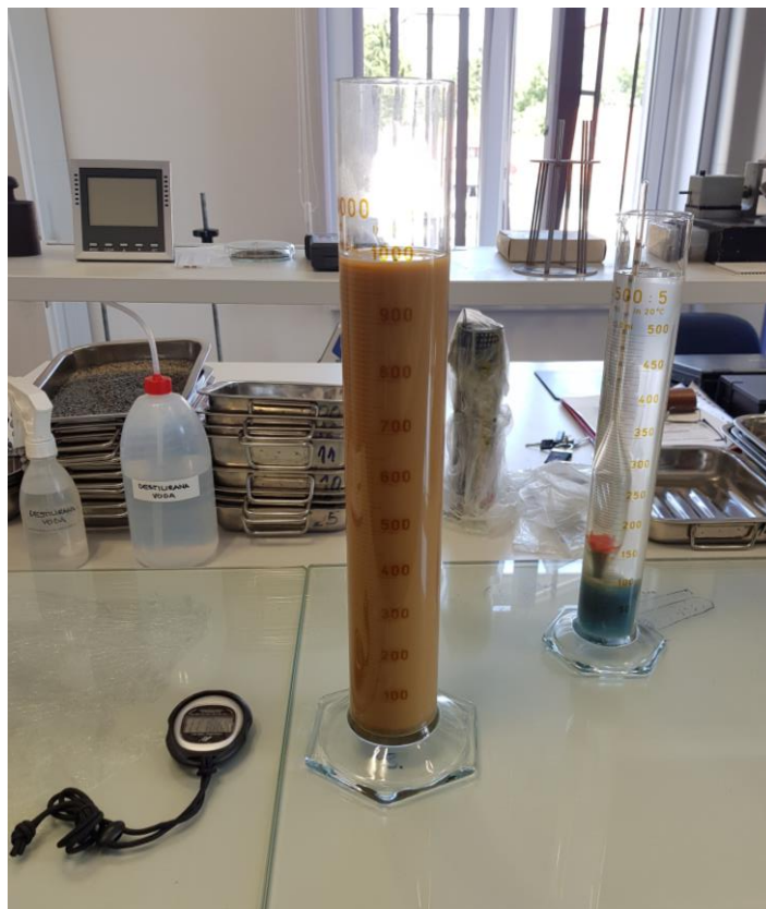
Slika 4.7. Provođenje pokusa areometriranja
