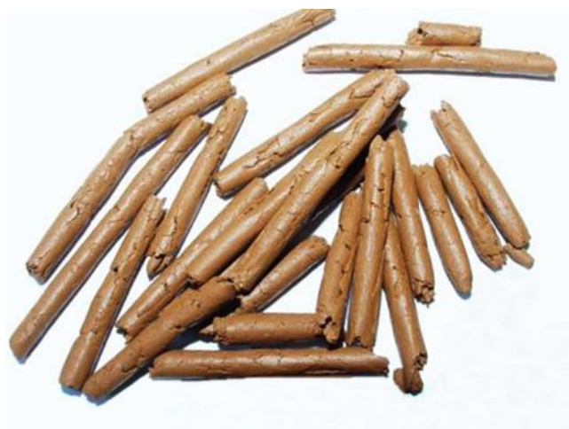
Slika 4.2. Valjčići na granici plastičnosti tijekom ispitivanja
