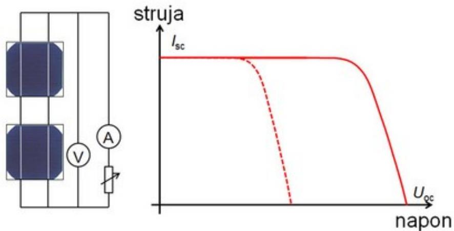
Slika 7.3. serijsko spajanje fotonaposnkog modula
