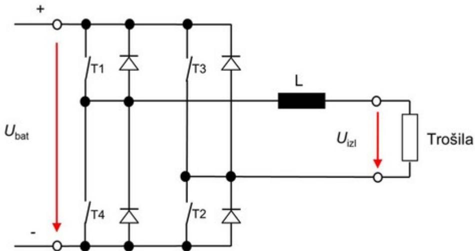
Slika 7.5. Struktura DC-AC izmjenjivača
