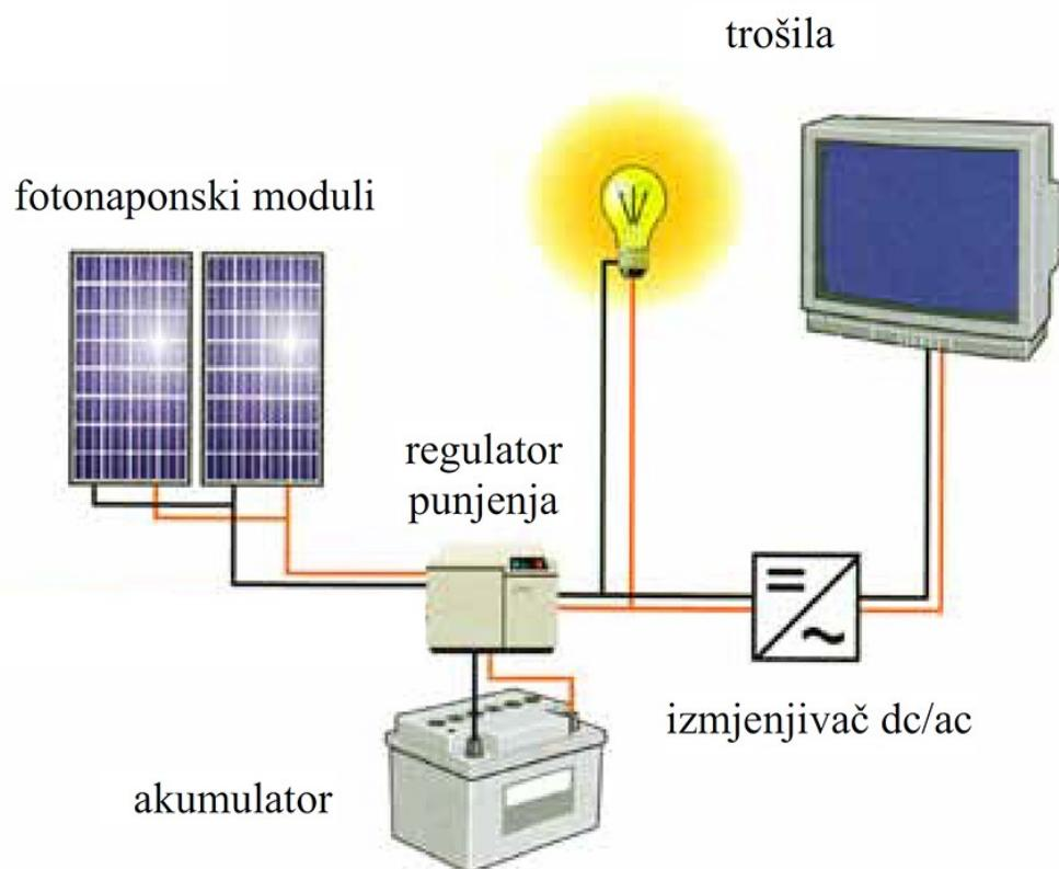
Slika 6.2. Otočni fotonaponski sustav
