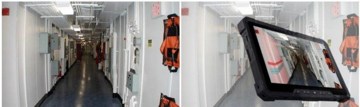
Slika 21 Operator koristi predloženi sustav za pregled instalacija koje su golim okom nevidljive u pogodjenom području, odlučujući za spretniji i brži način popravljanja
