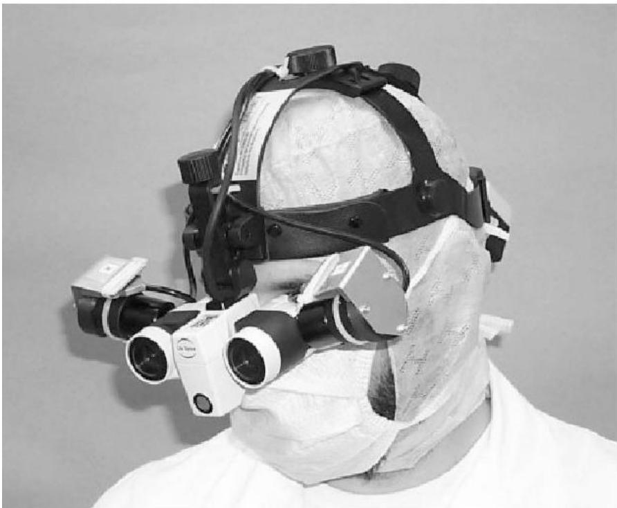
Slika 12 Prototip Varioscope AR sa dva minijaturna VGA zaslona postavljena okomito na glavne leće
