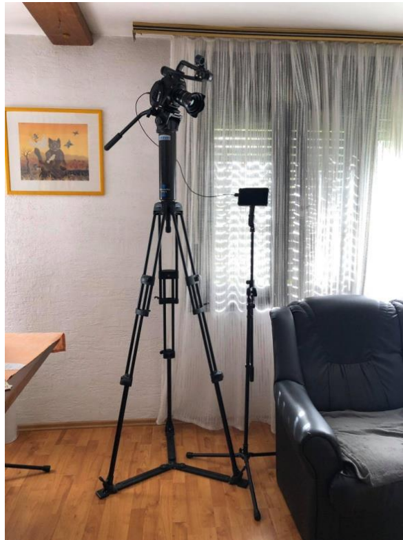
Slika 14 Kamera, objektiv, stativi, i eksterni monitor: Atomos ninja 5
