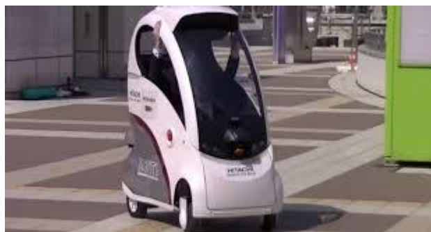
Slika 34. Vozilo Ropits za prijevoz nepokretnih osoba
