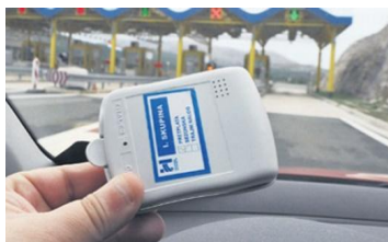
Slika 26. ENC uređaj za naplatu cestarine
