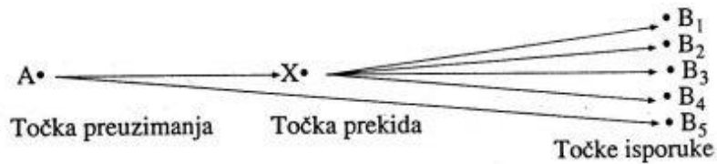
Slika 4. Struktura kombiniranog logističkog sustava
