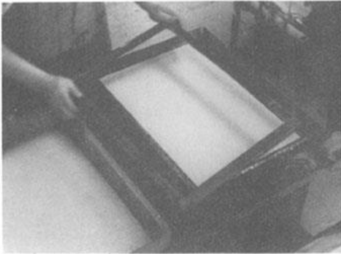
Slika 6 Postavljanje kalupa na filc i odstranjivanje okvira za oblikovanje
