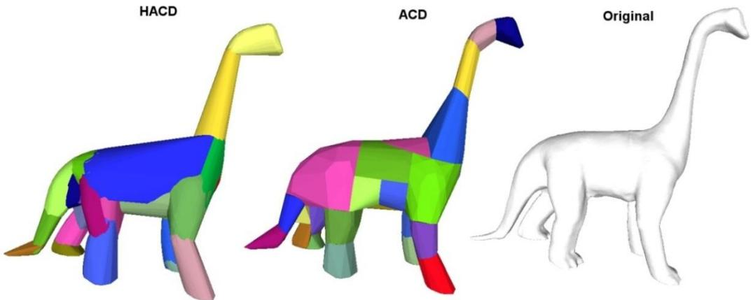
*Slika 3.6. Prikaz tipova automatske konveksne dekompozicije. [19]*
