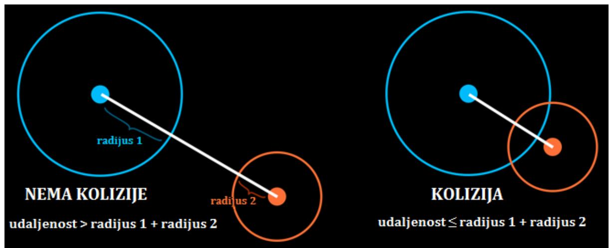
Slika 2.2. Jedna od osnovnih metoda geometrijske detekcije kolizije. [4]
