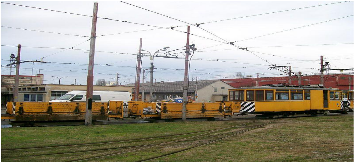
Slika 5.9. M-24 teretni tramvaj s dvjema prikolicama
