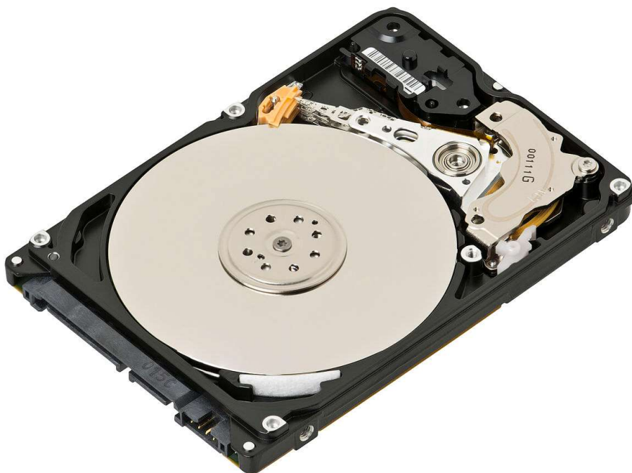
Slika 2.1.2 8 Otvoreni tvrdi disk s prikazanim komponentama
