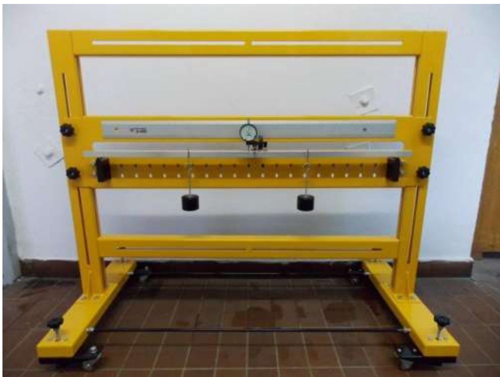
Slika 1.1 Didaktički uređaj za mjerenje progiba grede [1]
