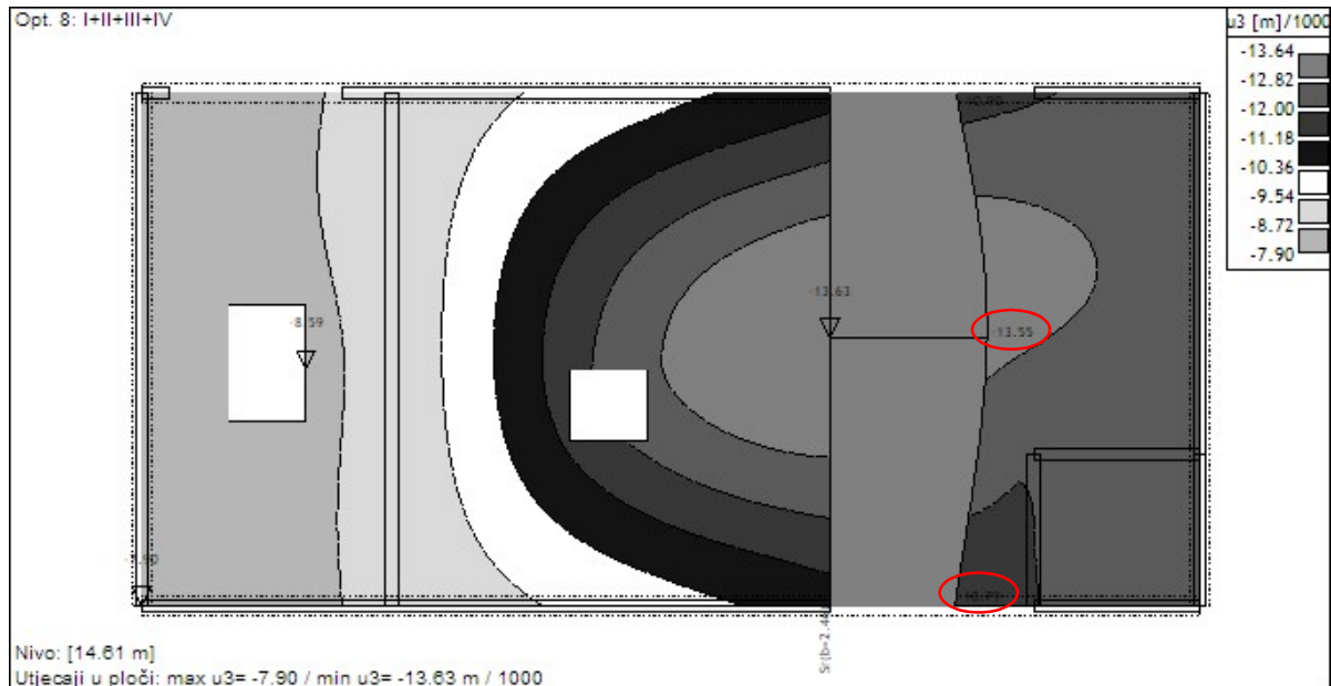
Slika 4.15 - Progib ploče stropa 3. kata
