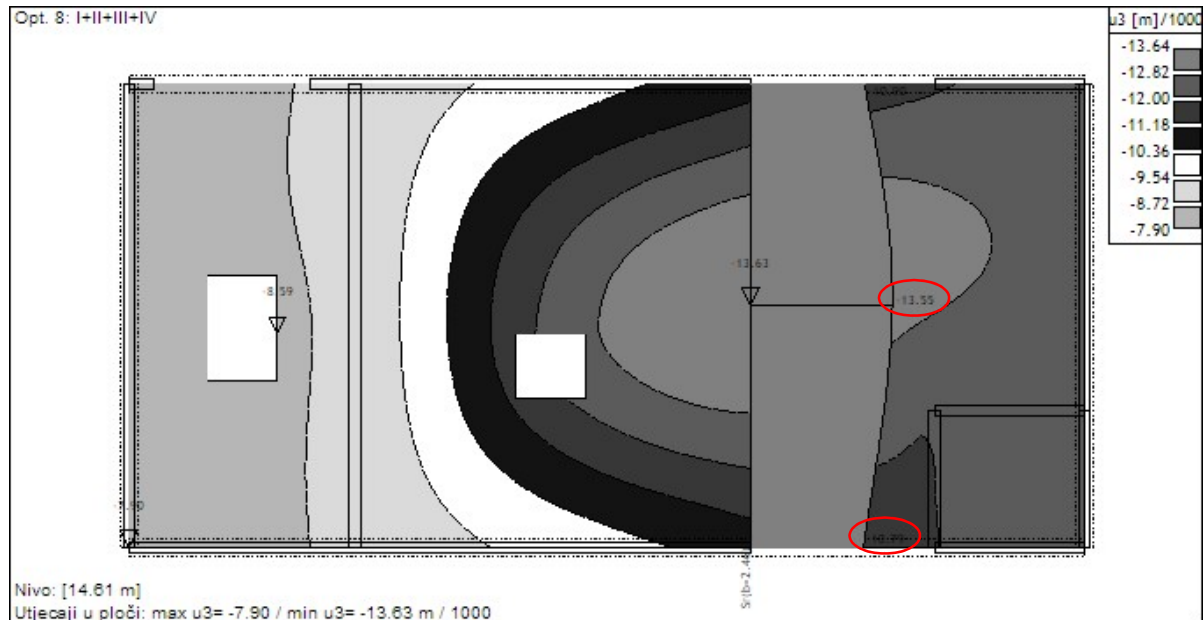
Slika 4.15 - Progib ploče stropa 3. kata
