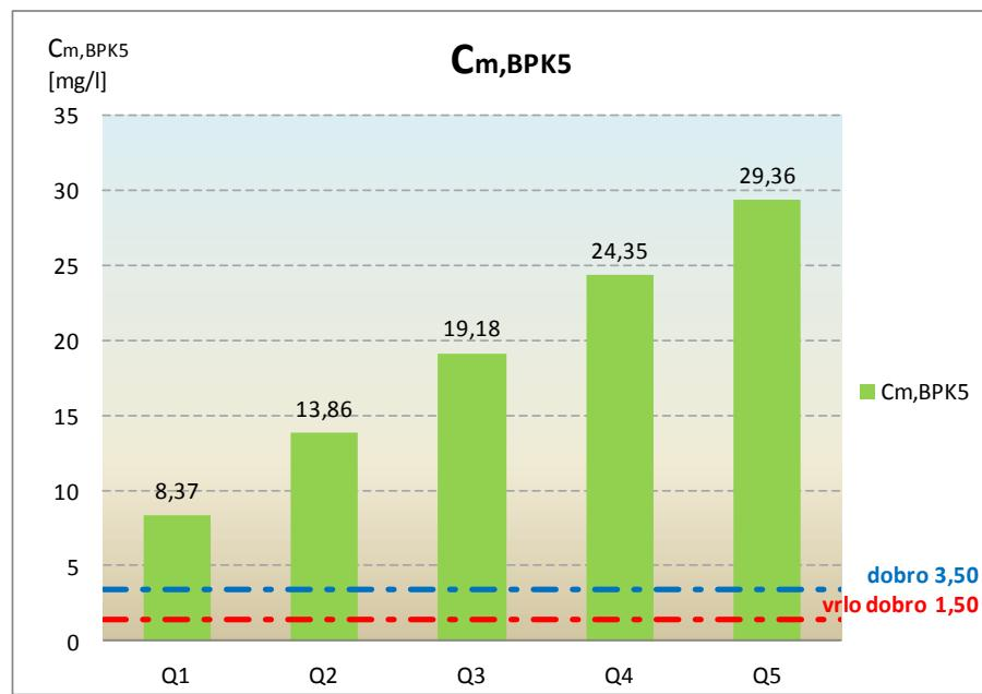
Slika 5.10. Grafički prikaz koncentracija BPK<sub>5</sub> nakon miješanja preljevnih voda i protoka kroz akumulaciju u ovisnosti dinamici rada crpki crpne stanice za preljevne količine
