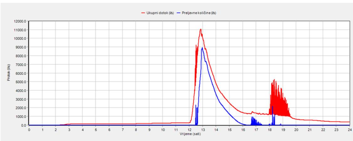
*Slika 3.2. Ukupni dotok na lokaciji analiziranog kišnog preljeva i preljevne količine pri pojavi mjerodavne oborine PP 5 god*
