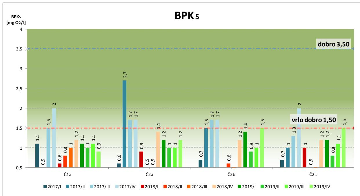
Slika 4.2. Koncentracija BPK<sub>5</sub> u Akumulaciji HEČ u analiziranim kontrolnim točkama kroz period 2017.-2019.
