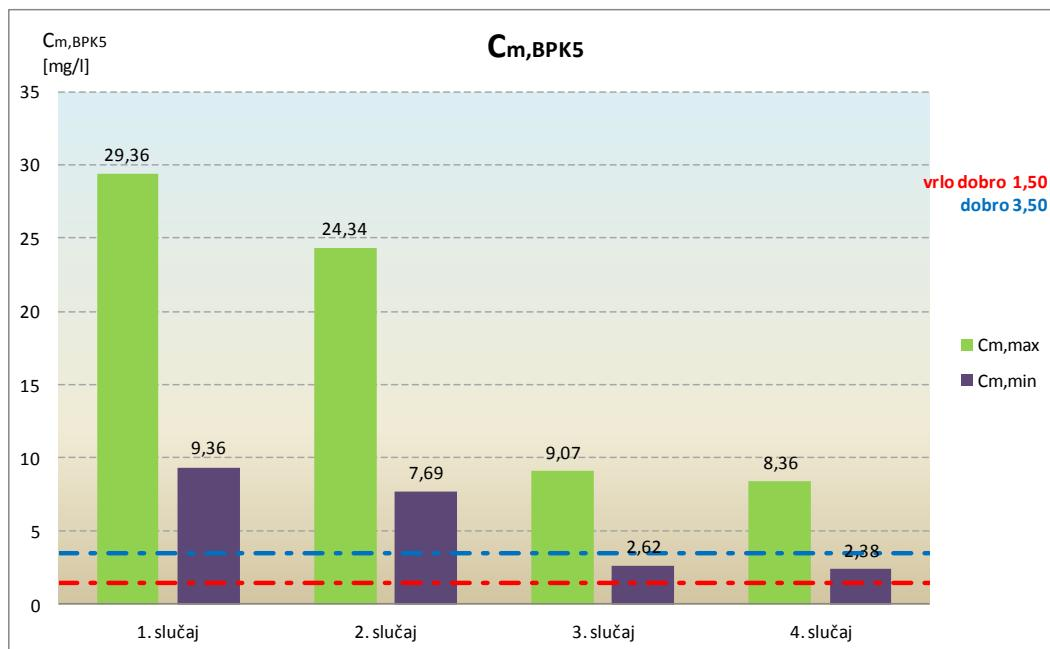
Slika 5.3. Grafički prikaz koncentracija BPK<sub>5</sub> nakon miješanja preljevnih voda i protoka kroz kumulaciju
