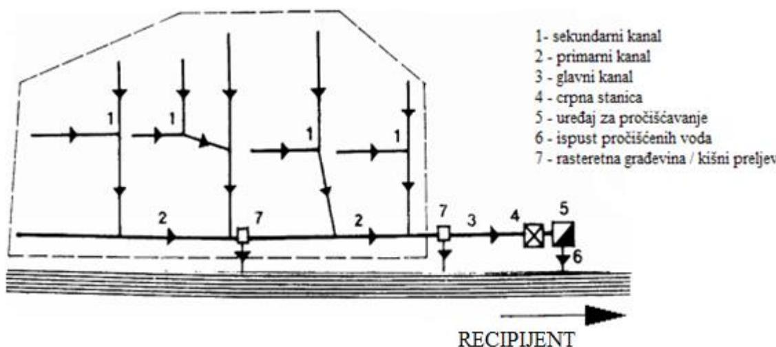
*Slika 2.1. Shema mješovite kanalizacije s kišnim rasterećenjem*
