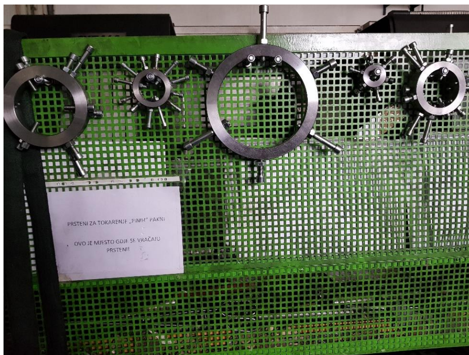
Slika 4.10 Primjer 2 - podesivi prsteni nakon realizacije prijedloga zaposlenog
