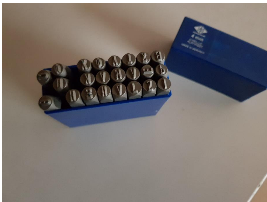
Slika 4.11 Primjer 3 - stariji način označavanja proizvoda prije prijedloga
