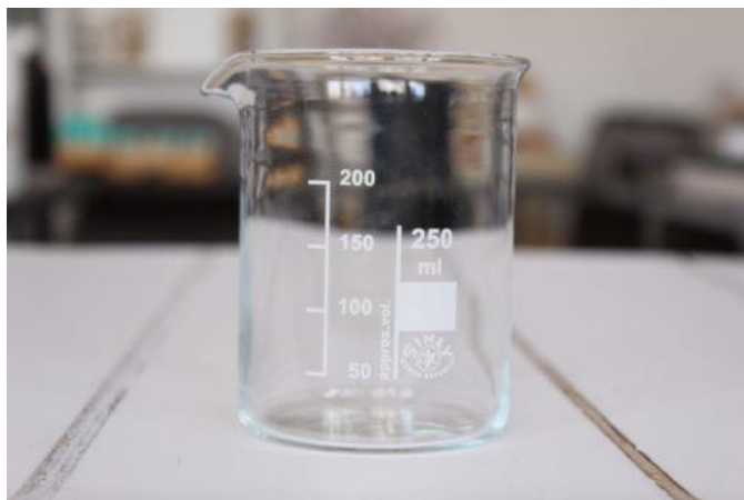
Slika 3.13: Laboratorijska čaša volumena 250ml
