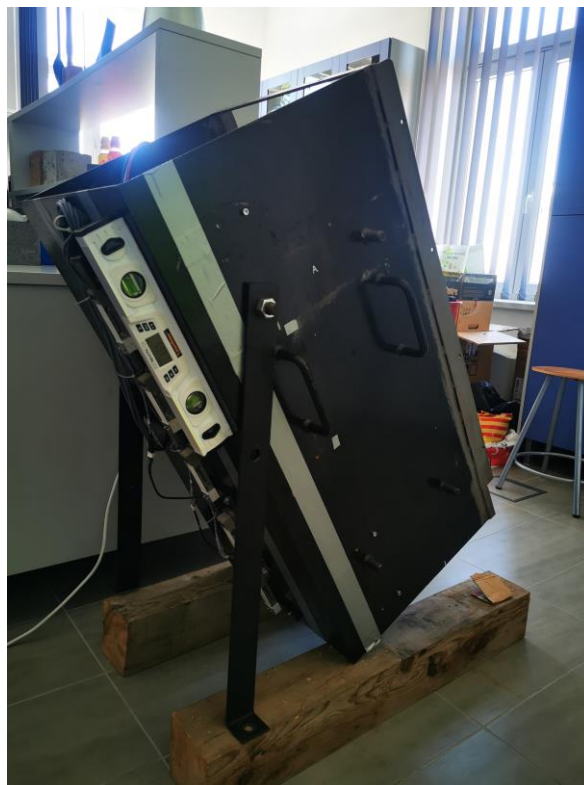
Slika 3.3: Ugradnja modela pod kutom
