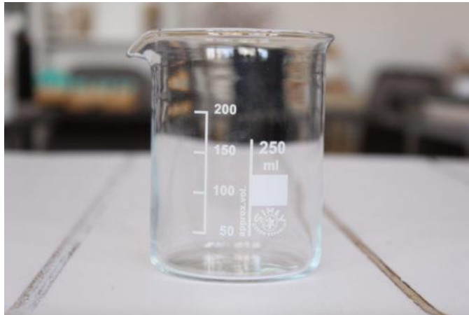
Slika 3.13: Laboratorijska čaša volumena 250ml
