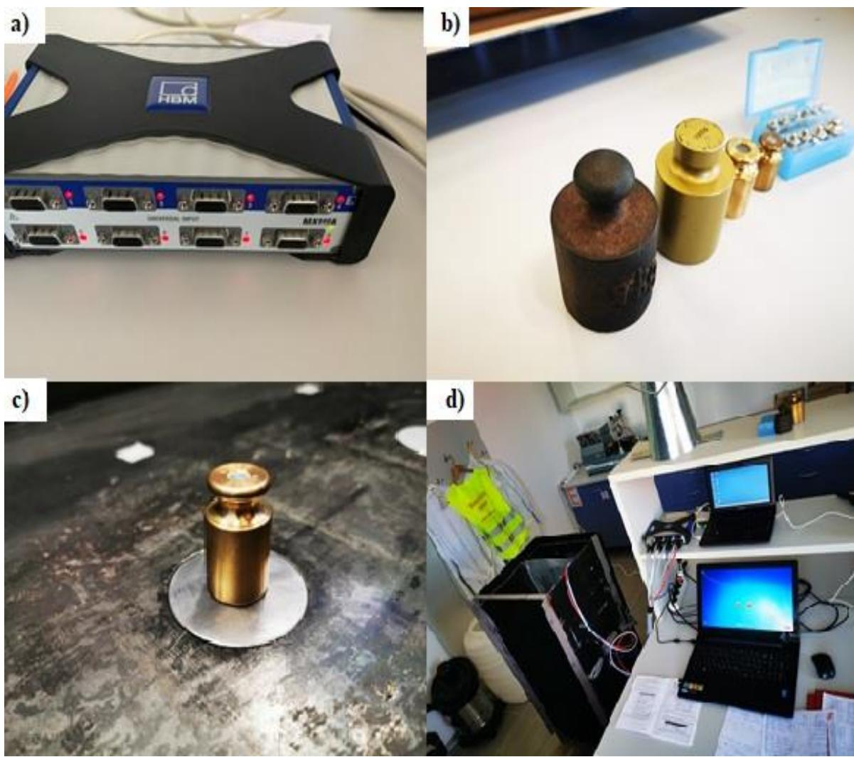
*Slika 3.9: Umjeravanje tenziometarskih konzolnih čelija: a) pojačalo QuantumX MX840A; b) utezi korišteni u kalibraciji; c) uteg prilikom kalibracije na tenziometarskoj čeliji; d) senzori povezani na računalo preko pojačala*
