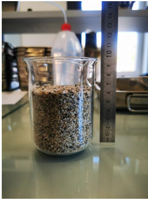
Slika 3.14: Mjerenje visine pijeska u čaši
