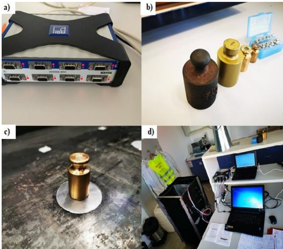
Slika 3.9: Umjeravanje tenziometarskih konzolnih ćelija: a) pojačalo QuantumX MX840A; b) utezi korišteni u kalibraciji; c) uteg prilikom kalibracije na tenziometarskoj ćeliji; d) senzori povezani na računalo preko pojačala
