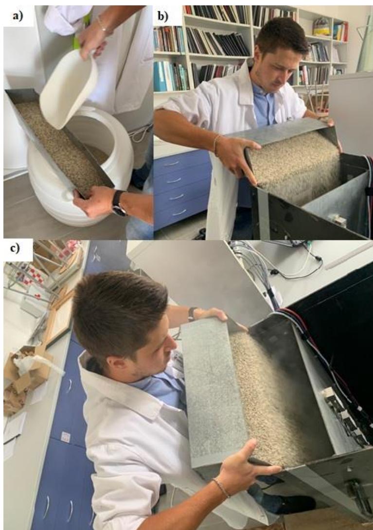
Slika 3.22: a) Stavljanje pijeska lopaticom u metalnu kutiju; b) Zasipavanje pijeska u eksperimentalni model; c) Prikaz zasipavanja pijeska u model slikano odozgo
