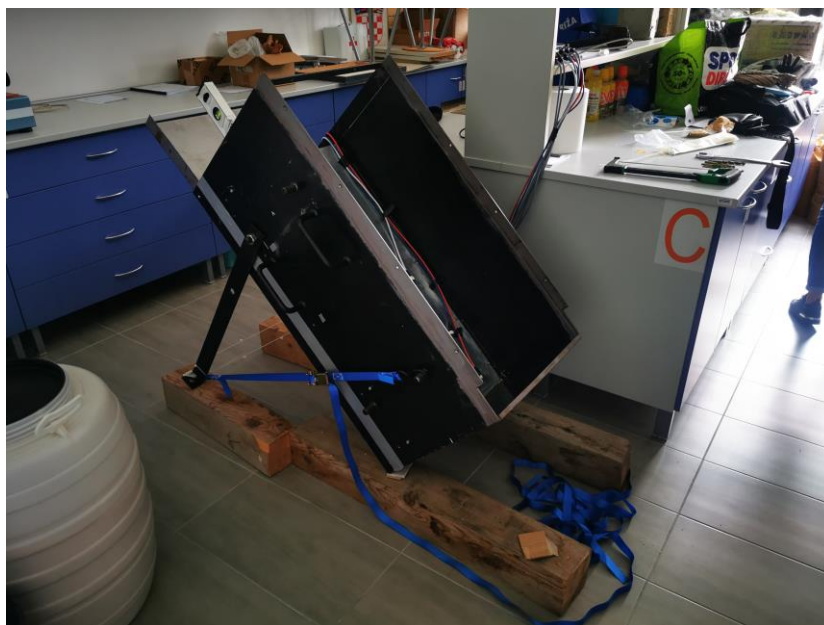
Slika 3.25: Model postavljen pod kut 45^\circ s obzirom na horizontalu
