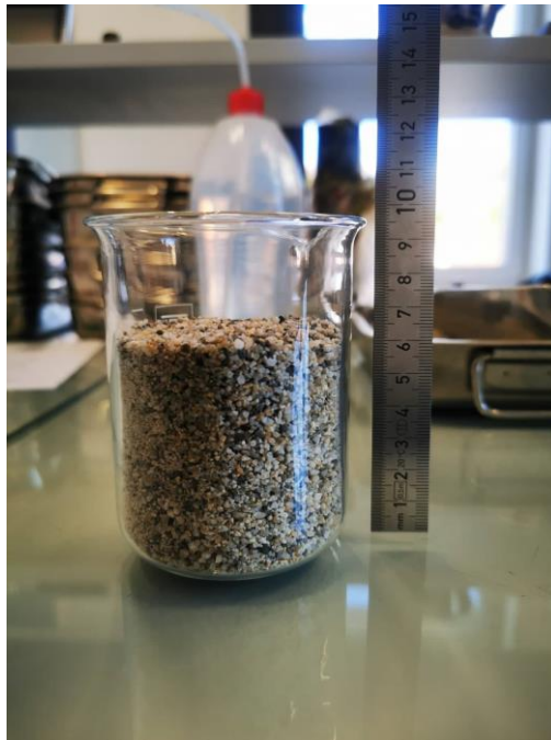
Slika 3.14: Mjerenje visine pijeska u čaši
