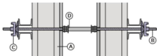
Slika 3.6. Shema sustava sidrenja 15,0 sa odstojnim držaćem
