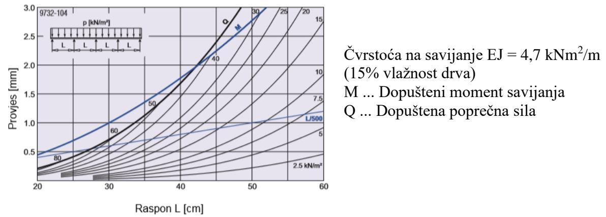
Slika 4.2. Dijagram progiba za Dokaplex oplatnu ploču, 21mm
