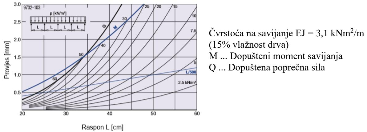
Slika 4.1. Dijagram progiba za Dokaplex oplatnu ploču, 18mm
