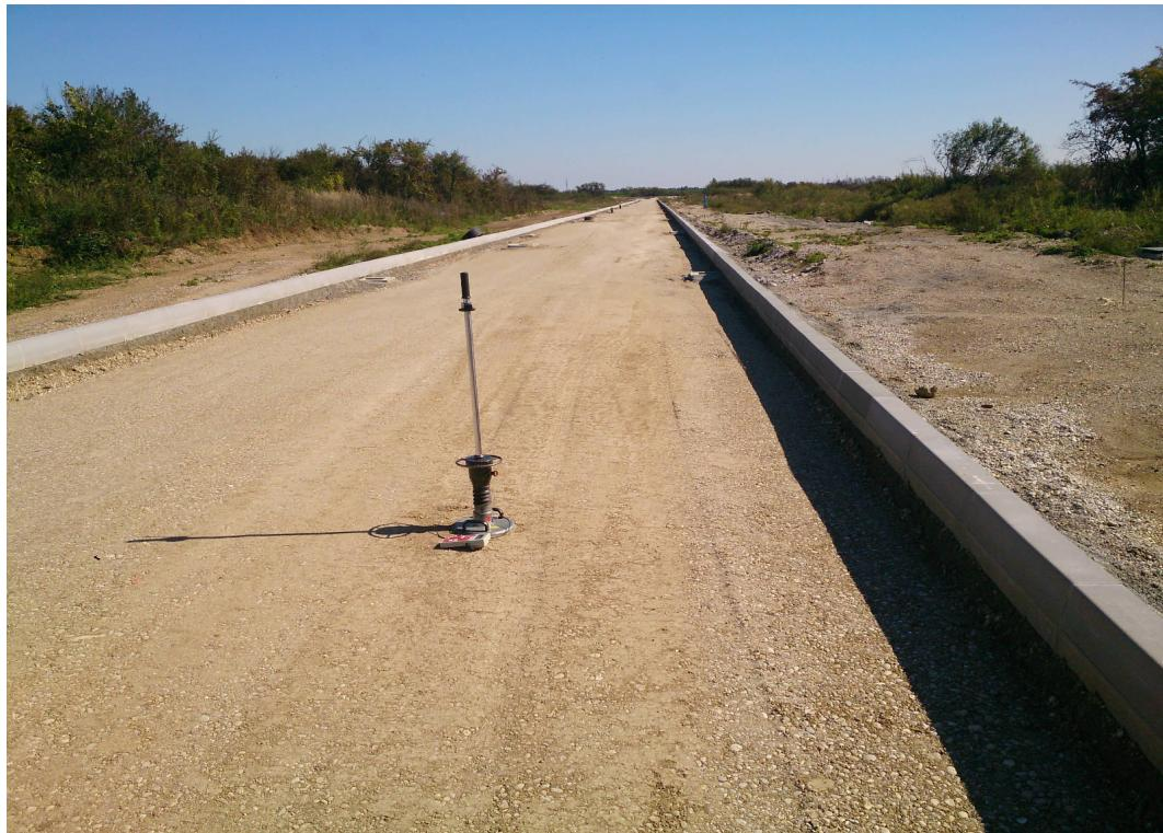
**Slika 5.1 Ispitivanje modula stišljivosti kružnom pločom
