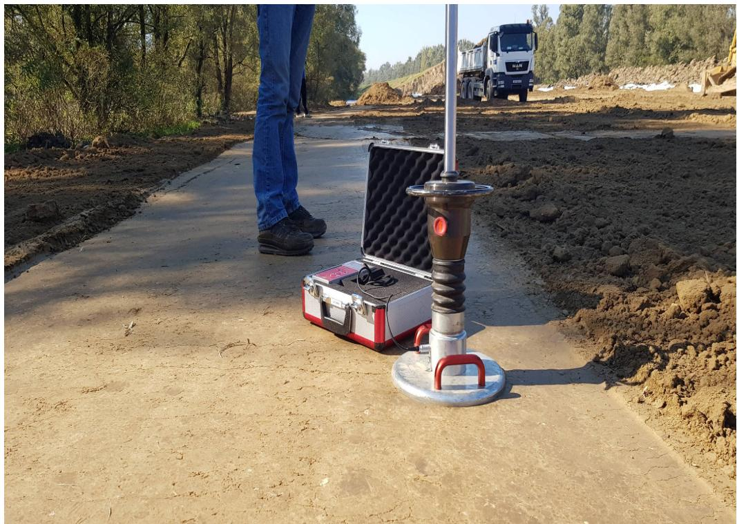
**Slika 4.6 Ispitivanje posteljice kružnom pločom
