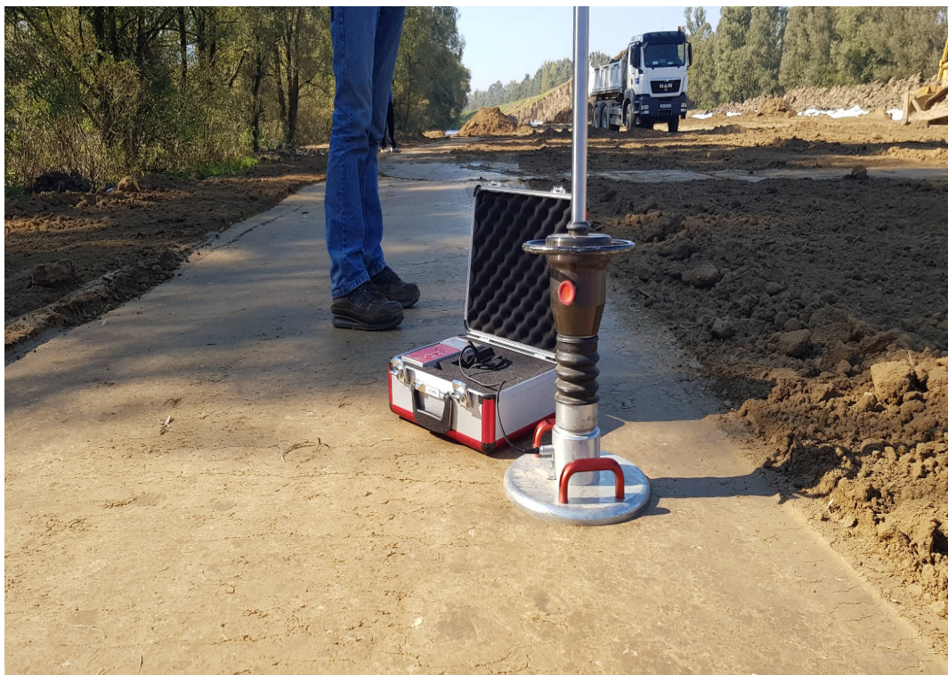
Slika 4.6 Ispitivanje posteljice kružnom pločom (vlastiti izvor)
