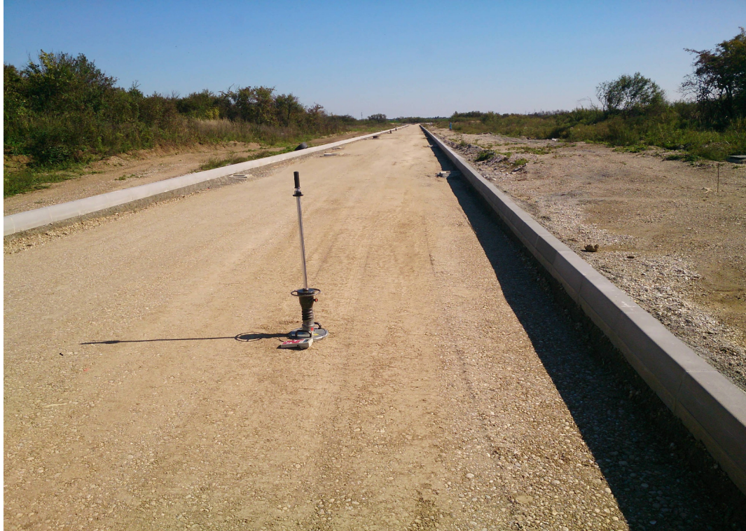
Slika 5.1 Ispitivanje modula stišljivosti kružnom pločom (vlastiti izvor)
