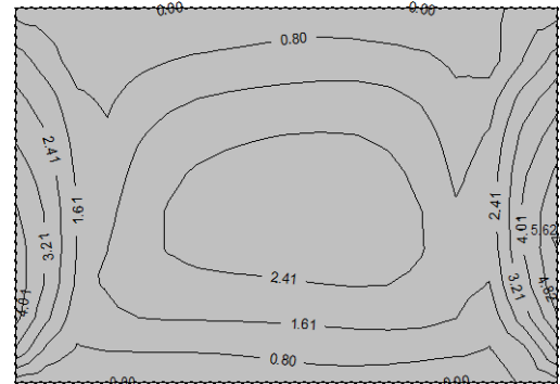
Okvir: V_3 Aa - d.zona - Pramac 1 - max Aa1,d= 5.62 cm²/m
