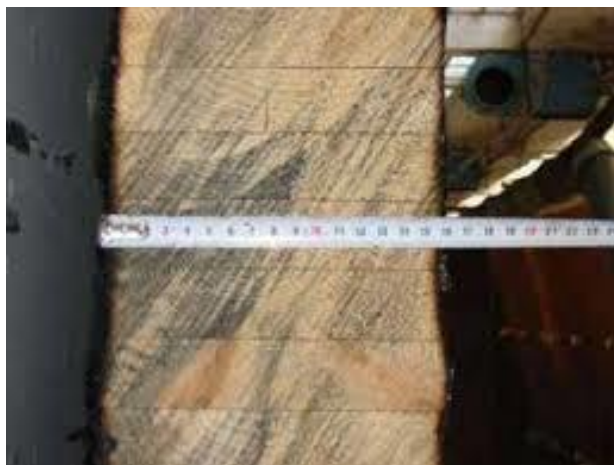
Slika 7.4 Lamelirani nosač nakon požara
