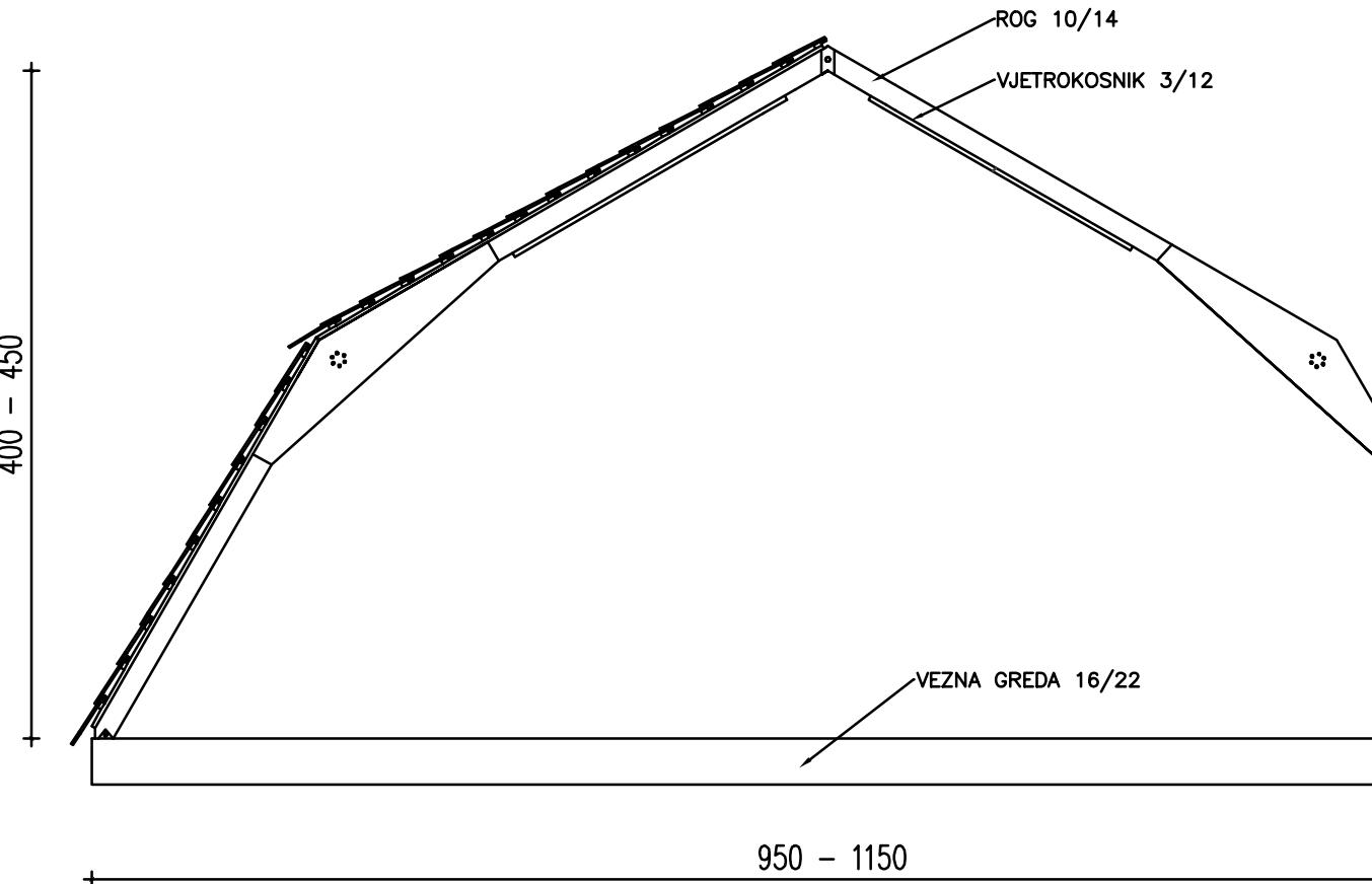
POPREČNI PRESJEK M 1:50
