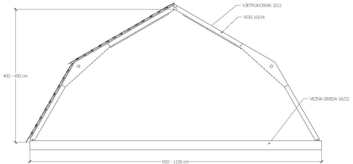
*Slika 7.5 Mansardno kroviste od lameliranog drva*
