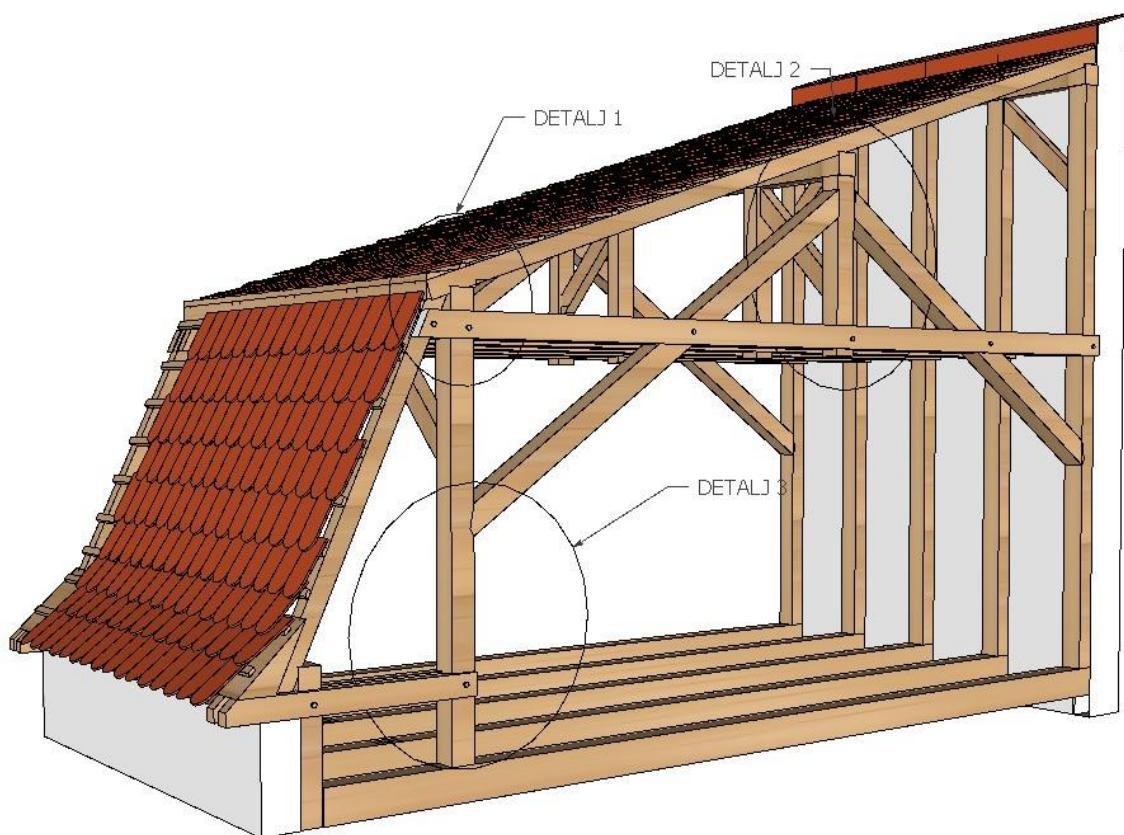
Slika 8.4 Prikaz jednostrešnog mansardnog krovišta s jednostrukom visuljom
