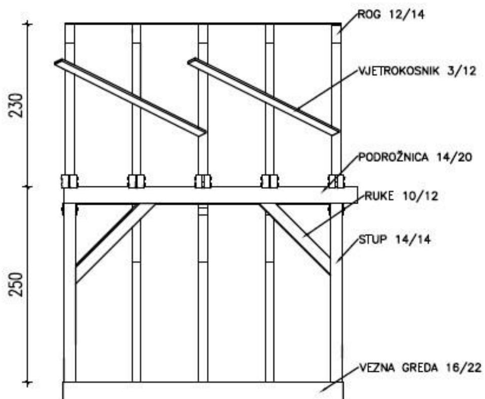
Slika 8.7 Poprečni presjek mansardnog krovišta s pajantama na stojećim stolicama
