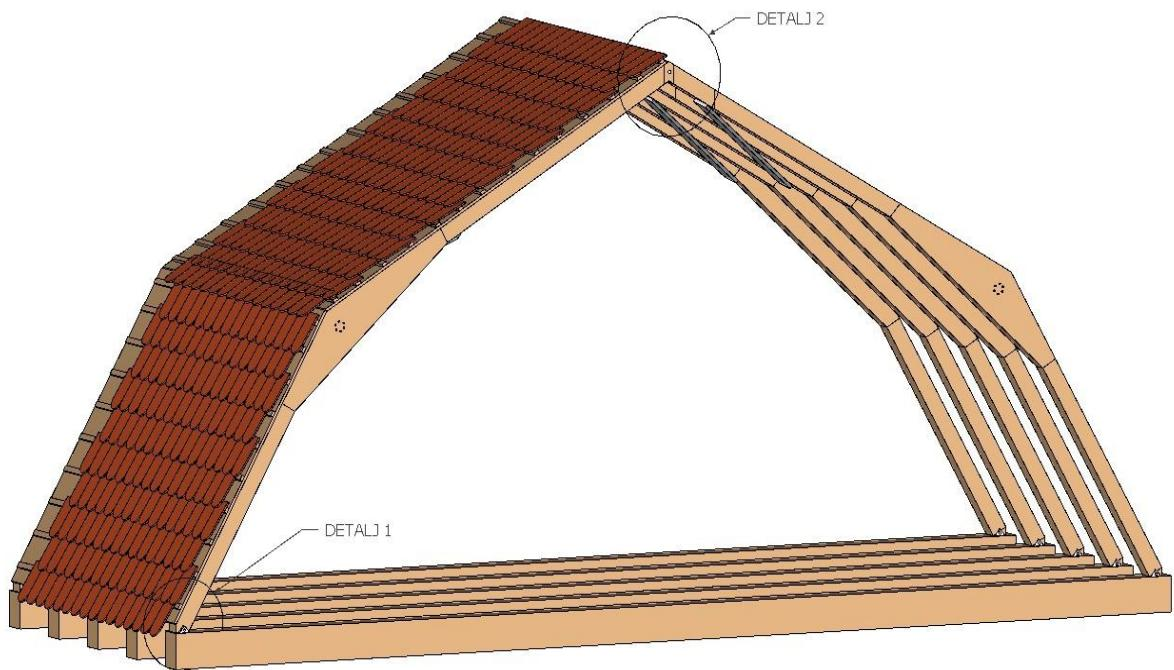
Slika 8.16 Prikaz mansardnog krovišta od lameliranog drva
