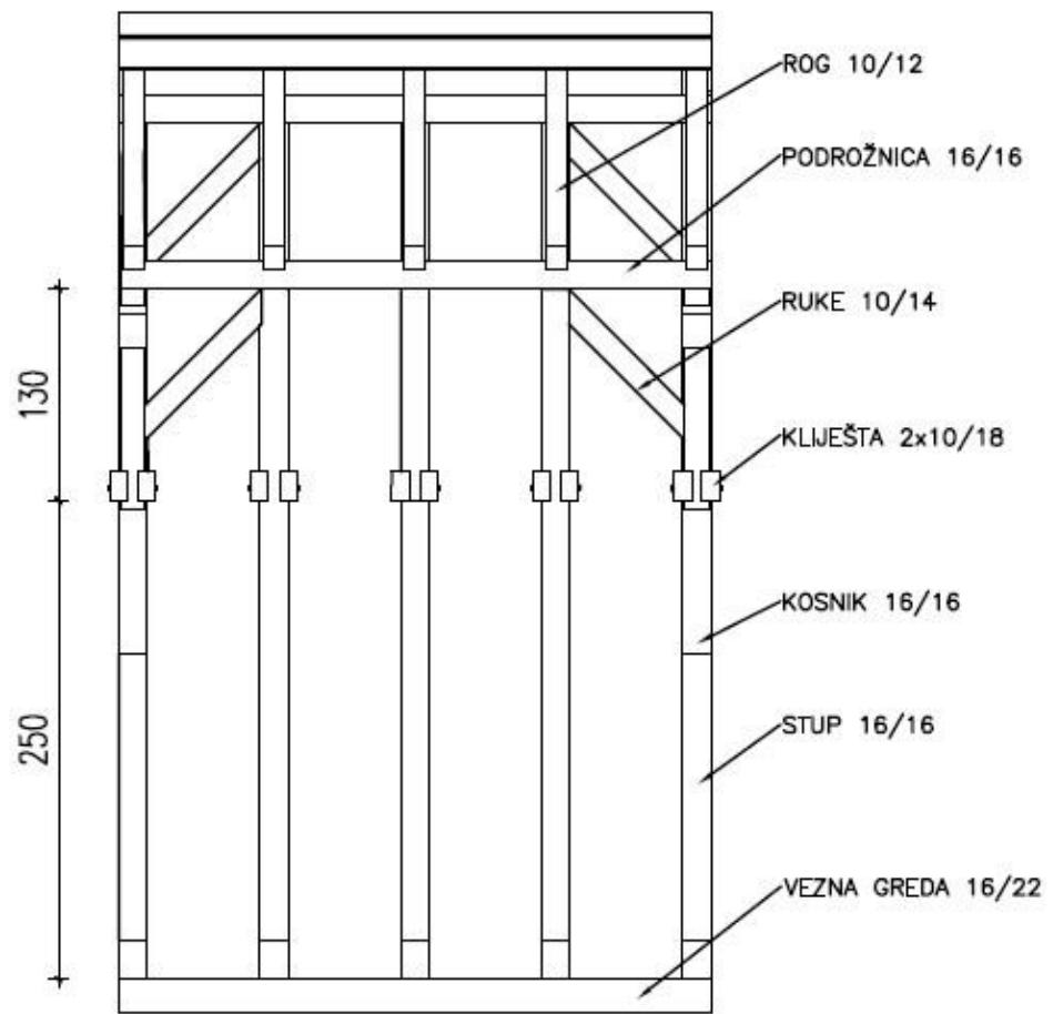
Slika 8.3 Poprečni presjek jednostrešnog mansardnog krovišta s jednostrukom visuljom
