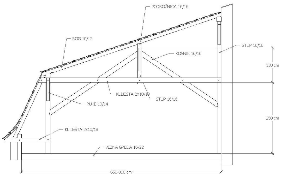
Slika 6.2 Jednostrešni mansardni krov s jednostrukom visuljom
