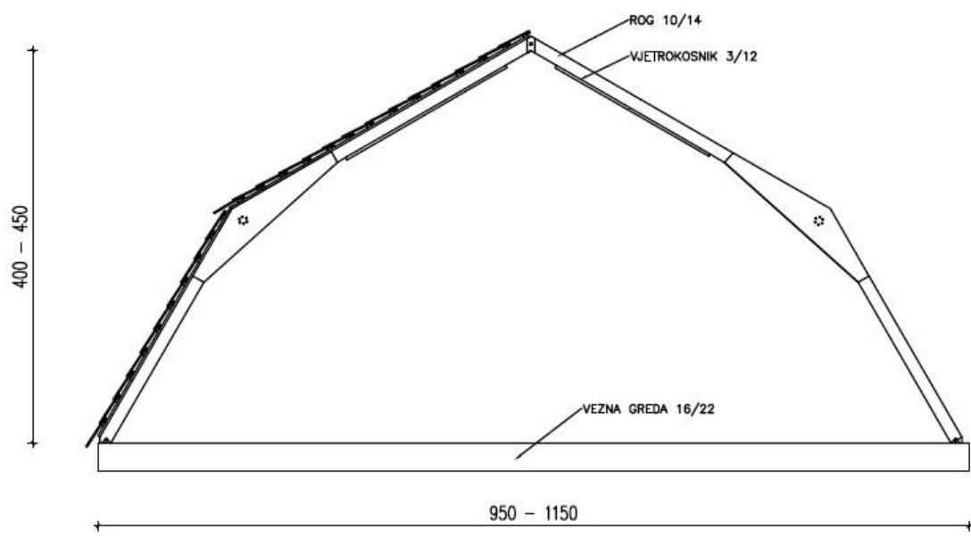
Slika 8.14 Uzdužni presjek mansardnog krovišta od lameliranog drva
