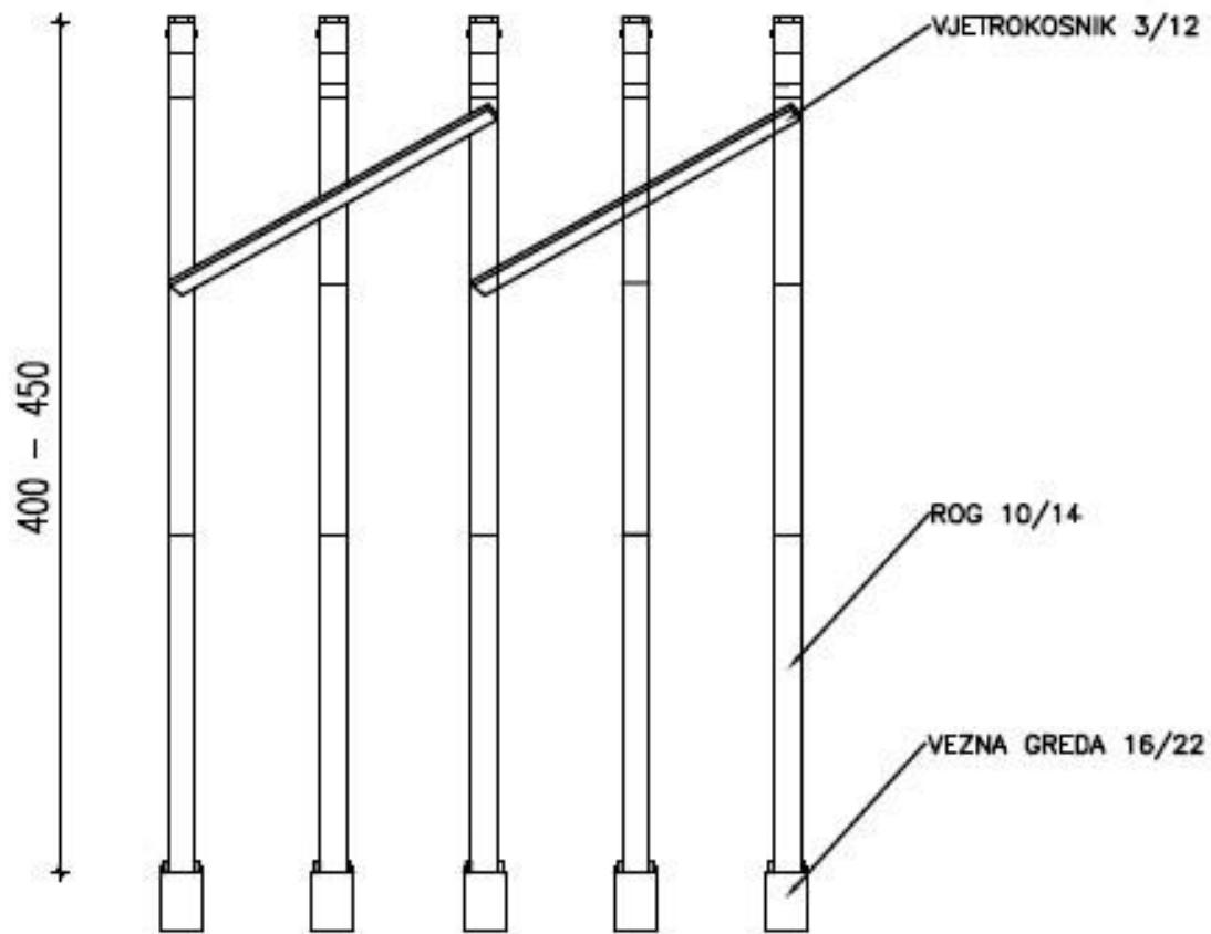
Slika 8.15 Poprečni presjek mansardnog krovišta od lameliranog drva
