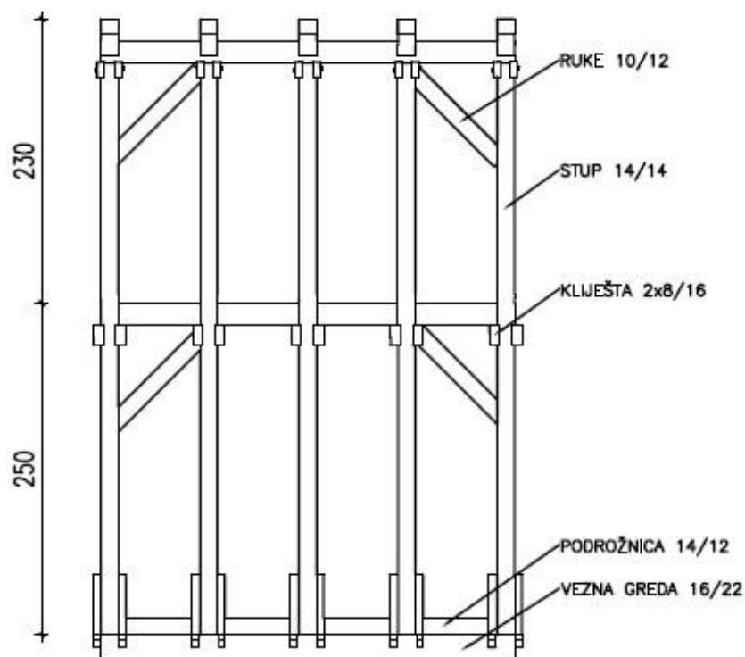
*Slika 8.11 Poprečni presjek mansardnog krovišta s podrožnicama na stojećim stolicama*
