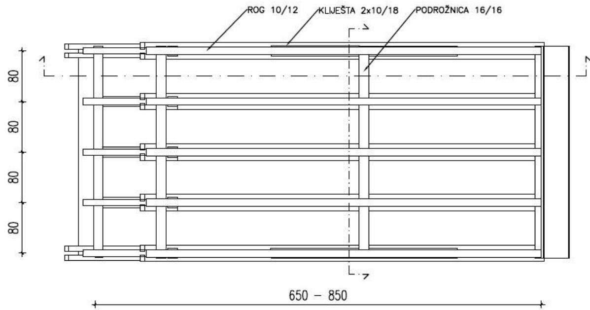
Slika 8.1 Tlocrt jednostrešnog mansardnog krovišta s jednostrukom visuljom
