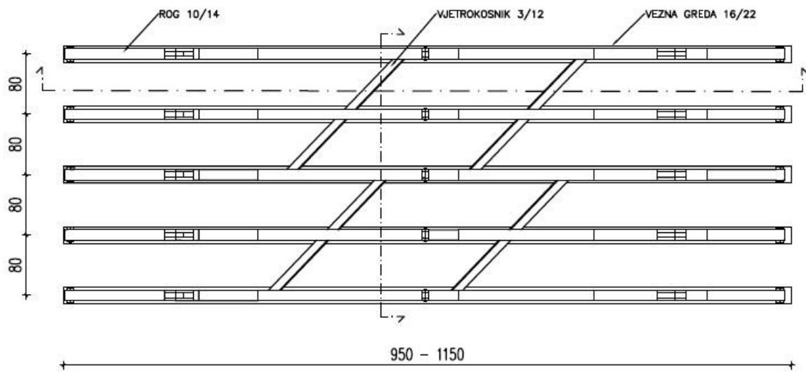
Slika 8.13 Tlocrt mansardnog krovišta od lameliranog drva
